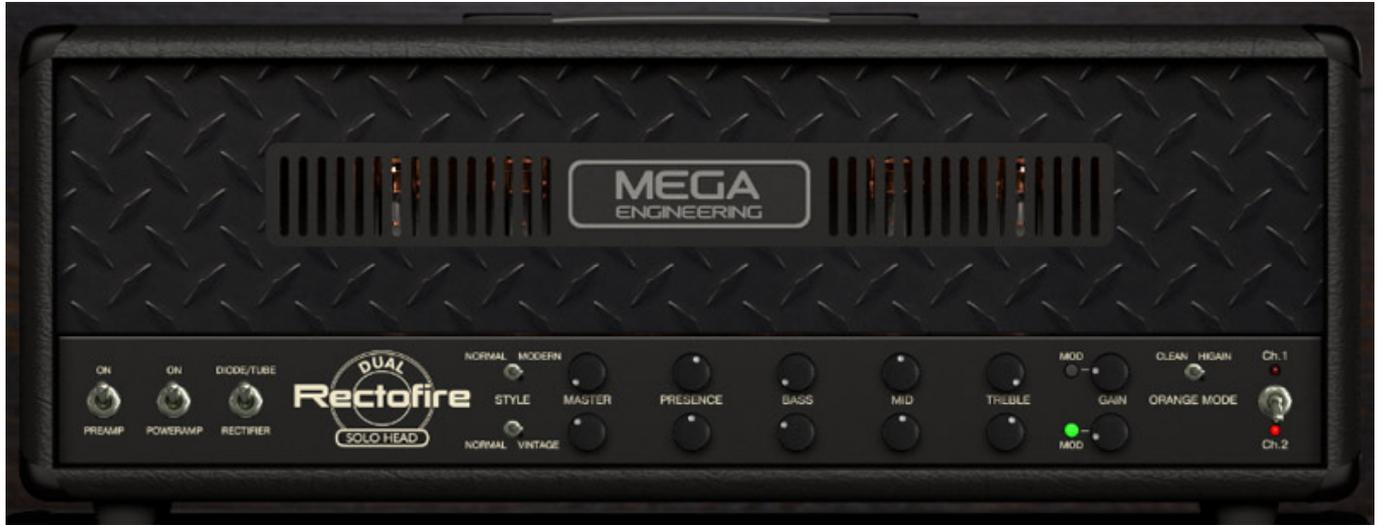
Neu seit Oktober 2022 ist der Rectofire für die Ampbox, und ja ihr habt es sicherlich schon erraten, er simuliert den Mesa Boogie Dual Rectifier Blackface (Rev. G), die Offenbarung für Heavy und Metall und zwar mit der Modifikation des Gain-Poti auf 1 Megaohm (Standard 250 Kiloohm), die für mehr Gain und forcierten Mitten sorgt. Eine sehr häufig beschriebene und sehr beliebte, da sehr effiziente Modifikation des Amps.
