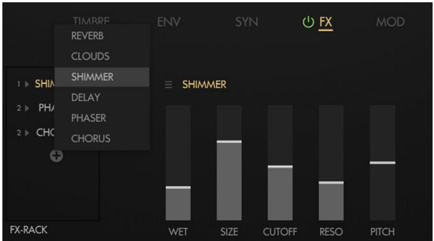
Natürlich darf in einem modernen Synthesizer-Konzept auch Effekte nicht fehlen (s. Abb. oben). Diese lässt sich über ein Icon neben dem "FX" auch komplett aktivieren oder deaktivieren (s. Abb. oben). Mit REVERB, CLOUDS und SHIMMER werden drei Hall-Algorithmen sowie ein Delay, Phaser und ein Chorus-Effekt geboten.
