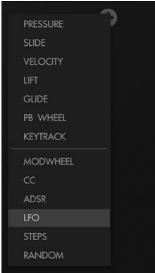
Es gibt hier eine ganze Menge von Modulationsquellen von Keyboard-Parametern wie Pressure, Velocity oder Keytracking bis hin zu Modulationsquellen wie Modulationsrad, MIDI-Controller, Hüllkurven, Step-Sequencer oder Zufallsgenerator.
