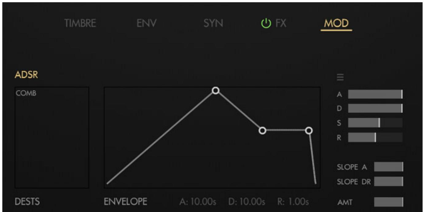
Im Bereich MOD lassen sich die Parameter einer Modulationsquelle einstellen (s. Abb. oben am Beispiel des ADSR-Hüllkurvengenerators).
