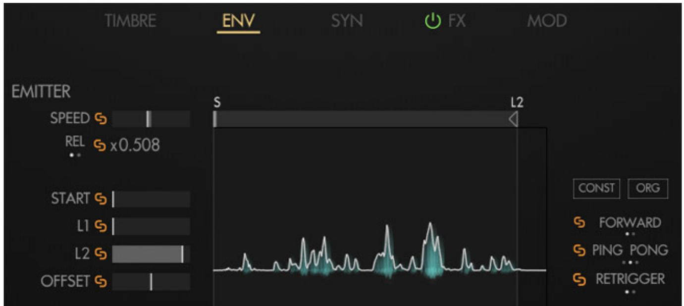
ENV ist für den Hüllkurvenverlauf des selektierten Layers zuständig (s. Abb. oben). Neben der Hüllkurve, die sich auch grafisch mit der Maus verändern, bzw. anpassen lässt, kann der Anwender Start- und die beiden Loop-Punkte einstellen und auch die Abspielrichtung lässt sich verändern.
