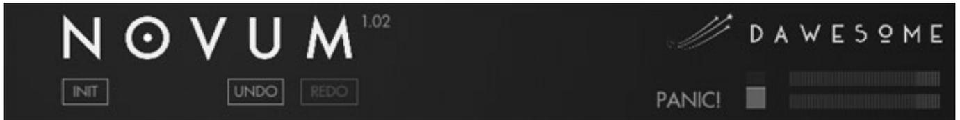
Oben im Kopf des Instrumentes lässt sich ein komplett neues Preset anlegen. Veränderungen an einem bestehenden Preset werden erst nach einem SAVE gespeichert und man hat zudem auch die Möglichkeit eines Undo/Redo. Über den Taster PANIC wird die Audioausgabe zurückgesetzt. Über zwei Bargrafen sieht man auch den aktuellen Ausgangspegel.
