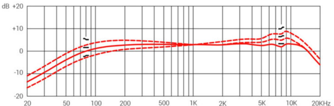
Die Beeinflussung der Tiefen scheint schon recht weit oben bei ungefähr 800 Hz zu beginnen. Bei der Höhenanhebung greift Stufe 1 später und flacher ein, Stufe 2 beginnt schon bei knapp über 1 kHz und liefert eine deutlicher Anhebung (s. Abb. oben).
