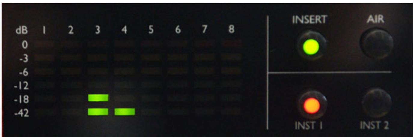
Oben rechts neben den Bargrafanzeigen gibt es zwei Taster, die die Funktion der acht Tasten zwischen Kanal-Insert-Status und Kanal-Air-Modus umschalten.
