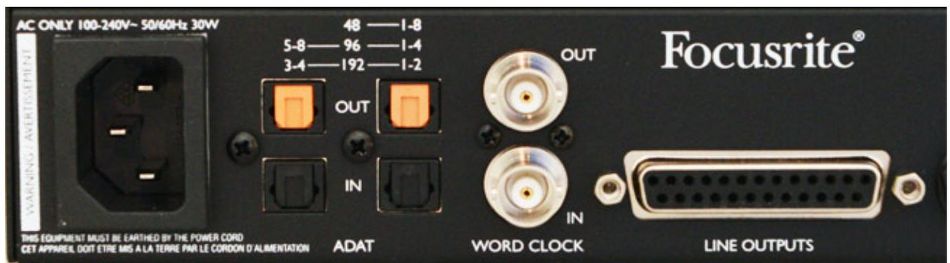
Die acht Line-Ausgänge stehen auf einer 25-poligen Sub-D-Buchse bereit, die entsprechend dem sogenannten Tascam-Format belegt sind. Der Dynamikbereich beträgt hier 124 dB und der maximale Ausgangspegel 18 dBu.
