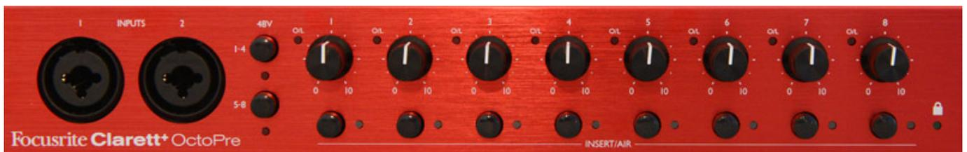
Über acht Potis lässt sich die Eingangsverstärkung für Mic, Line und Instrument im Bereich von 57 dB anpassen (s. Abb. oben). Über zwei Schalter lässt sich auf den Eingangsbuchsen 1 bis 4, bzw. 5 bis 8 eine 48-Volt-Phantomspeisespannung aufschalten. Unter jedem Poti befindet sich ein Taster und eine Status-LED für die individuelle Aktivierung des Inserts und des AIR-Modus.
