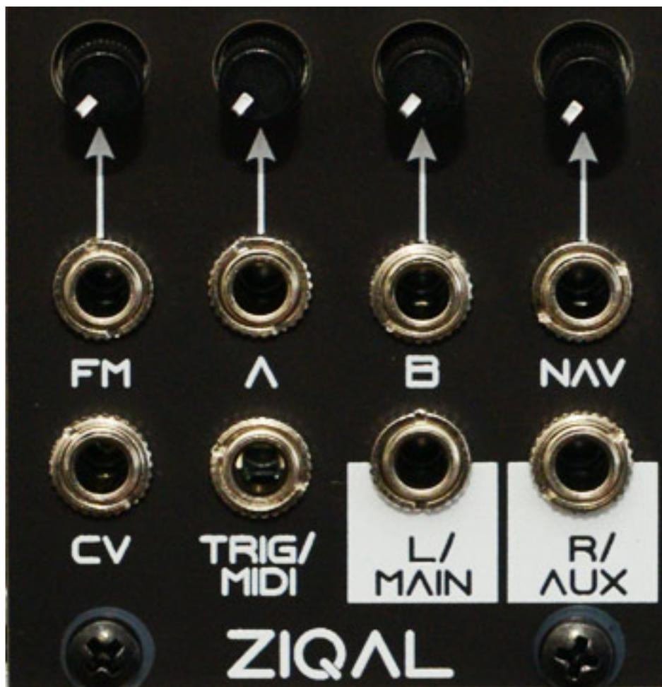
Neben den beiden Audio-Ausgängen L/R (Main/Aux) bietet das Modul Dimension einen CV-Eingang für die Tonhöhensteuerspannung sowie einen MIDI-Eingang (Type A), der CV-Modus die Phasen der Oszillatoren im Unisono-Betrieb auf null setzt. Weiter gibt es einen Frequenzmodulations-Eingang sowie jeweils Eingänge für die Parameter A, B und NAV und sehr lobenswert: alle vier mit Potentiometern zur Eingangsabschwächung.
