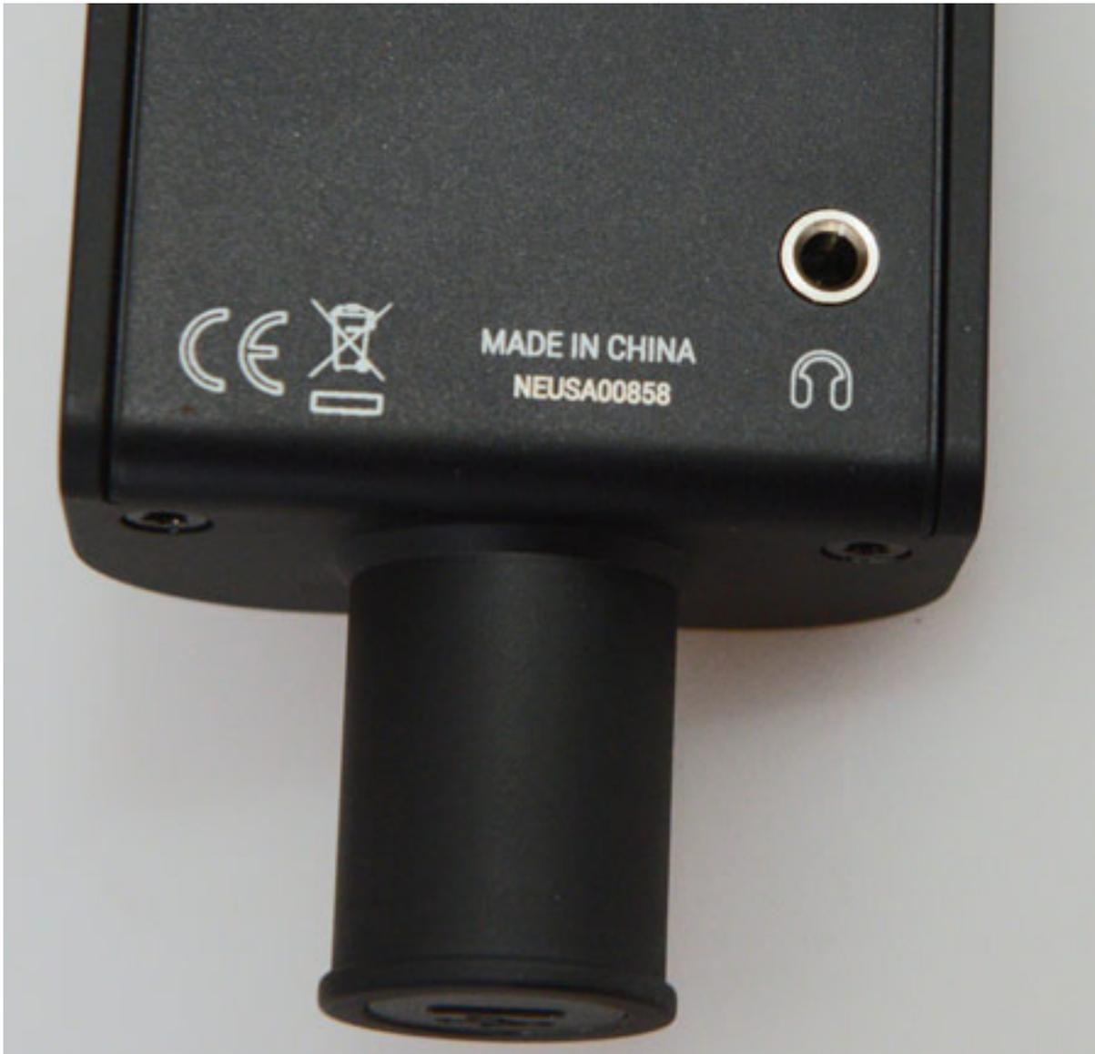
Das NEOM USB wird direkt als Audio-Device von Windows- oder macOS-Betriebssysteme erkannt und zur Nutzung angeboten. Es sind also keine zusätzlichen Treiber erforderlich. Das gleiche gilt auch für iOS- und Android-basierende mobile Geräte. Bei Android-Geräten ist ein OTG-Adapter und bei iOS-Geräten der Kameraadapter für den Betrieb erforderlich. Wichtig ist aber, dass die
