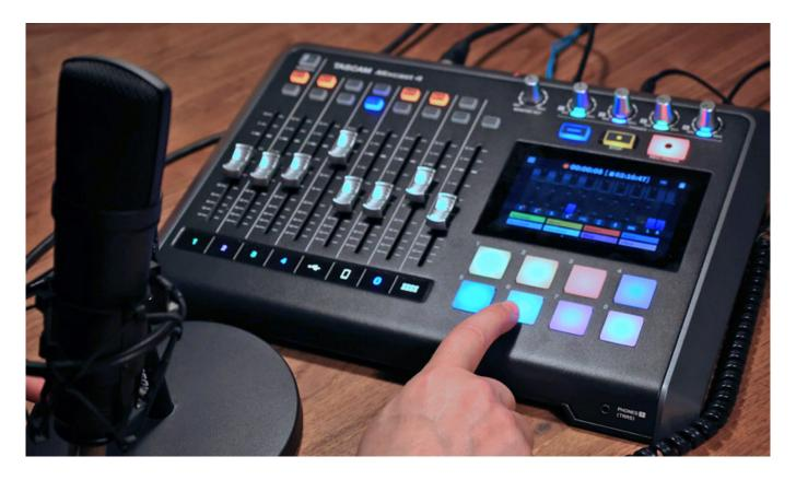
Dieses kompakte Gerät enthält alles Wesentliche, was man für eine Live-Übertragung oder einen Mitschnitt benötigt: Rauscharme Eingänge mit TRRS-Support und Bluetooth für externe Anrufer, nützliche Effekte, Sample-Funktionen für eigene Jingles, die via Soundpads eingespielt werden können sowie ein USB-Audiointerface mit einem sauberen Klang.
