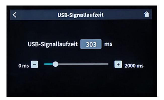
Zur optimierten Synchronisation von Ton und Bild bei Videokonferenzen kann die Tonübertragung via USB zeitlich angepasst werden. Im Test reichten 300 ms für eine optische Übereinstimmung, möglich sind bis zu zwei Sekunden Verzögerung.
