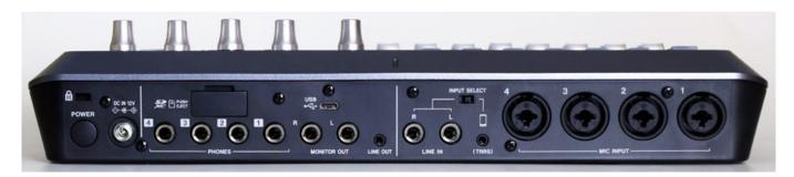
Hier sind alle Anschlüsse übersichtlich gegliedert und von links nach rechts sauber verarbeitet angebracht. Links außen befindet sich der Ein- und Ausschalter, der in Form eines Druckknopfes praktischerweise ein Ausschalten durch zufälliges Berühren während einer Aufnahme verhindert. Rechts daneben der Stromanschluss für das Kabel des externen 12-Volt-Netzteils, dass mittels Drehverschluss fest mit dem Gehäuse verbunden wird.
