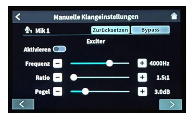
So werden alle verfügbaren Funktionen pro Audiokanal auch für Laien verständlich angezeigt. Bei allen Mikrofoneingängen kann man zwischen Dynamik- und Kondensatormikrofon wählen, Gain-Regler in dB einstellen, sowie Klang- und Effekteinstellungen als Preset nutzen oder individuell anpassen.
