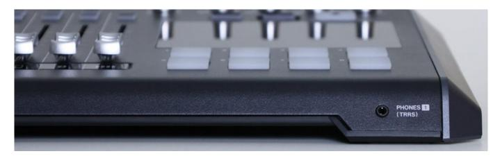
Auf der rechten Seite befindet sich frontseitig ein vierpoliger (TRRS) Ein- und Ausgang als 3,5 mm-Miniklinkenbuchse für Kopfhörer/Headsets aus Kunststoff. Praktisch, denn so lassen sich Headsets mit Mikrofon nutzen, falls man nicht andere Mikrofone für rückseitigen Buchsen zur Verfügung hat. Alle weiteren Anschlüsse befinden sich rückseitig.
