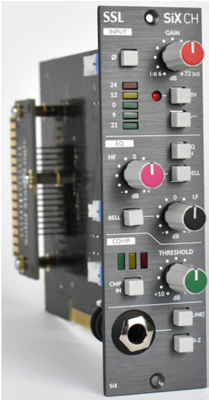
Solid State Logic, besser bekannt als SSL, hat einen äußerst umfangreich ausgestatteten Kanalzug für das API-500-Format vorgestellt. Die Rede ist vom SiX CH, einem Channelstrip, dessen Design und technischer Aufbau von den Kleinmischpulten [SSL SiX](#) und SSL Big SiX übernommen wurde. Auf engstem Raum
