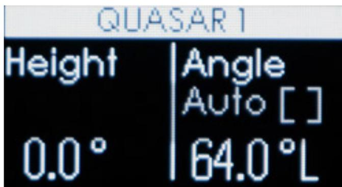
In den Menüs QUASAR 1 und QUASAR 2 gibt es eine ganze Reihe von Parametern, die sich einstellen lassen, wie der Elevationswinkel (Height) und der Winkel in der horizontalen Ebene (Angle). Hier lässt sich auch der Auto-Modus durch Drücken auf den kleinen Drehgeber aktivieren, um ein automatisches kontinuierliches Umlaufen der virtuellen Schallquelle zu erreichen.
