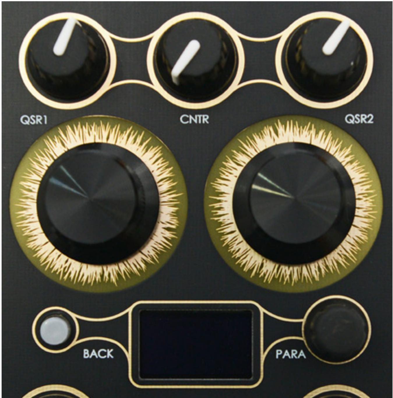
Ganz oben befinden sich drei weitere Pegelregler und zwar für die Quasar Engine Ausgänge 1 und 2 sowie für den Monoanteil, hier mit "Center" (CNTR) bezeichnet.
