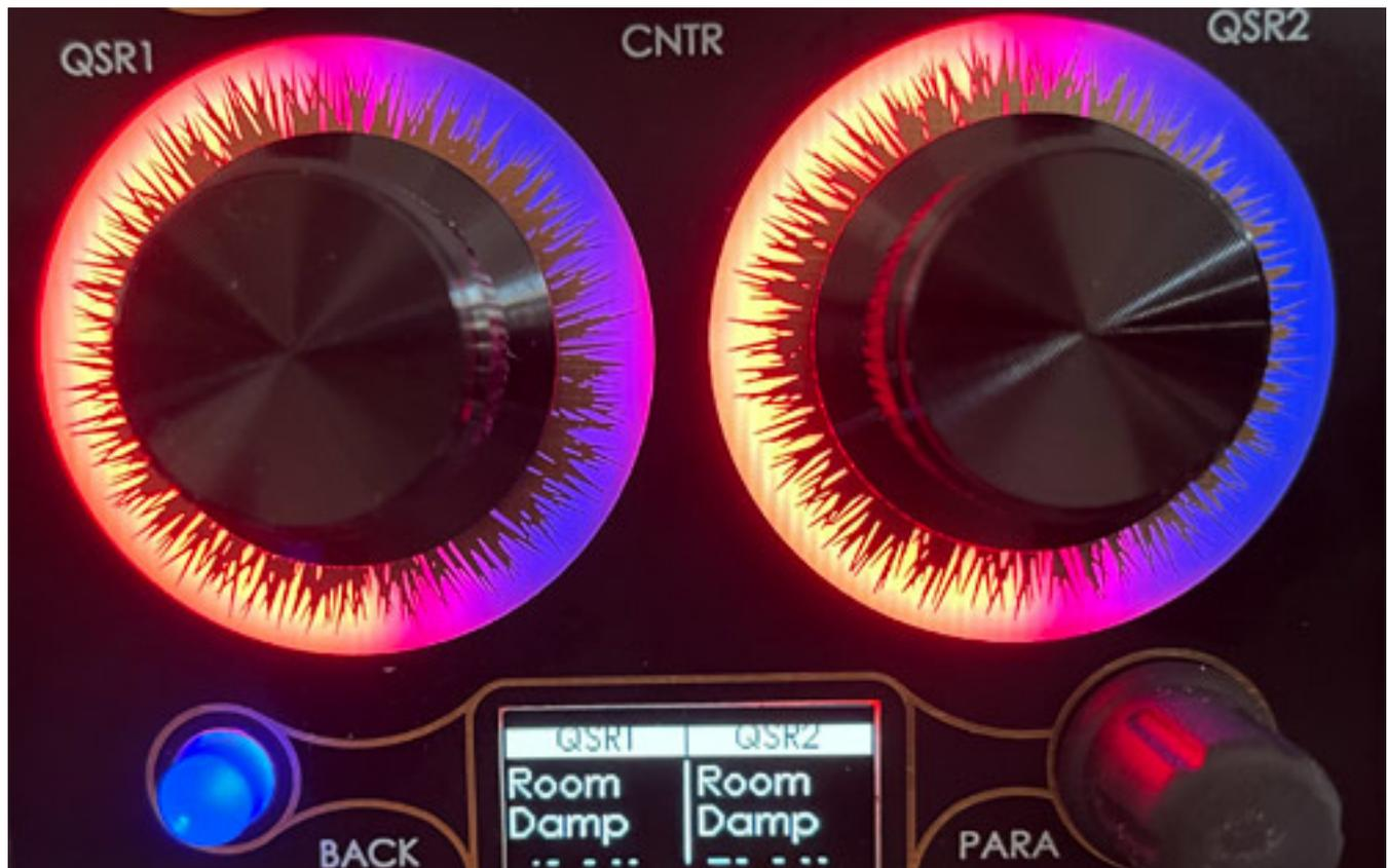
Ab der Firmware-Version 1.1 gibt es auch noch einen im Setting-Menü anwählbaren "Dual-Mode", wobei die Werte eines selektierter Paramater beider Engines gleichzeitig, nebeneinander angezeigt werden (s. Abb. oben).
