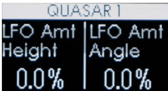
Über weitere Parameter kann man den Modulationsgrad für einzelne Parameter verändern wie der Grad der Modulation für die Höhenwahrnehmung oder dem Winkel.
