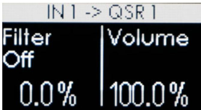
Hier lassen sich Filter und der Eingangspegel für die Signale zur Engine 1 und 2 sowie zum Mono-Ausgang einstellen. Der Filterregler regelt die Frequenz. In Mittenstellung erfolgt keine Filterung, bei Reglerstellung links wirkt der Tiefpass- und rechts der Hochpass-Filter. Bei der Firmware Version 1.0 (siehe Abb.) wurde die Filtereinstellung noch in Prozent angegeben. Ab der Firmware-Version 1.1 wird aber die entsprechende Grenzfrequenz angezeigt.
