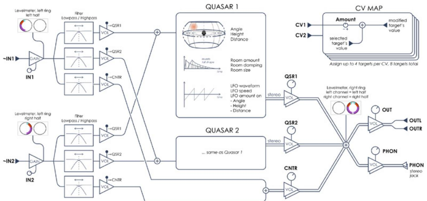
Die beiden Quasar Engines sorgen für die virtuelle Platzierung des Signals im Raum (Richtung und Distanz), der Raumsimulation mit Reflexionen und Nachhall, sowie den Modulationsmöglichkeiten über LFOs.
