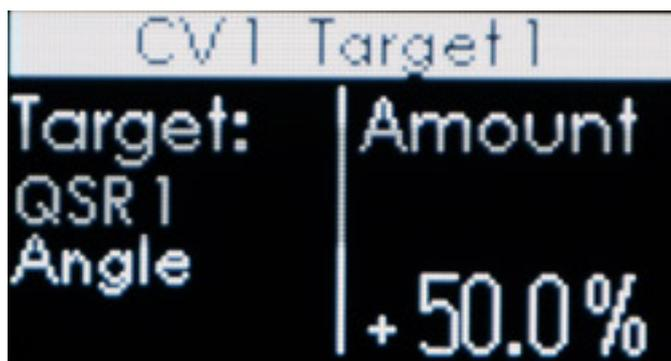
Über die Menüpunkte CV 1 und CV 2 lassen sich die externen Steuerspannungen auf ein Ziel aufschalten und der Modulationsgrad kann angepasst werden (s. Abb. oben). Bis zu vier Ziele mit individuellen Modulationsgraden lassen sich hier definieren.
