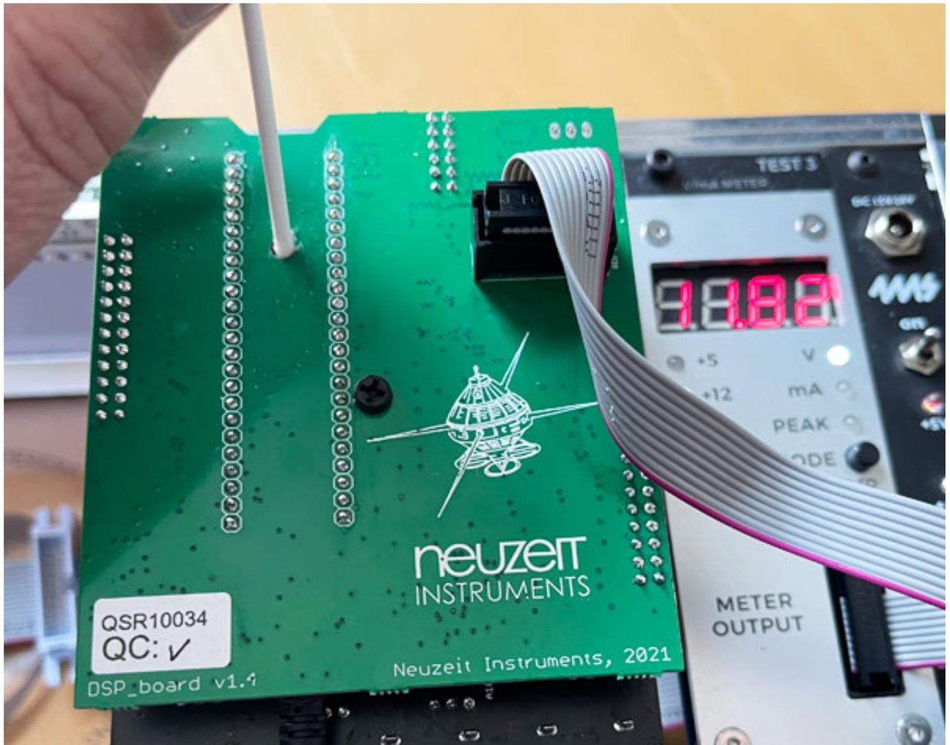
Das Modul ist nun zum Update bereit und den Update-Vorgang startet man durch Drücken eines Miniaturschalters, der sich auf der unteren Platine befindet. Zum Drücken benutzt man am besten ein Wattestäbchen, wo man auf einer Seite die Watte entfernt (s. Abb. oben).
