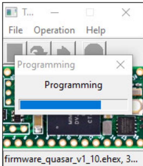
Es startet sofort der Programmiervorgang. Man darf sich nicht irritieren lassen denn der dauert nur wenige Sekunden. Nun kann man das USB-Kabel abziehen und nach eine Restart des Moduls sollte sich dann die aktualisierte Firmware-Version beim Restart angezeigt werden. Alles in Allem ein völlig unproblematischer Vorgang.
