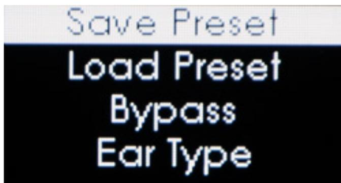
Über den Menüpunkt MORE lassen sich Presets speichern, bzw. abrufen und dass Modul lässt sich auch in Bypass schalten. Insgesamt sind bis zu 127 Presets möglich.
