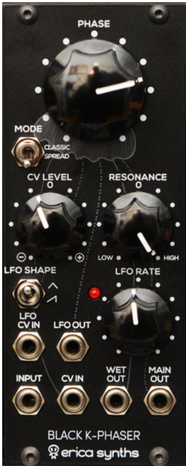
Schauen wir uns einmal die Bedienung des K-Phasers an. Mit PHASE lässt sich die Phasenverschiebung manuell einstellen. Überlagert wird diese Einstellung durch die Spannung des CV IN bzw. des internen LFOs. Der interne LFO ist aktiv wenn in CV IN kein Klinkenstecker in der Buchse eingesteckt ist. Über LFO RATE lässt sich die
