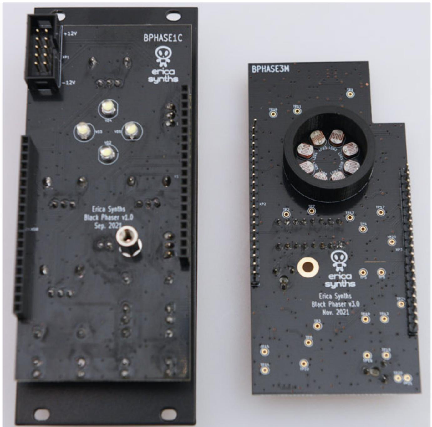
Beim Erica Synths K-Phaser ist man diesem Prinzip mit den Photowiderständen treu geblieben. Die meisten modernen Phaser realisieren die variablen Phasenschieber dagegen nicht auf fotoelektrischem Wege. Beim K-Phaser geht es allerdings moderner zu als beim Vorbild, denn statt Glühlampen kommen hier vier LEDs als Leuchtquelle in Verbindung mit acht Fotowiderständen zum Einsatz (s. Abb. oben), die über einen Ring gekapselt sind.
