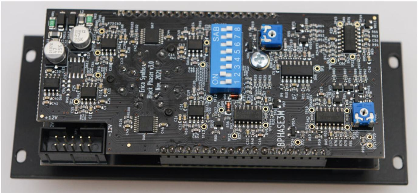
Auf der Geräterückseite befindet sich noch ein DIP-Schalter. Dazu nochmal zurück zum Original. Bei COMPACT PHASING "A" werden zwei Allpassfilter als Phasenschieber eingesetzt. Die Werkseinstellung bei den DIP-Schaltern (s. Abb. oben) ist entsprechend gesetzt. Die Anzahl lässt sich aber bis auf acht erhöhen, indem man den DIP-Schalter entsprechend setzt. Nur ein Schalter darf dabei jeweils auf Stellung ON stehen.
