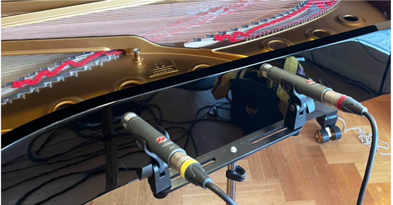
Die sehr robust ausgeführte Schiene hat eine Größe von 24,5 und man erreicht einen maximalen Mikrofonabstand von ca. 22,5 cm. Für meinen Geschmack etwas wenig aber es gibt ja genügend alternative Schienen.
