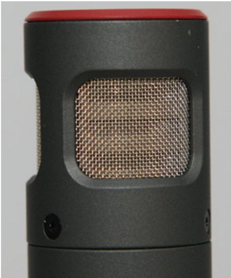
Das Mikrofon ist übertragerlos aufgebaut - also mit einer elektronischen Symmetrierung. Betrieben wird das Mikrofon mit Phantomspeisung, wobei der Speisestrom unter 3 mA liegt. Die nominale Ausgangsimpedanz beträgt 275 Ohm. Das Eigenrauschen gibt der Hersteller mit 16 dB SPL an und der maximale Schalldruck beträgt beachtliche 156 dB. Das Mikrofon verfügt über eine zuschaltbare 10 und 20 dB Vordämpfung.
