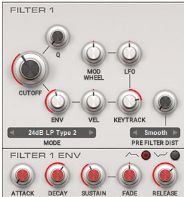
Es werden zwei Filter mit einstellbarem Filtermodus geboten. Es kann auch ein Distortion vor dem Filter eingestellt werden (nur bei Filter 1). Der Grad der Verzerrung lässt sich in Stufen über ein Menüpunkt auswählen.
