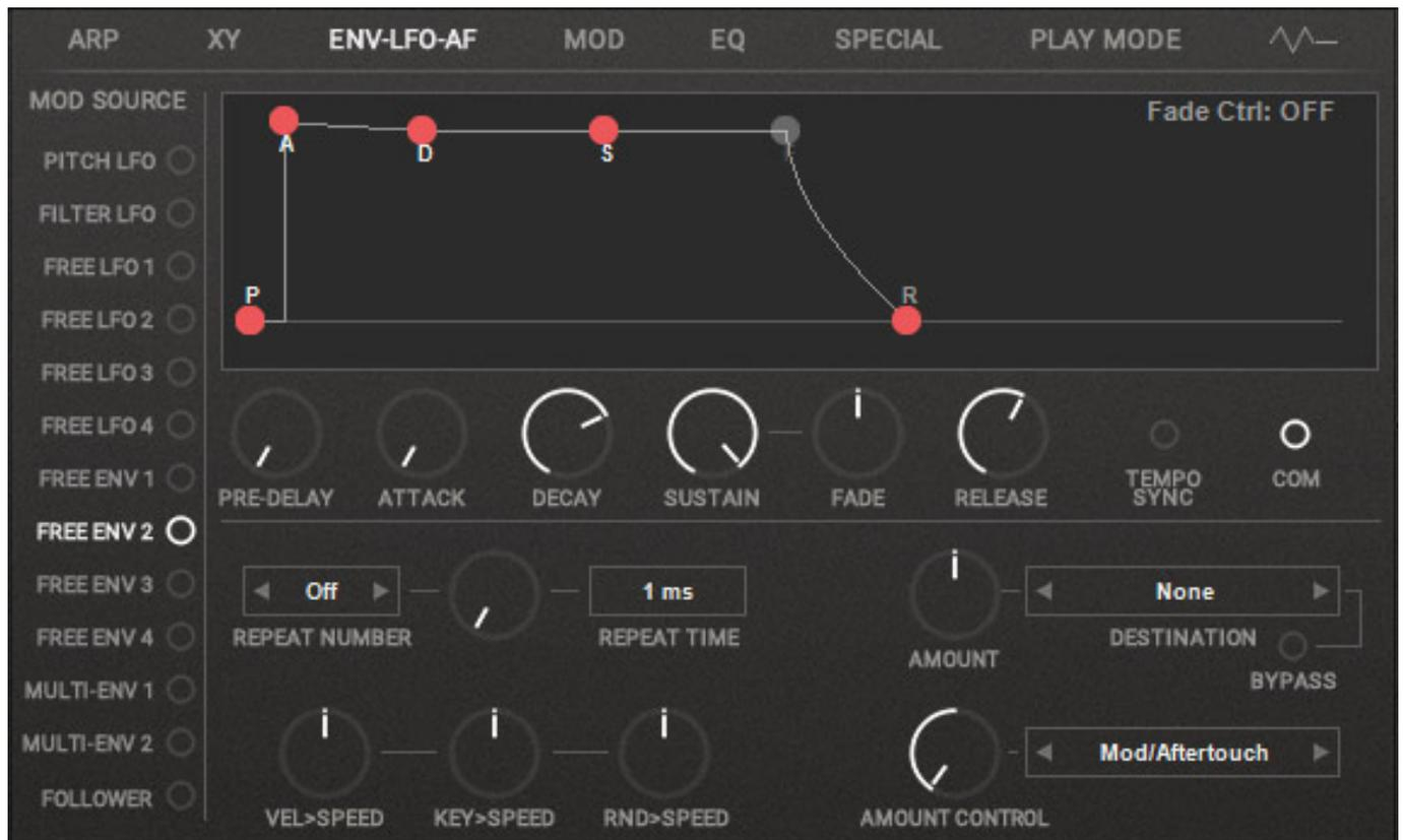
Über einen weiteren Reiter lassen sich vier freie LFOs sowie vier Hüllkurven und zwei Multi-Hüllkurven (s. Abb. oben) mit bis zu 15 Stages aktivieren und einstellen und zudem auch in der Version 3 nun ein Envelope Follower (s. Abb. unten) mit bis zu elf verschiedenen Modulationsquellen.
