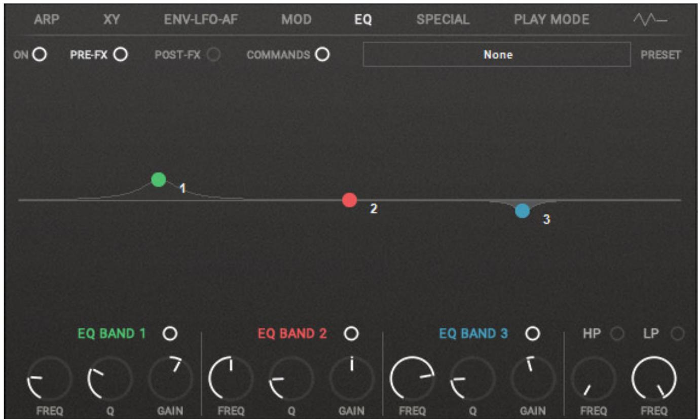
Den Equalizer haben wir ja bereits kurz erwähnt. Es handelt sich um einen vollparametrischen Dreiband-Equalizer plus Hoch- und Tiefpassfilter.
