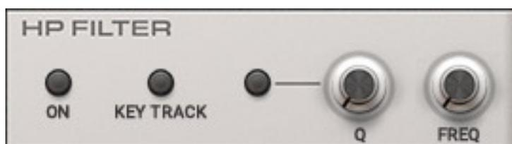
Darüber hinaus (s. Abb. oben) gibt es noch einen zuschaltbaren Hochpaß, bei dem sich Filterfrequenz und die Güte einstellen lässt. Der Anwender kann auch wählen, ob die Filterfrequenz fixiert sein soll oder ob sie über die KEY TRACK Funktion der Tonhöhe folgt.
