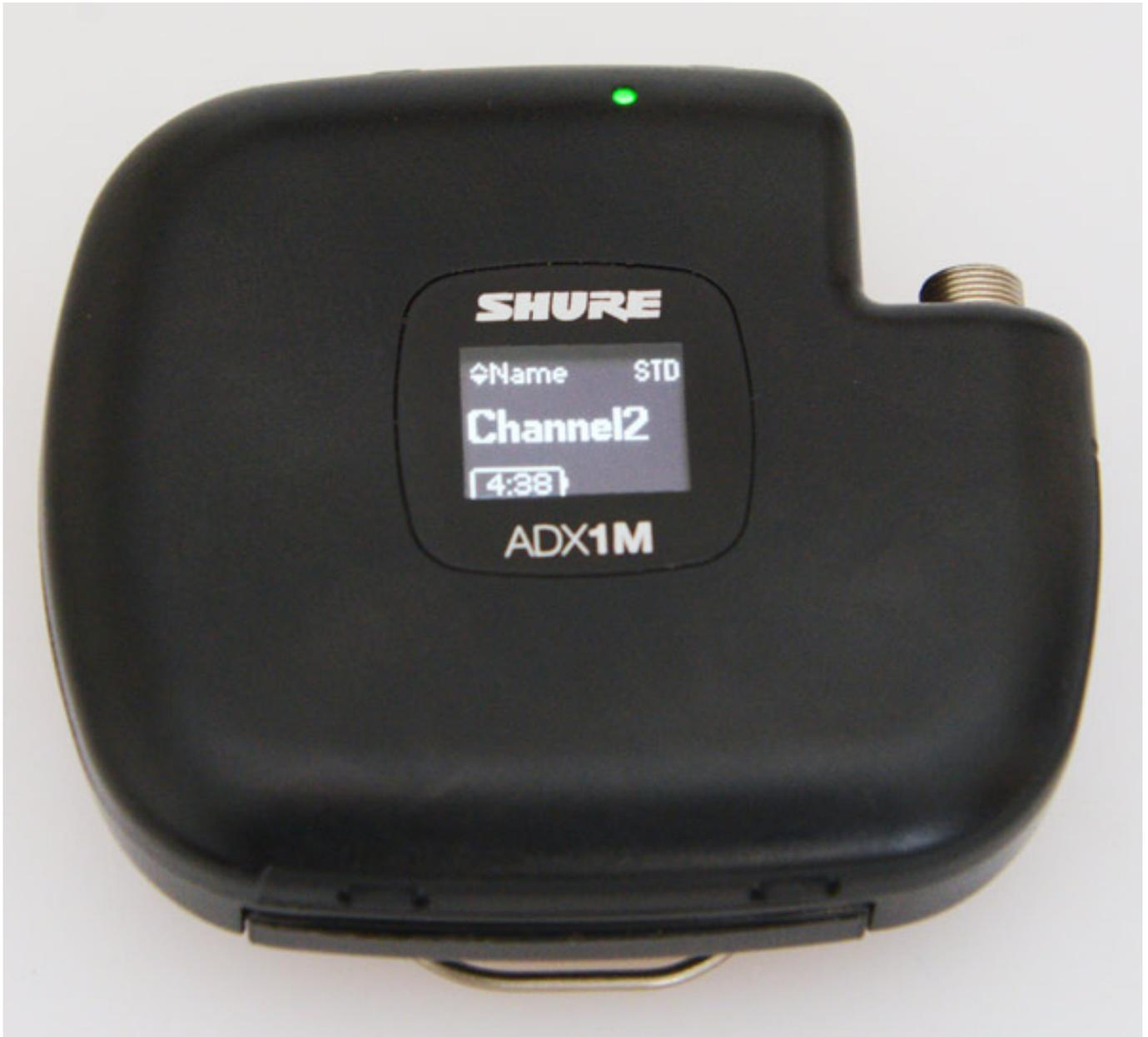
Es gibt auch noch mit dem ADX1M einen sehr kleinen Taschensender (s. Abb. oben), der entwickelt wurde, um direkt am Körper getragen zu werden. Er verfügt über eine innenliegende Antenne. Über kontinuierliche Messungen erfolgt immer eine optimale Anpassung der Sendeantenne. Die maximale Ausgangsleistung ist auf 20 mW beschränkt.
