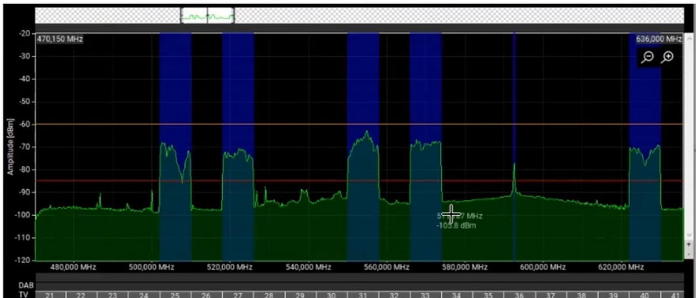
Es ist aber nicht nur eine Systemkonfiguration, bzw. Kontrolle der Komponenten möglich, sondern die Software bietet auch umfangreiche Analysefunktionen von einem Breitband-Scan (s. Abb. oben), bis hin zur Parameteranalyse (Signal Qualität, Feldstärke, Audiopegel, Batteriestatus, ShowLink-Pegel) hinweg über eine Timeline für die einzelnen Kanäle (s. Abb. unten).
