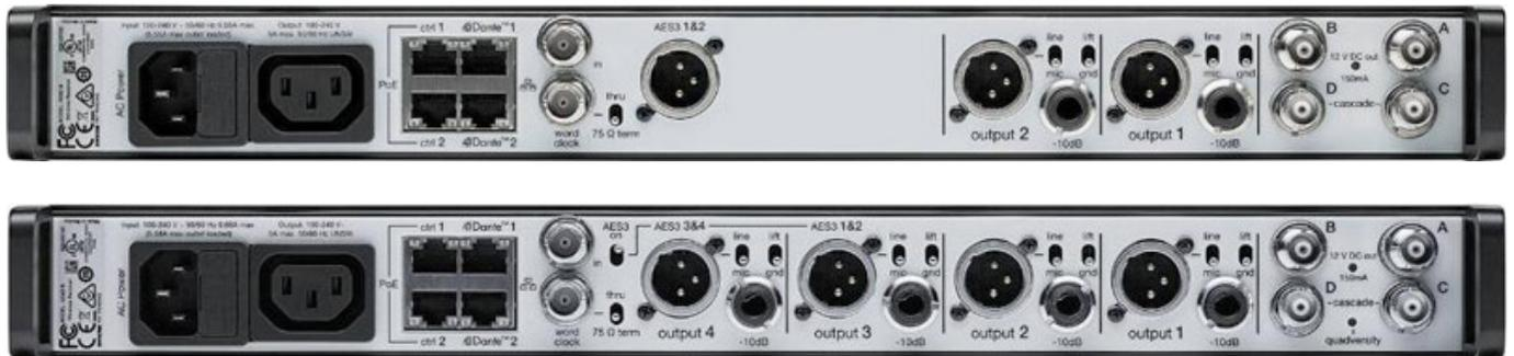
Die beiden Empfänger sind kompatibel mit allen Axient Digital Sendern. Sie verfügen über eine Möglichkeit der netzwerkbasierter Steuerung und es gibt AES3- und Dante-Digital-Audio-Ausgänge (s. Abb. oben AD4D sowie AD4Q) und Wordclock I/Os (BNC). Die analogen Audioausgänge sind symmetrisch als XLR oder unsymmetrisch als 6,3-mm-Klinkenbuchse (-10 dB Pegel) verfügbar.
