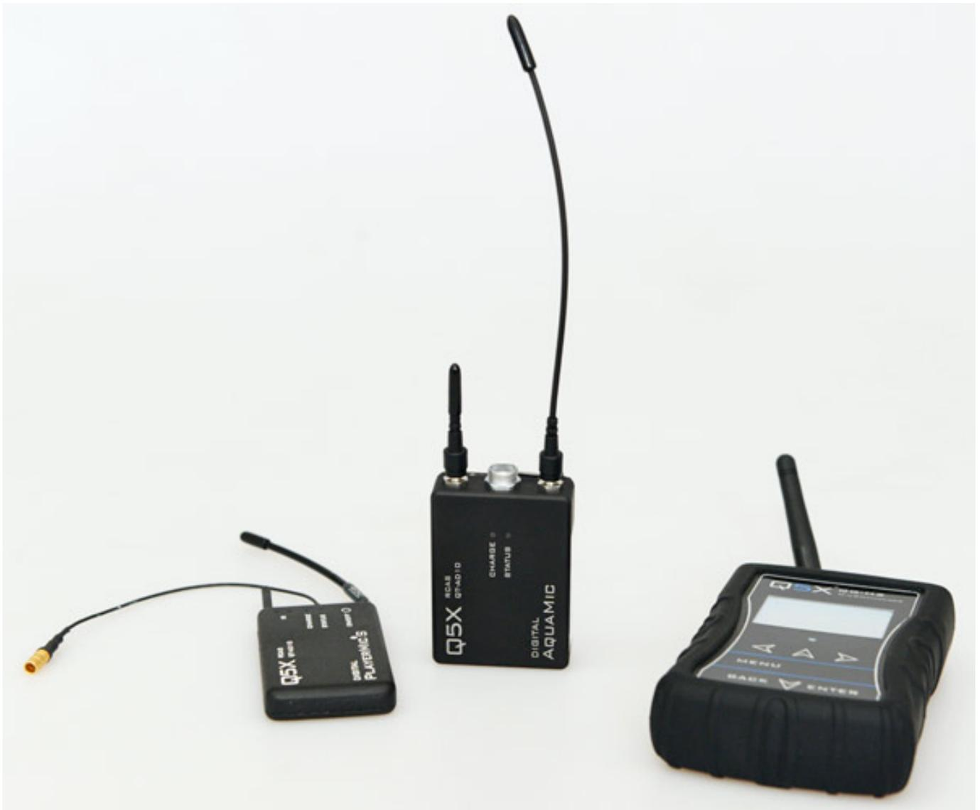
Besonders interessant ist noch zu erwähnen, dass auch der kanadische Hersteller [Quantum5X](#) Axient Digital-kompatible Sender anbietet (s. Abb. oben), die in Zusammenarbeit mit Shure entstanden sind. Diese Sender sind speziell für den Einsatz im Sportbereich gedacht. Das Q5X PlayerMic ist biegsam und extrem robust, während das Q5X AquaMic - wie es der Name vermuten lässt - wasserdicht ist und das bis zu zehn Meter Wassertiefe.
