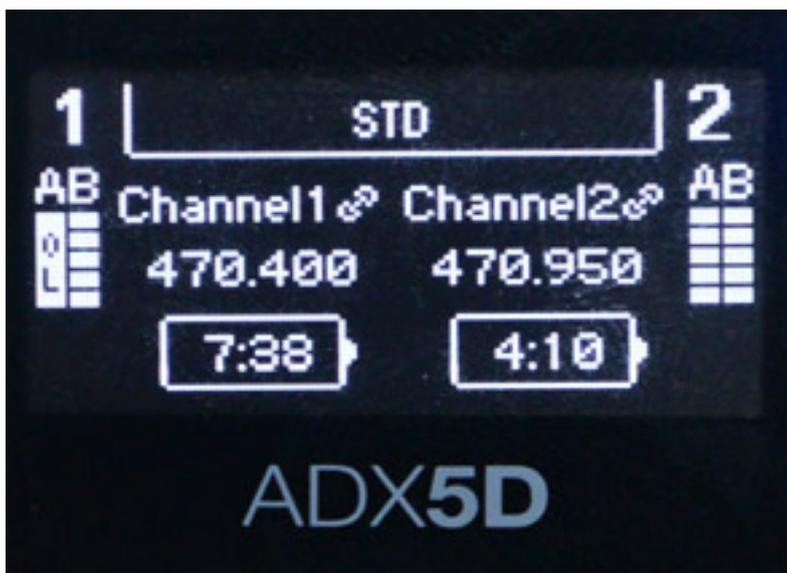
Der ADX5D ist mit einem sehr gut ablesbaren OLED-Display ausgestattet, welches Aufschluss über die wichtigsten Betriebsparameter, wie Akkuzustand und Empfangsfeldstärke, bietet (s. Abb. oben).
