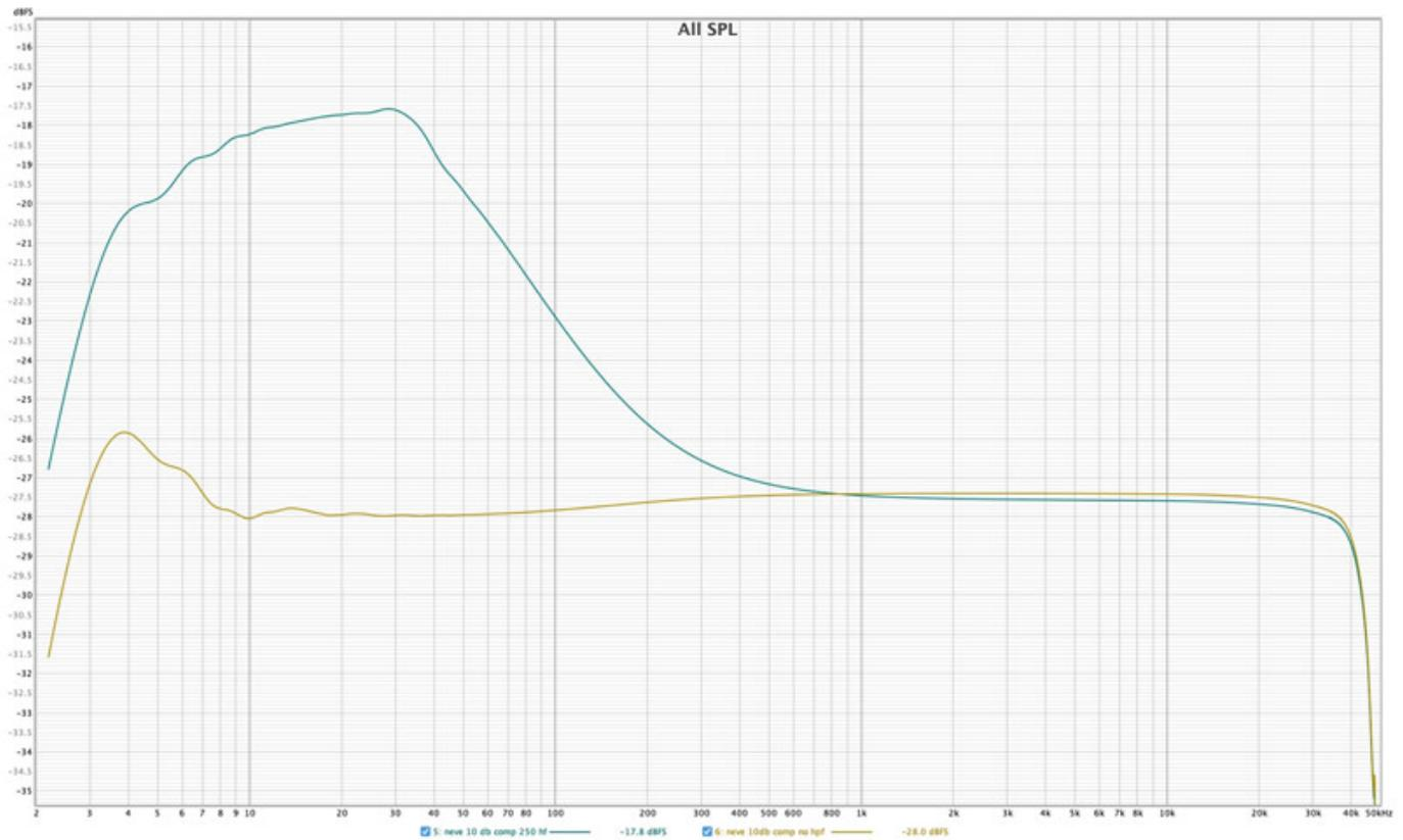
Ausgangspegel des RND 5254 bei 10 dB Kompression mit und ohne HPF bei 250 Hz.
