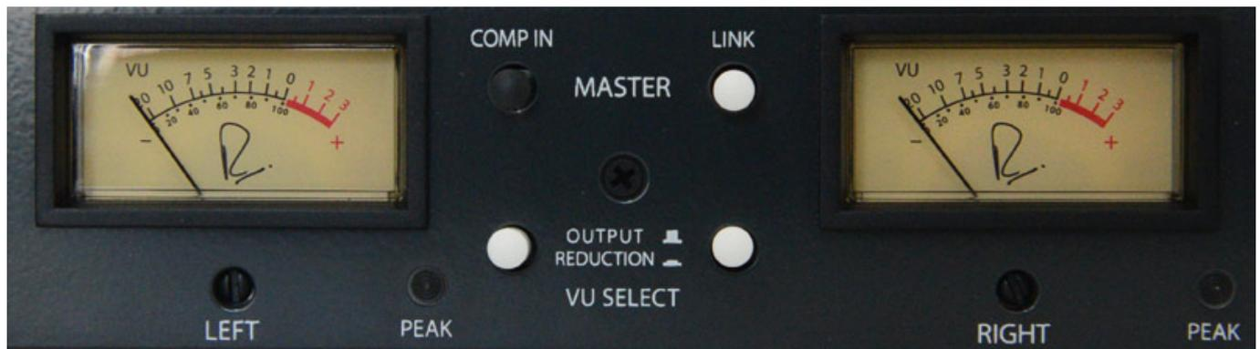
Unter den VU-Metern befindet sich jeweils eine Einstellschraube für den (mechanischen) 0-Punkt des VU-Meters sowie eine Peak-LED für den jeweiligen Kanal. Auf der rechten Geräteseite sind die gleichen Einstellungen für den zweiten Kanal. Die Schalter sind teils beleuchtet, teils nicht. Beleuchtet sind die Schalter für S/C (grün), Fast (gelb), Comp In (grün) und unbeleuchtet sind die Schalter für S/C Insert Link und VU-Select.
