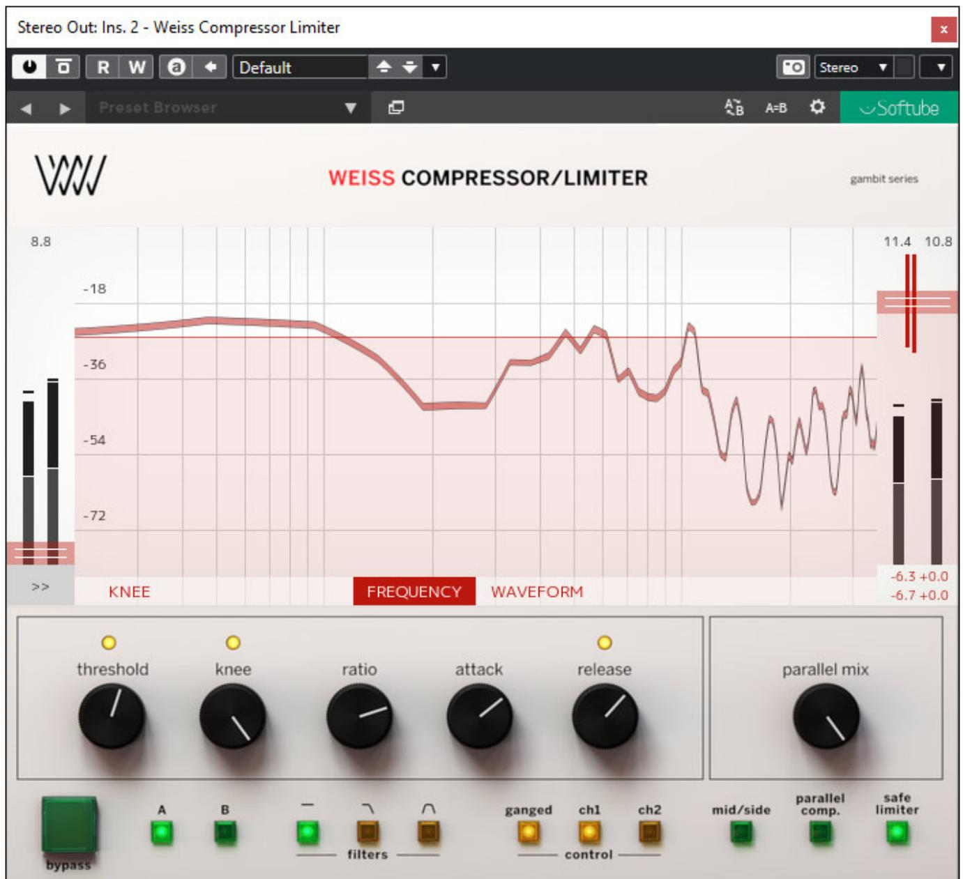
Der zweikanalige Softube Weiss Compressor/Limiter ist gegenüber dem Weis DS1-MK3 deutlich einfacher gestaltet. Er bietet aber auch M/S-Funktionalität und Parallel-Kompression. Der Pegelanteil lässt sich hier über einen eigens dafür bestimmten Regler anpassen.
