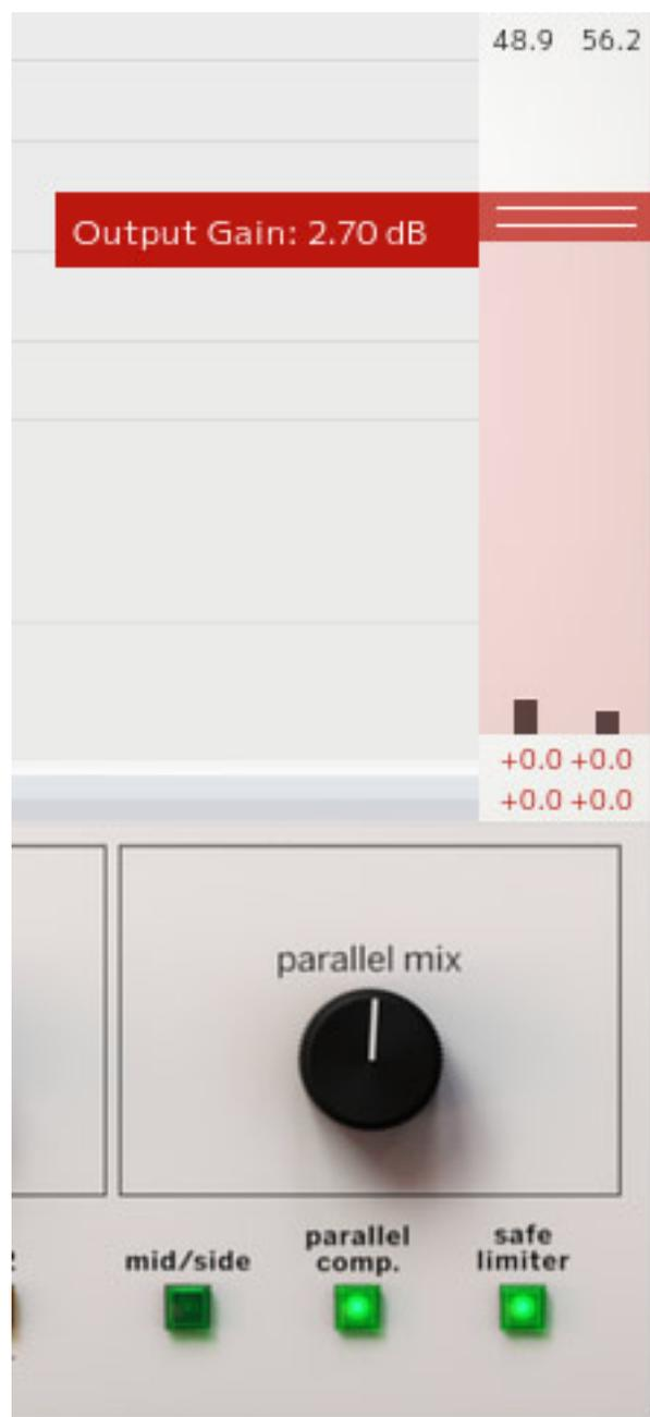
Links im Plug-In-Window ist der Bargraf und Schieberegler für den Input-Level (zwei horizontale Linien) und rechts Bargraf und Schieberegler für den Ausgangspegel (s. Abb. oben).
