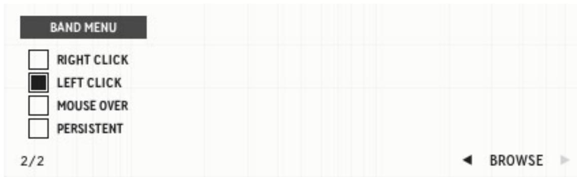
Beim Anklicken (linke oder rechte Maustaste), Mouse Over oder bei Parameter-Veränderung werden die Bandparameters im Display (s. Abb. unten) angezeigt. Welche Funktion dies auslöst, lässt sich im Konfigurationsdialog auf der zweiten Seite einstellen (s. Abb. oben).
