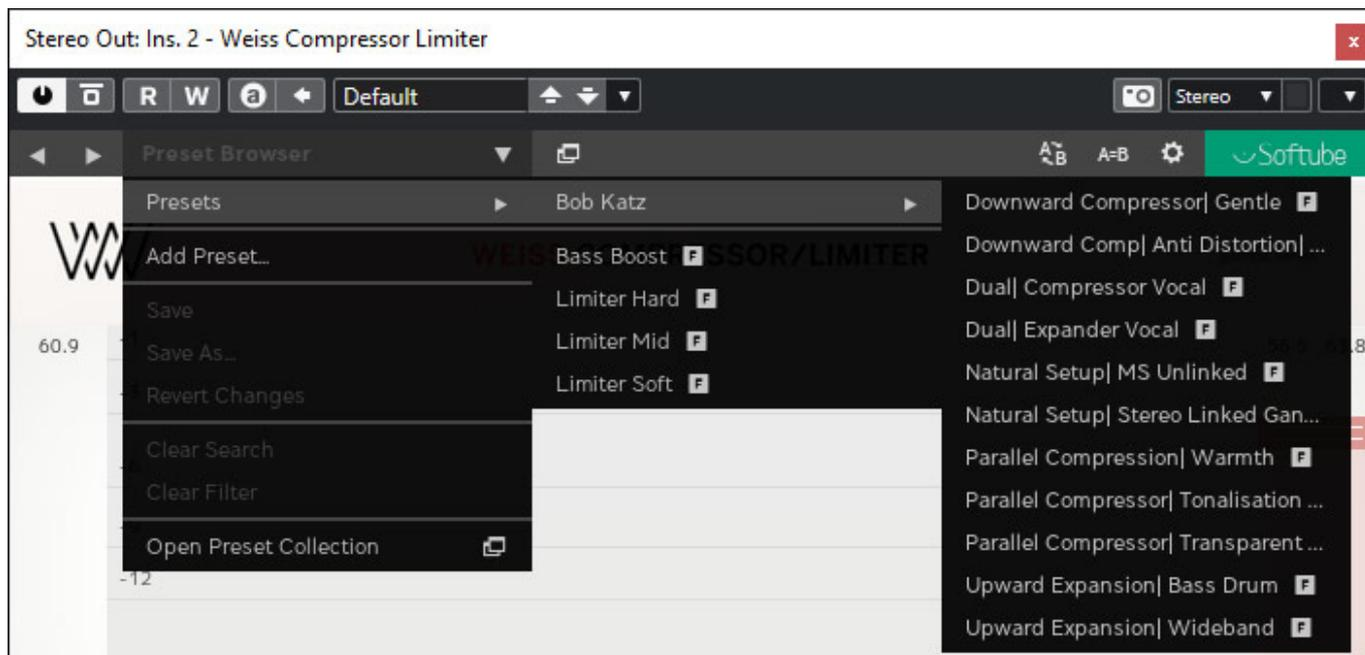
Die Preset-Verwaltung ist von der Funktionalität so wie bei den DS1-MK3 und EQ1 Softube Plug-Ins (s. Abb. oben und unten) und den weiteren hier vorgestellten Plug-Ins.
