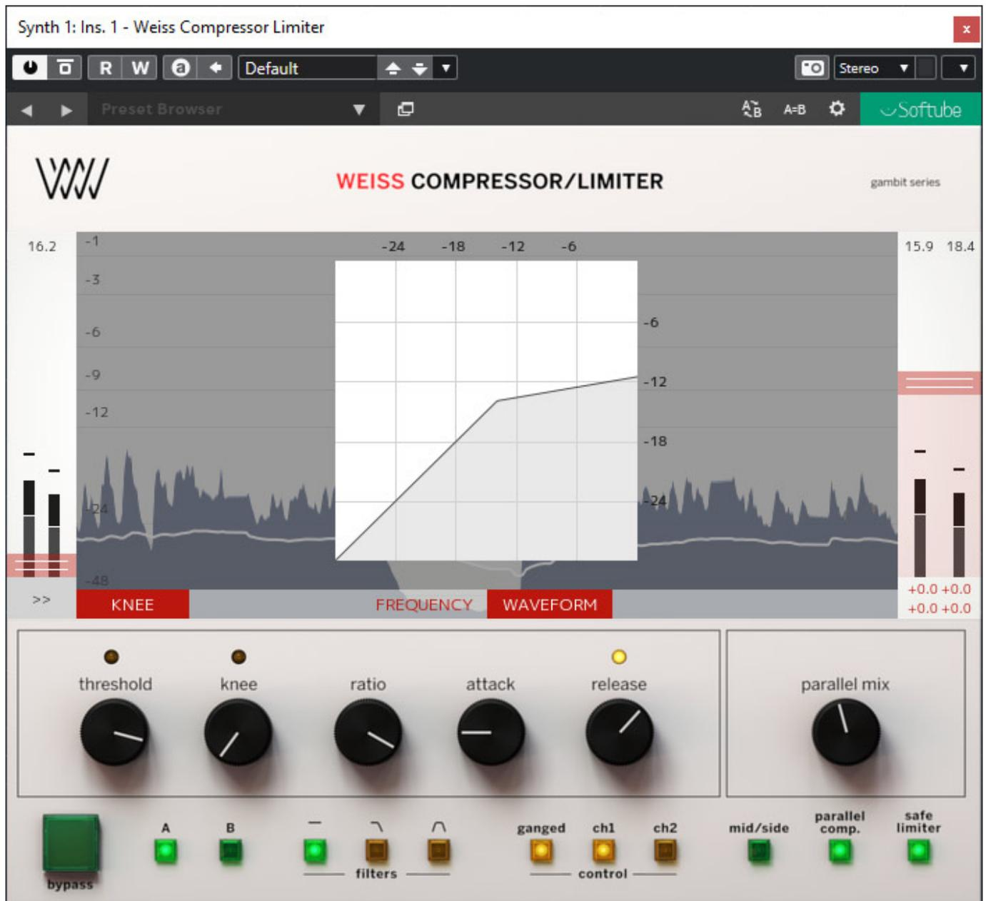
Bei Anwahl von "KNEE" wird die Kompressor-Übertragungsfunktion auf dem Display als Overlay ausgegeben (s. Abb. oben).
