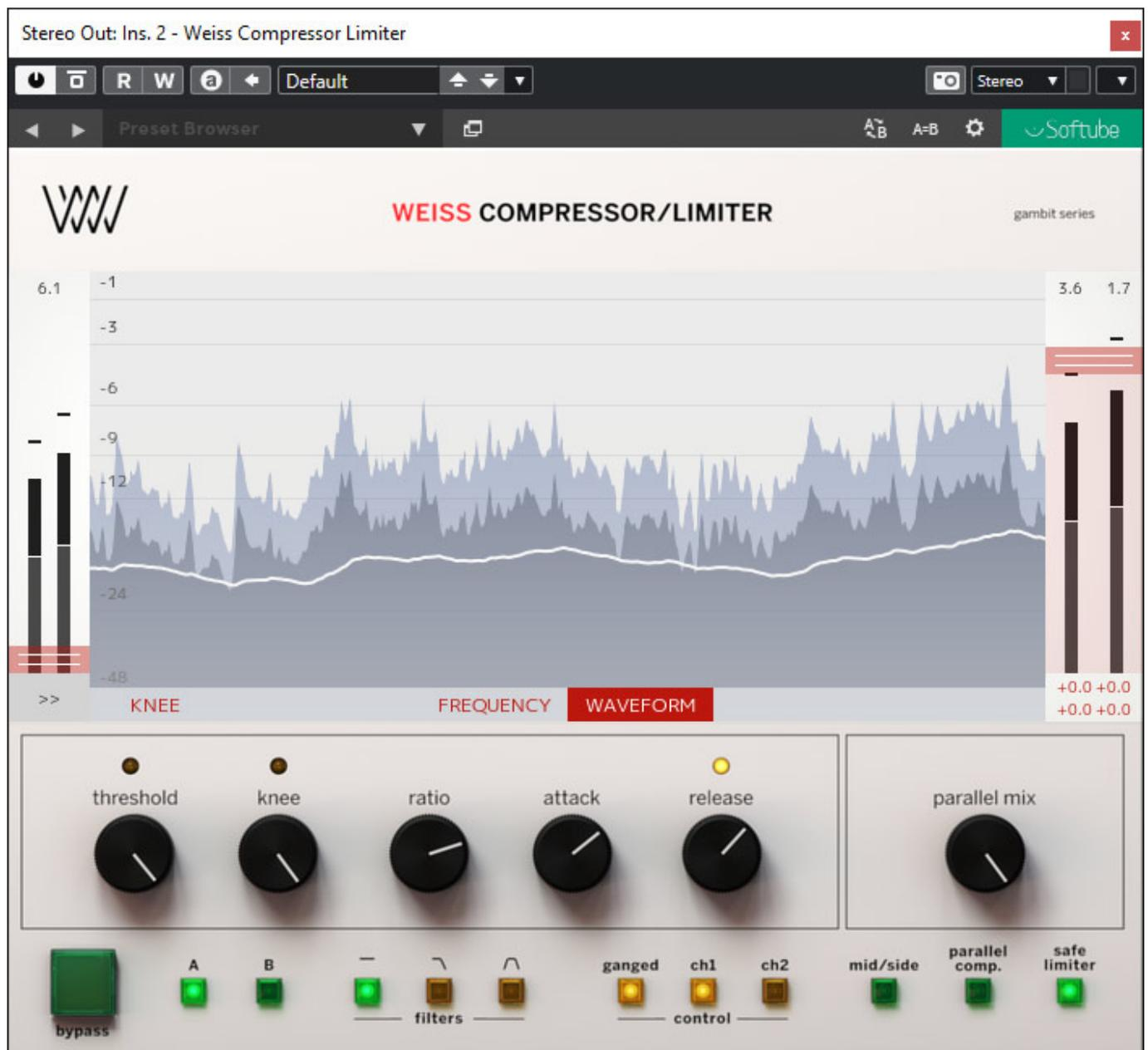
Das Display lässt sich auf eine Frequenz- (erste Abb. im Abschnitt) oder Waverform-Darstellung (Abb. oben) umschalten.
