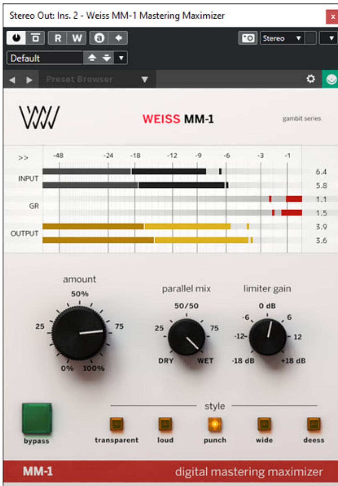
Der auf dem DS1-MK3 basierende MM-1 Master Maximizer ist ein weiteres Applikations-zugeschnittenes Plug-In zur Lautheitsoptimierung. Im Display werden Bargraf-Meter für Input, Gain Reduction und Output Gain angezeigt.
