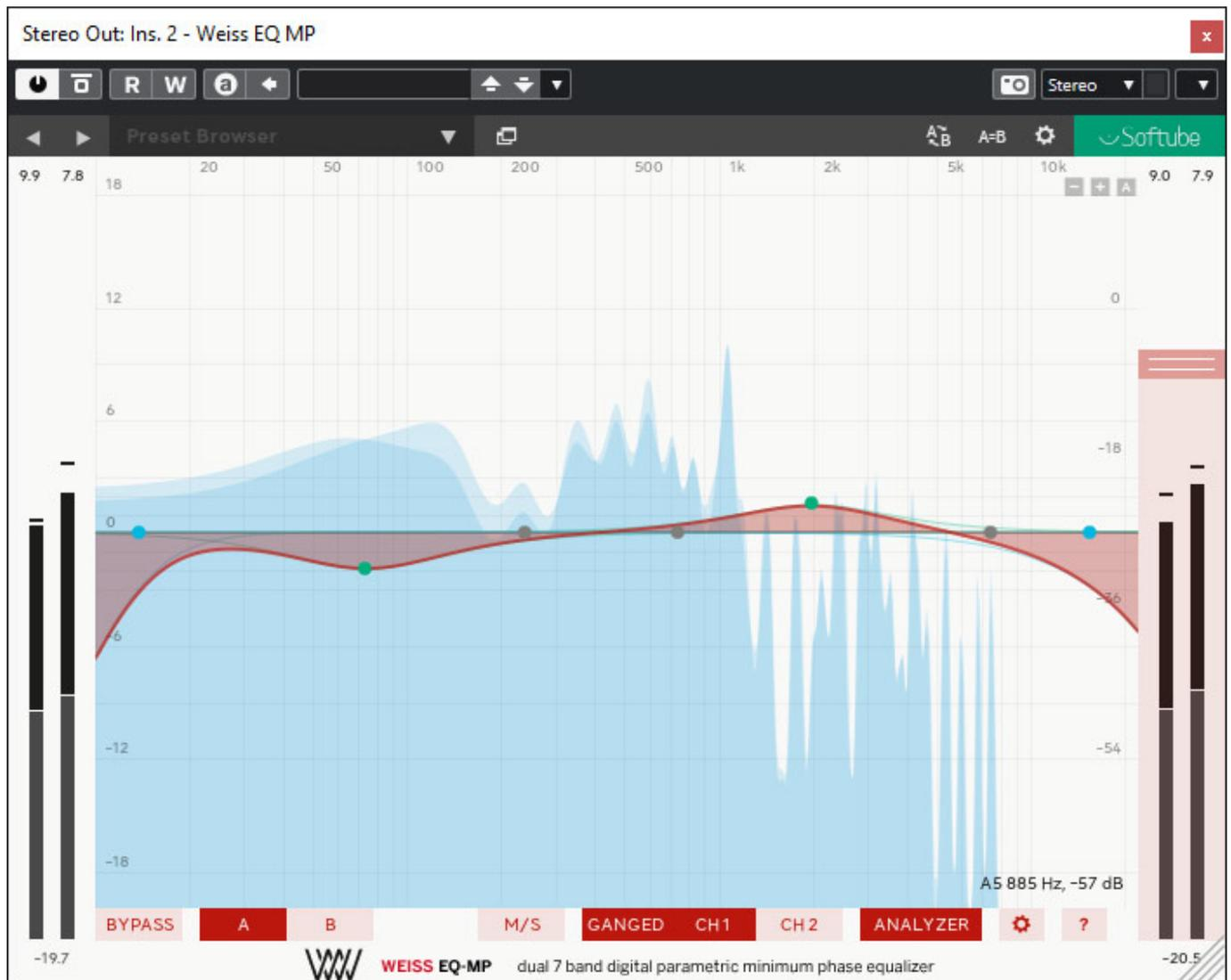
Der EQ MP (MP steht hier für Minimum Phase) ist eine reduzierte Version des EQ1 in der Hardware-Variante MK2 und bietet zweikanalig sieben Filterbänder. Wer ein linear Phase Filter einsetzen möchte, muss auf das EQ1-MK2 Softube Plug-In setzen, denn da kann man das Filter auf ein Linear-Phase-Modus setzen. Welchen Filtertyp man einsetzt hängt halt auch sehr vom Material ab, das man bearbeitet. Mir persönlich gefallen die Minimum Phase Filter prinzipiell aber sehr gut.
