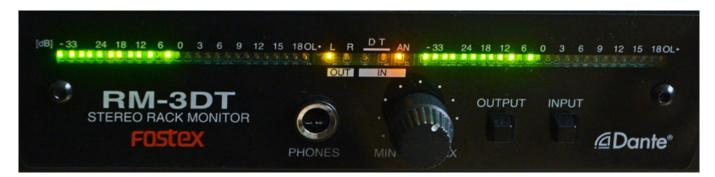
An der Front gibt es neben den beiden LED-Bargraf-Meter (jeweils 24 LEDs, Pegelbereich -33 bis +17 dB) noch Indikator-LEDs, die mit den beiden Schaltern für Input (Quellen-Selektion) und Output (Kanal-Ausgabeformat) korrespondieren. Der Pegelregler gestattet die Regelung sowohl des Lausprecher-, als auch des Kopfhörerpegels. Durch Drücken des Reglers wird eine Stummschaltung aktiviert.
