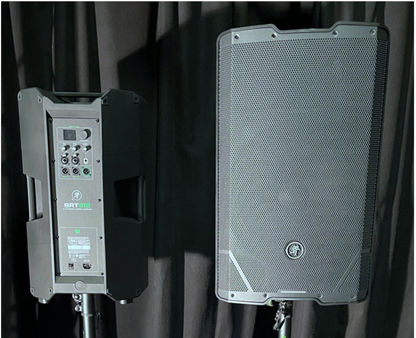
Für Festinstallationen bietet sich eine Befestigung über die integrierten M10-Montage Punkte an. Alternativ können die Kandidaten auch auf einer Distanzstange oder einem Lautsprecherstativ aufsitzen. Dank der verbauten Dual-Stativaufnahme kann der Anwender zwischen einer geraden (0 Grad) oder leicht geneigten Aufstellposition (+7 Grad) wählen.
