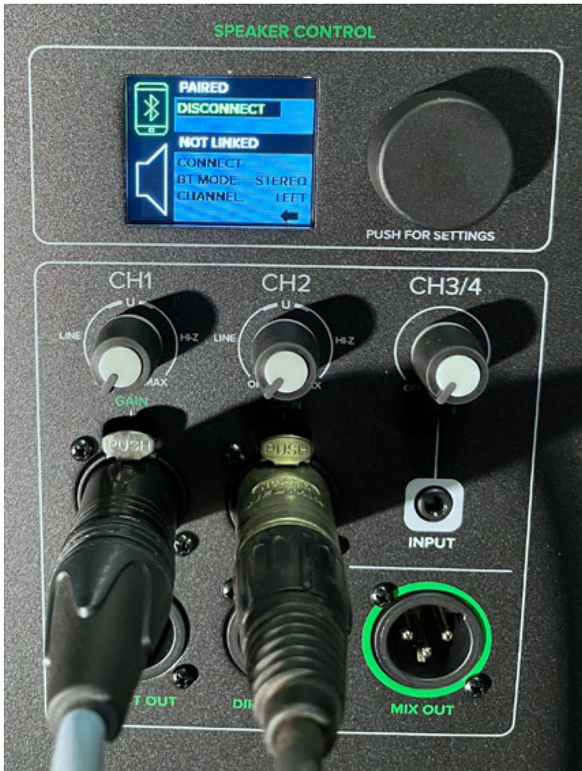
Für die Kanäle 3 und 4 steht nur ein Gain/Volume Poti bereit. Über eine Stereo-Miniklinkenbuchse kann ein Zuspeler andocken. Alternativ gibt dieser Kanal ein Bluetooth Stream eines Smartphones, Tablet Rechners oder Laptops wieder. Das Aktivmodul verfügt aber nicht nur über Eingänge.
