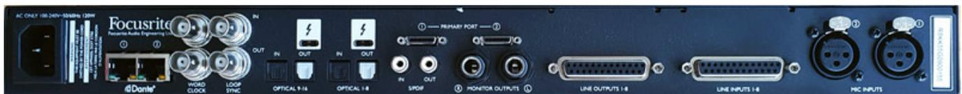
Auf der besagten Rückseite geht es gedrängt, aber übersichtlich zu. Links außen befindet sich der 3-Pol-Kaltgerätestecker für das intern verbaute Netzteil, das 100 – 240 Volt mit 50/60 Hz verarbeitet und damit weltweit im Studio oder on Tour seine Dienste verrichten kann. Direkt daneben sind zwei RJ-45 Ethernet-Buchsen untergebracht, die eine Kommunikation mit einem Dante-Netzwerk herstellen. Es folgen BNC-Wordclock-Ein- und -Ausgänge und zwei Thunderbolt 3-Anschlüsse.
