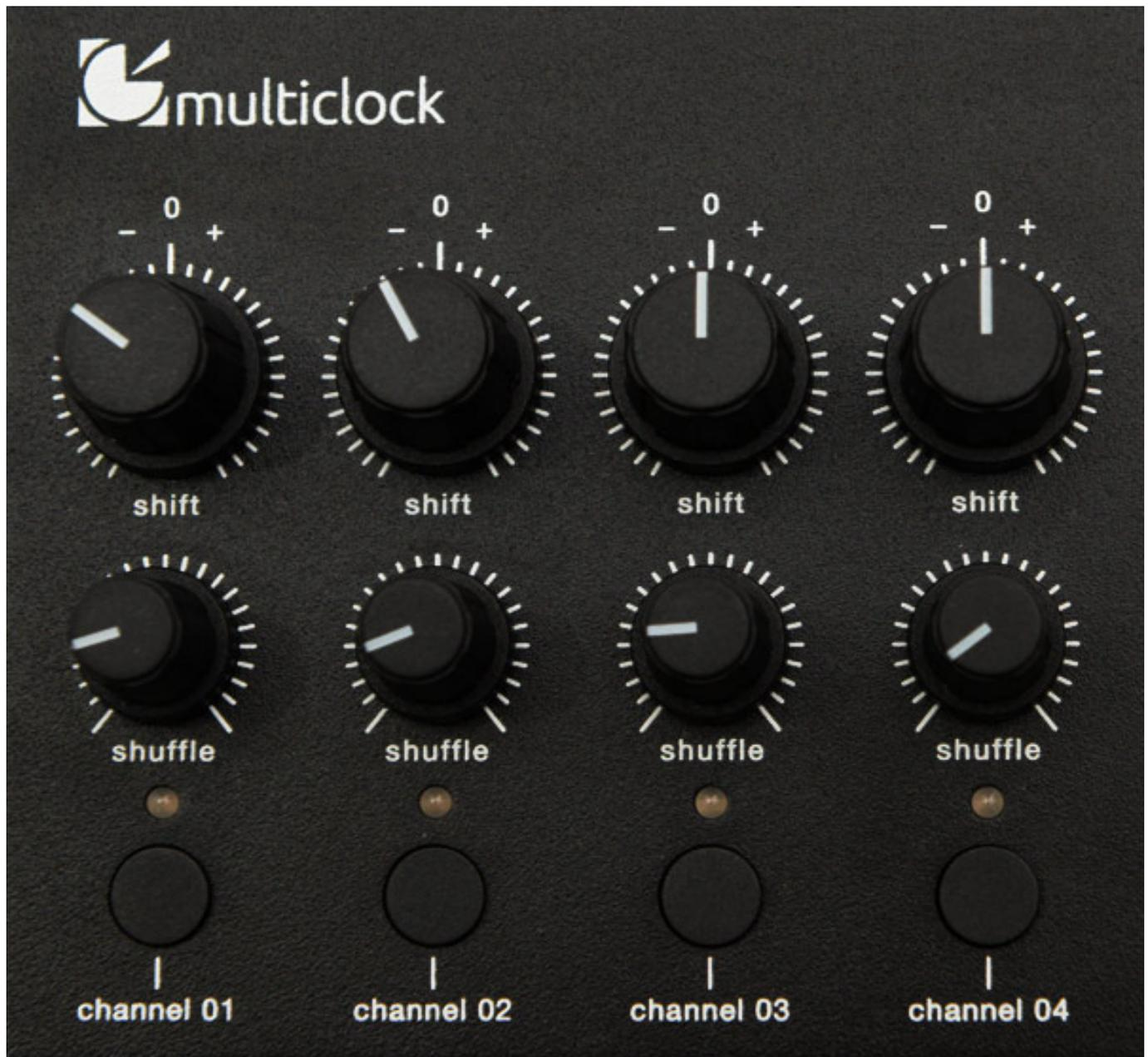
Links auf der Front befinden sich vier Kanalzüge. Pro Kanal steht ein großes "Shift" Poti, ein kleineres "Shuffle" Poti sowie ein Kanal-Wahlschalter zur Verfügung. Auf der rechten Seite findet ein gut lesbares Monochrom-Display Platz, umgeben von mehreren Druckknöpfen und einem Endlos-Push-Drehgeber für die Menüführung.
