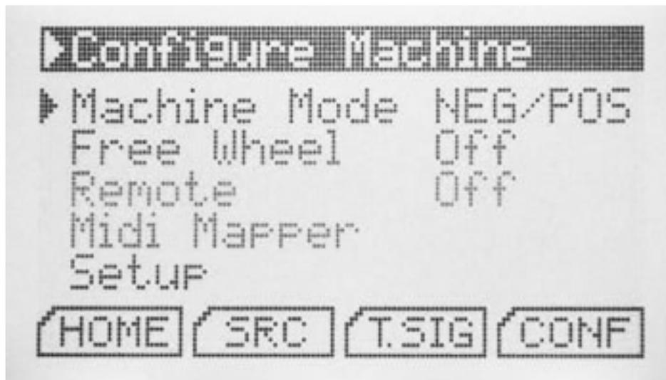
Die Funktion "Free Wheel" ist besonders bei einer Live-Performance interessant. Ist diese aktiviert, springt automatisch die interne Clock ein, falls es zu einem Absturz der DAW oder einem Kabelbruch kommt. Selbst wenn in der Multiclock kein Audio-Signal mehr ankommt, läuft sie also unbeeindruckt weiter frei nach dem Motto: „The Show Must Go On“. Anhalten lässt sich die Multiclock dann durch einen MIDI-Stop Befehl via USB oder MIDI-Eingang.
