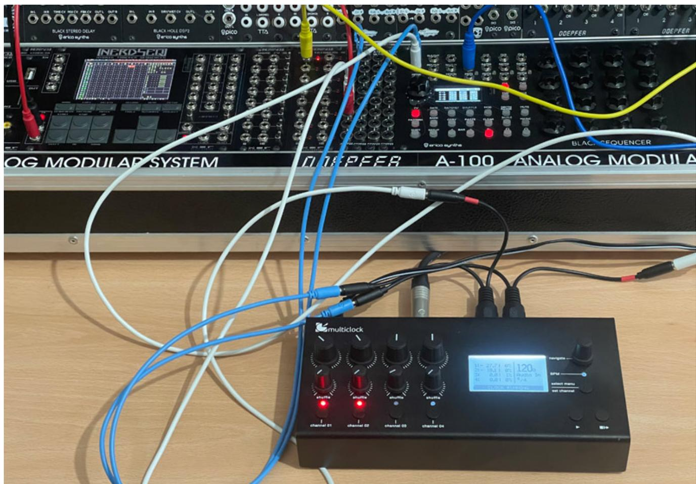
Also habe ich mal ein Setup mit XOR NerdSeq sowie Erica Synths Black Sequencer die verschiedene Drum-Module ansteuern in Verbindung mit mehreren internen virtuellen VST-Instrumenten eingerichtet. Die Sequenzer erhielten Ihre Clock und auch das Reset-Signal von der Multiclock. Übrigens bietet der Hersteller E-RM auch ein Adapterkabel für diesen Zweck an, welches in die MIDI-Buchse gesteckt wird und was Clock- und Reset-Signal auf 3,5-mm-Adapterbuchsen ausgibt.
