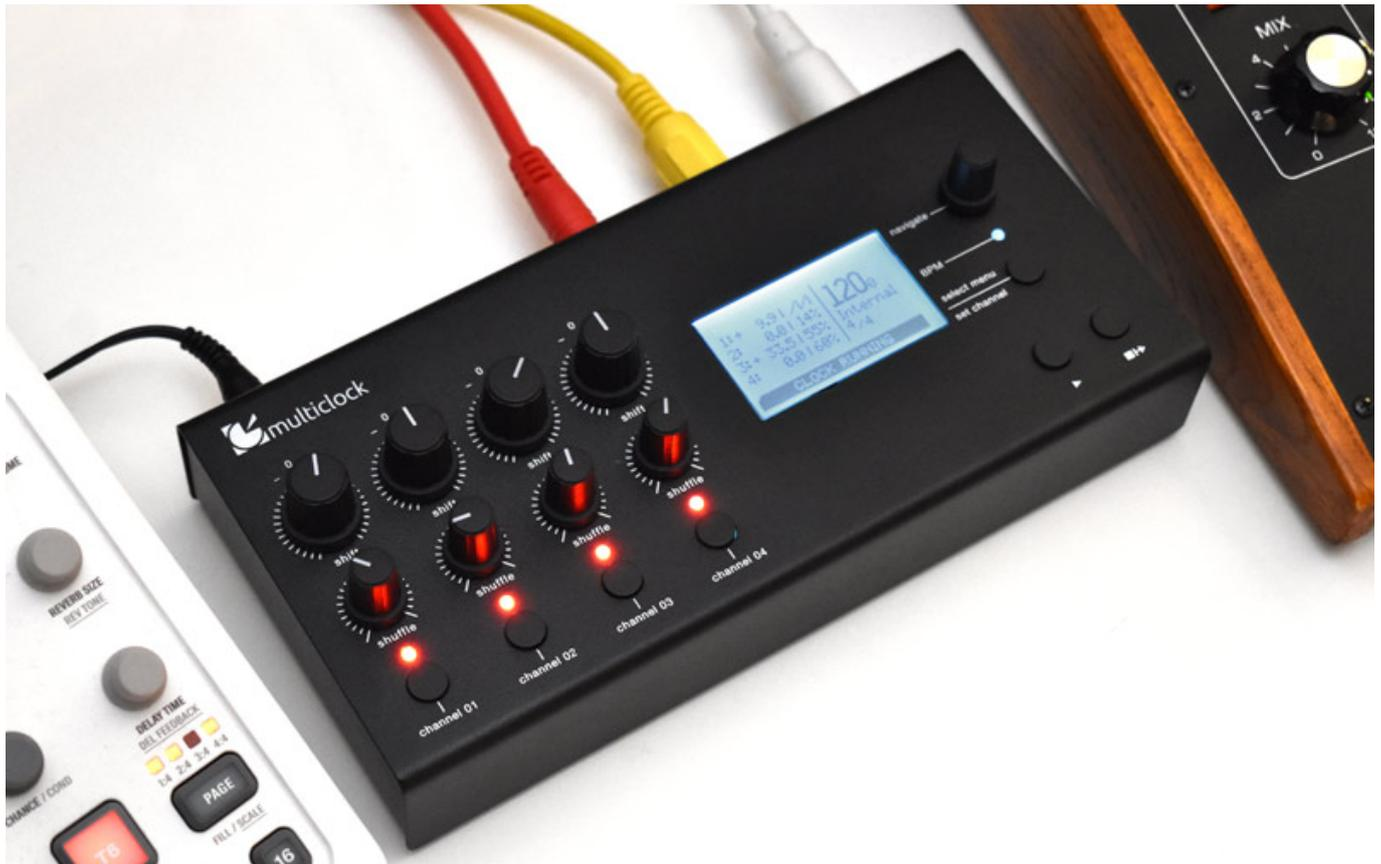
In meinem Fall handelt es sich um einen Elektron-Sampler der den Beat erzeugt, einen Moog Matriarch, einen Moog Subsequent 25 sowie einen älteren Moog The Rogue. Die ersten drei Geräte werden via MIDI verbunden, der Rogue erhält sein Trigger-Signal vom Audioausgang der Multiclock.
