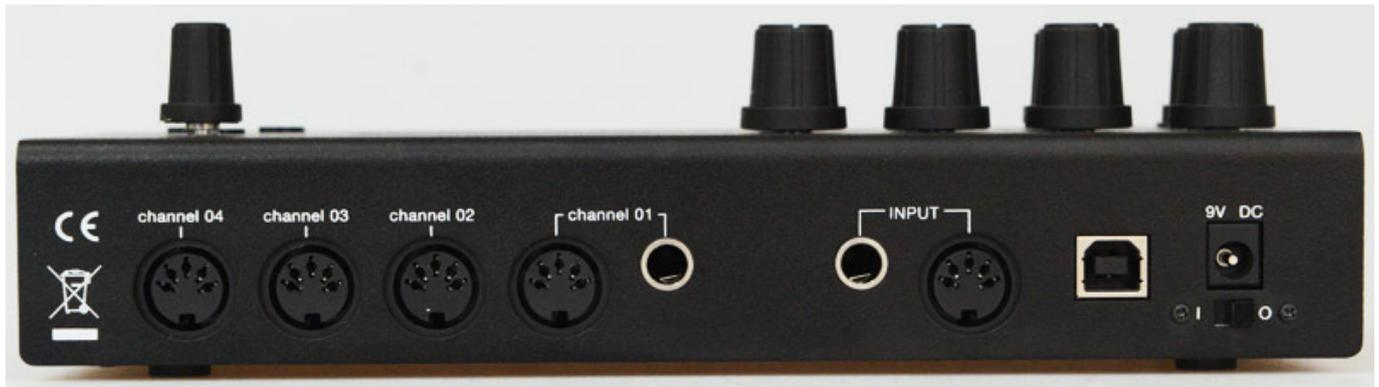
Auf der linken Seite befinden sich vier MIDI-Ausgänge, wobei Kanal 1 ein besonderes „Schmankerl“ bereithält: Hier ist neben der MIDI-DIN-Buchse noch ein 6,3 mm Ausgang zu finden, der ein analoges Clock-Signal ausgibt und bei Bedarf sogar als LFO fungiert. Dieser kann Sine, Pulse, Saw Up, Saw Down und Random Signale senden, um Filter, etc. im Takt zu beeinflussen.
