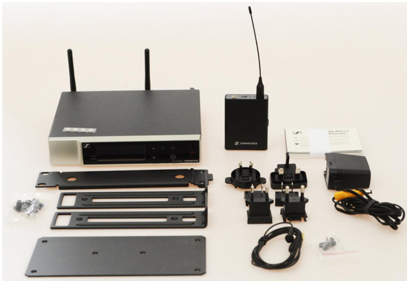
Hier einmal der Lieferumfang des EW-D ME2 Set, als mit stationärem Empfänger, Taschensender und Lavalier ME 2 Mikrofon. Im Lieferumfang befinden sich zwei abwickelbare Dipolantennen mit BNC-Stecker. Das Netzteil wird mit Adapter für den weltweiten Einsatz geliefert. Weiter gibt es vier selbstklebende GummifüÙe, falls man den Empfänger als Tischempfänger aufstellen möchte, sowie ein Set für die Rack-Montage eines oder zwei 1/2 19"-Empfänger. Als Anleitung liegt eine Kurzanleitung bei.
