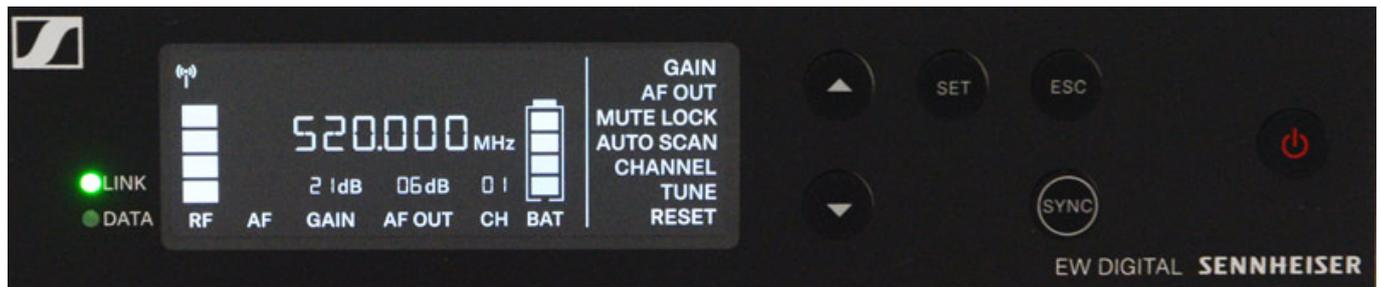
Auf der Front neben dem Display, welches die Betriebsfrequenz, HF- und Audio-Pegel sowie Batteriestatus anzeigt, lässt sich nach Betätigung des Tasters SET mit den Up/Down-Tastern einer der sieben Menüpunkte anwählen und mit der Set-Taste selektieren.
