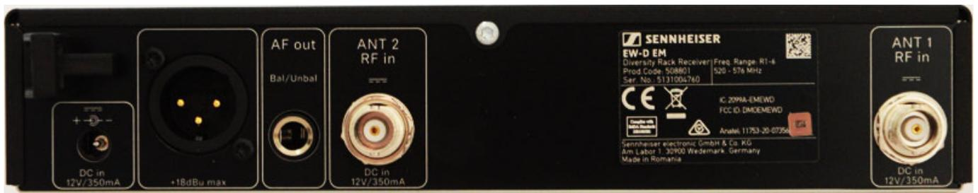
Auf der Rückseite findet man Anschlüsse für Betriebsspannung, bzw. dem beiliegendem Steckernetzteil, zwei BNC-Antennen-Buchsen für den Diversity-Betrieb, sowie Audio-Ausgang in Form einer XLR-Buchse (elektronisch symmetriert)
