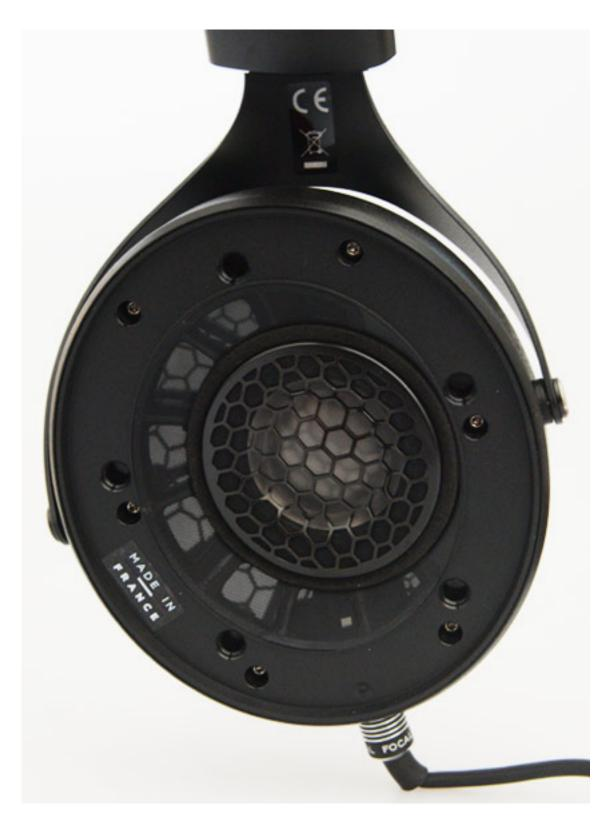
Dies setzt sich bei der Abdeckung über dem Treiber fort (s. Abb. oben), denn auch hier ist die wabenförmige Struktur mit deutlich größeren Öffnungen versehen. Der Treiber selbst ist leicht versetzt und geneigt eingebaut um so einen erhöhte Außerkopf- und Front-Lokalisierung beim Hören zu erreichen.
