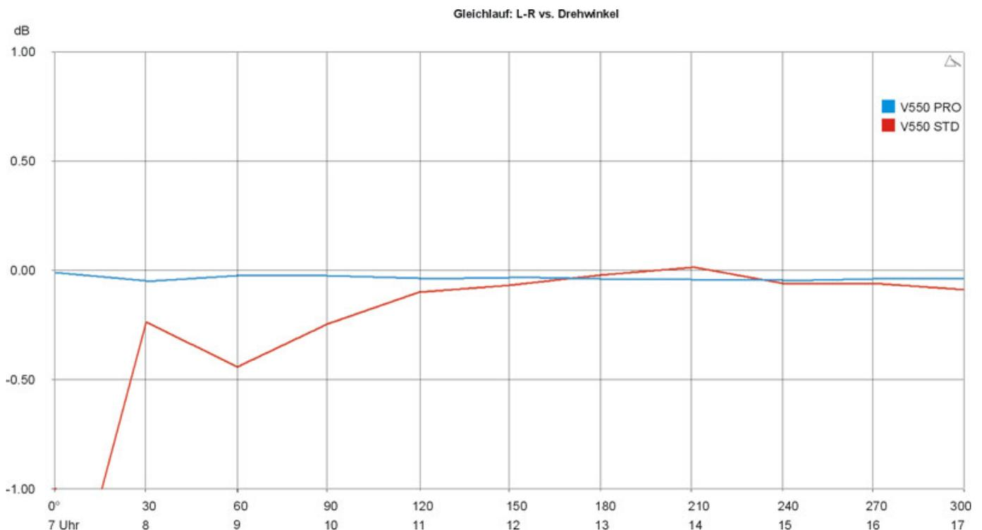
Als erstes eine Messung wo man einmal den Gleichlauf, bzw. Abweichung Pegelregler-Position zum Pegel ablesen kann (s. Abb. oben). Man sieht hier deutlich, dass bei der Pro-Version des V550 (blaue Linie) durch die mit Reed-Relais geschaltete Widerstandsmatrix eine deutlich höhere Präzision bei Reglerstellung im Bereich 7 bis 12 Uhr erreicht wird.
