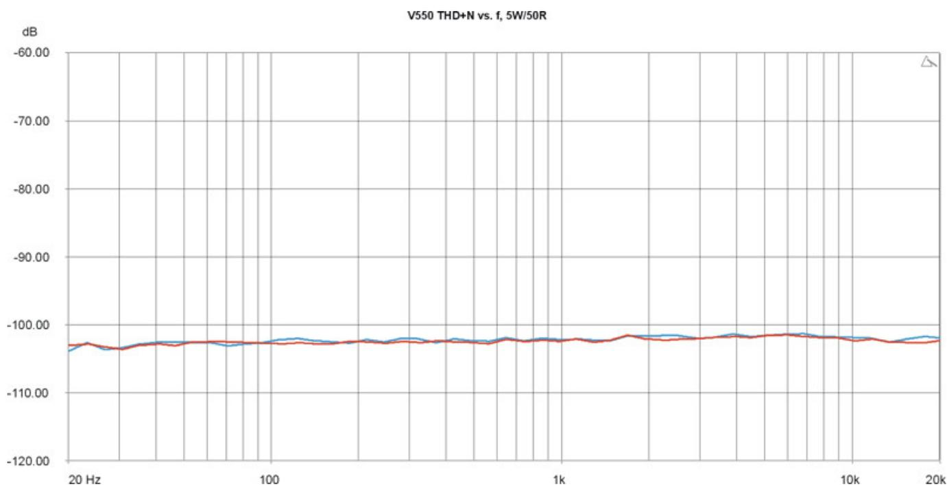
Der THD+N beträgt bei 1 Watt -100 dB und bei 5 Watt ca. -102 dB. Insgesamt kann man messtechnisch dem V550 / V550 PRO absolute Bestnoten vergeben.
