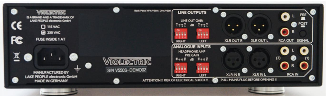
Auf der Rückseite befinden sich als Eingänge zwei XLR-Buchsen (symmetrisch) sowie zwei mal zwei Cinch-Buchsen (unsymmetrisch). Die Eingangsimpedanz für die Eingänge beträgt zehn Kiloohm und die maximale Eingangsspannung +21 dBu. Besonders interessant ist, dass sich die Eingangsverstärkung über zweimal vier DIP-Schalter im Bereich von +/- 18 dB in 6-dB-Schritten anpassen lässt.
