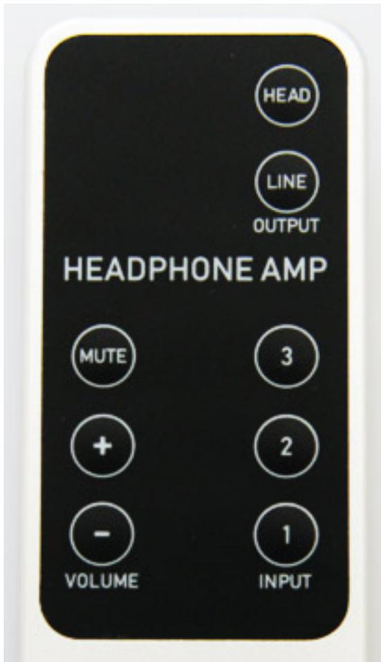
Im Lieferumfang befindet sich auch eine Infrarot-Fernbedienung. Mit ihr kann man die Eingangsquelle anwählen, die Ausgänge aktivieren, bzw. auch ein Mute vornehmen, und die Lautstärke mit den Plus/Minus-Tasten regeln. Die Lautstärkeregelung erfolgt dabei am Kopfhörerverstärker motorisch.
