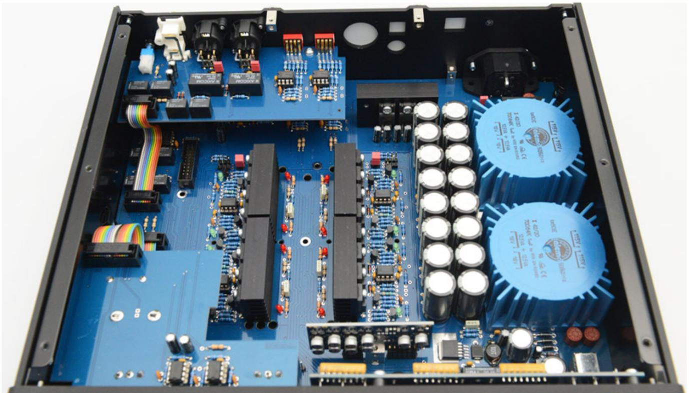
Der Kopfhörerverstärker ist völlig komplett diskret aufgebaut und wird handbestückt in Deutschland gefertigt. Auf der einen Seite ist das Produkt sehr puristisch, es bietet aber, wenn man sich das Gerät ansieht, gerade für den Einsatz im professionellen Bereich äußerst interessante Leistungsmerkmale.
