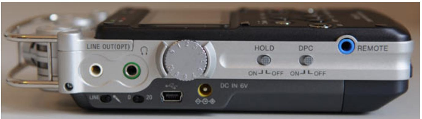
Auf dieser Seite befinden sich auch noch Anschlüsse für eine Drahtfernbedienung - die es als Option gibt - sowie ein USB-Anschluss, für die Verbindung zu einem Computer. Ein entsprechendes USB-Kabel gehört zum Lieferumfang.
