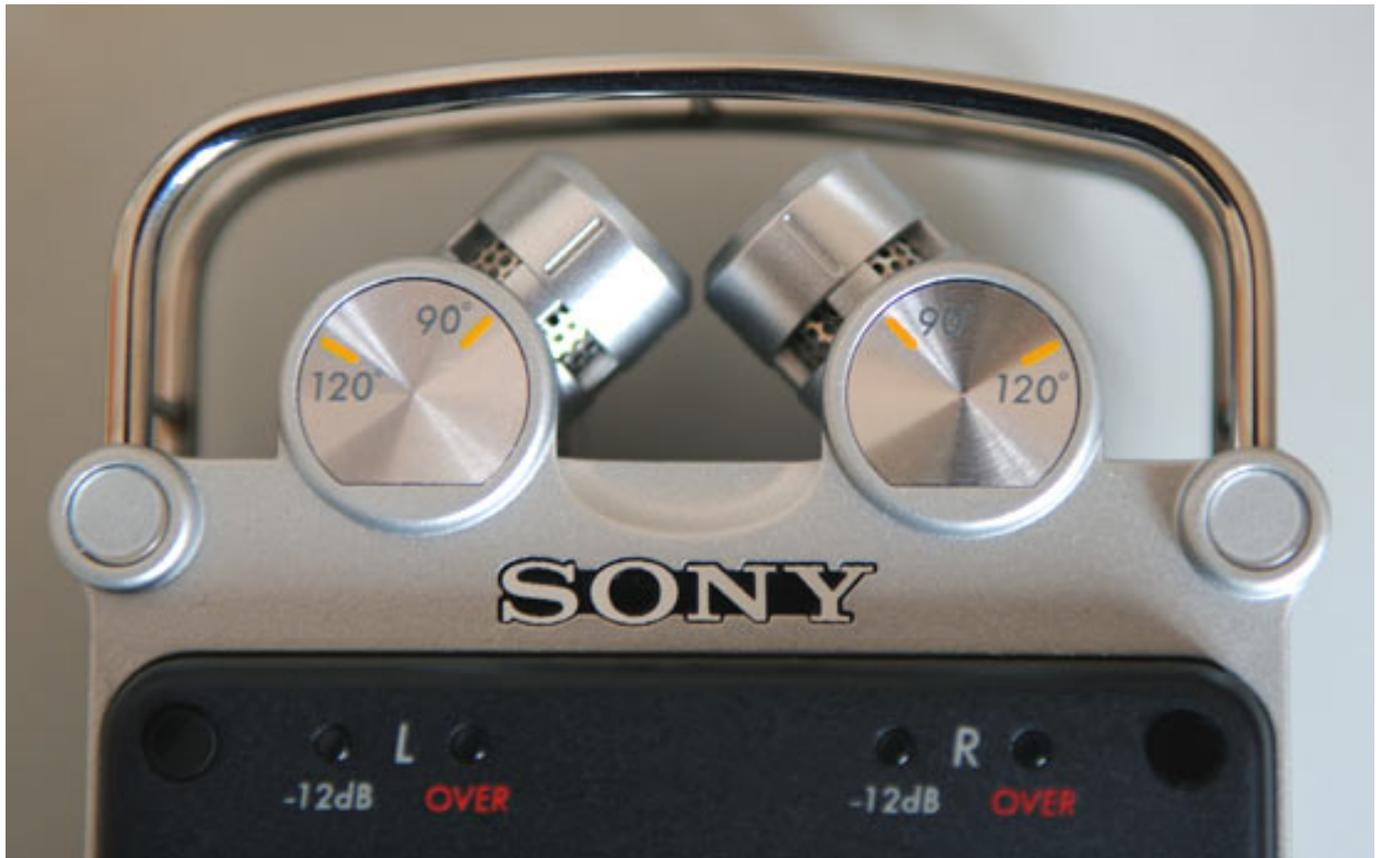
Die beiden, über einen robusten Bügel geschützten, integrierten Mikrofone sind Elektret-Kondensatormikrofone, die sich in drei Positionen verstellen lassen und zwar 90 Grad (XY-Anordnung), 120 Grad, bzw. 0 Grad (klein AB-Anordnung mit 33 mm Abstand). Für Außenaufnahmen gibt es noch einen aufsteckbaren Windschutz aus Fell, der auch den Anforderungen im Reportagebereich stand hält. Es scheinen nicht die gleichen Mikrofone wie beim PCM-D1 zu sein aber die Mikrofone sind auch sehr hochwertig.
