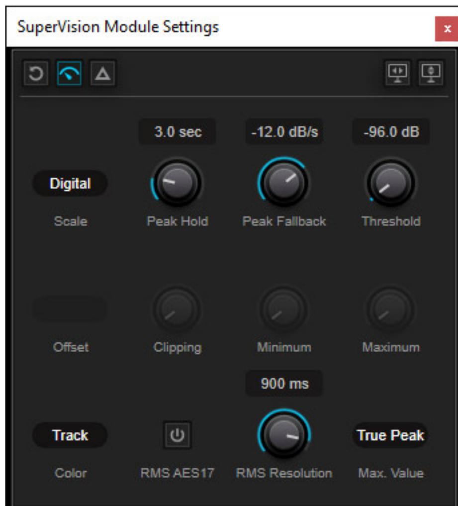
Hier einmal der Dialog für die Einstellung der Pegelaussteuerungsanzeige (s. Abb. oben), bzw. "Level",
