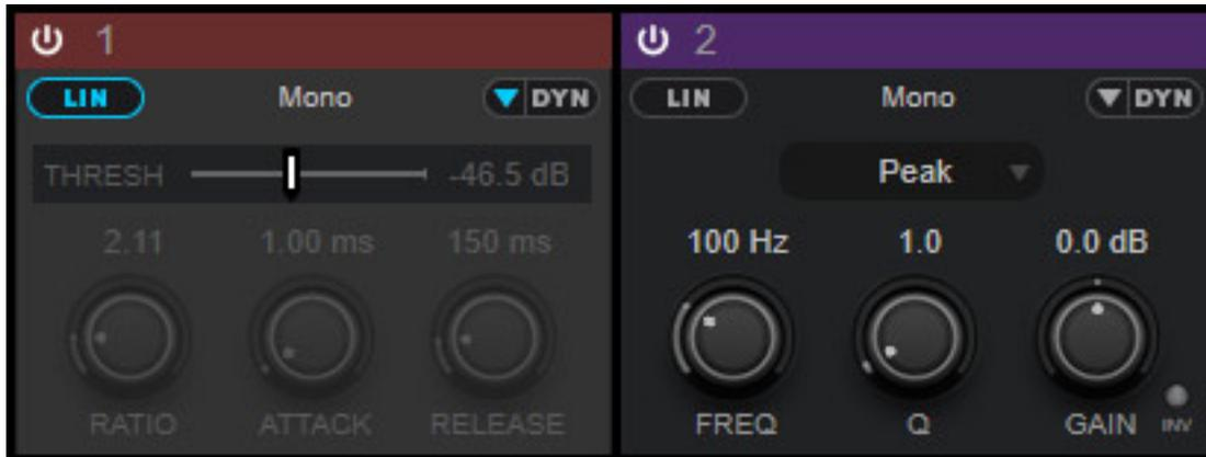
Über den Schalter "LIN" lässt sich jedes Filterband individuell auf Phasenlinearität, mit entsprechend höherer Latenz, umschalten. In diesem Falle ist der Pegeldynamische Betrieb nicht möglich (s. Abb. oben).
