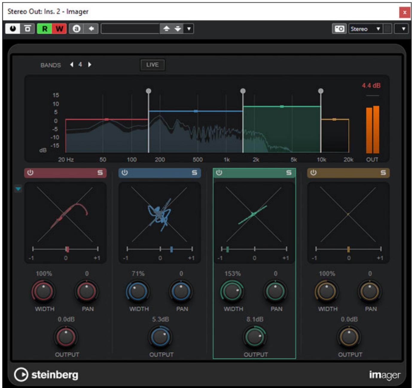
Mit dem neuen Plug-In "Imager" lässt sich die Stereo-Basisbreite, Panorama und den Pegelanteil in bis zu vier Frequenzbändern beeinflussen. Für jedes Band gibt es auch ein Goniometer und eine Korrelationsanzeige. Mit dem Live-Schalter lässt sich das Plug-In in zwei Betriebsarten schalten und zwar bei aktiviertem Live-Modus mit kurzer Latenz und klassischem analogem Filterkonzept oder wenn deaktiviert mit
