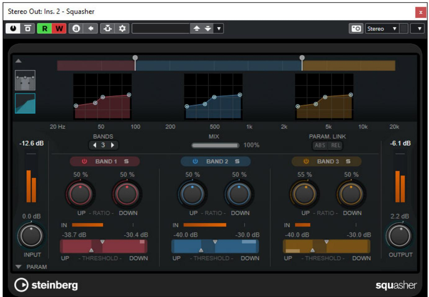
Der obere Bereich lässt sich von einer spektralen Darstellung auf eine Kompressor-Kurvendarstellung (s. Abb. oben) umschalten.
