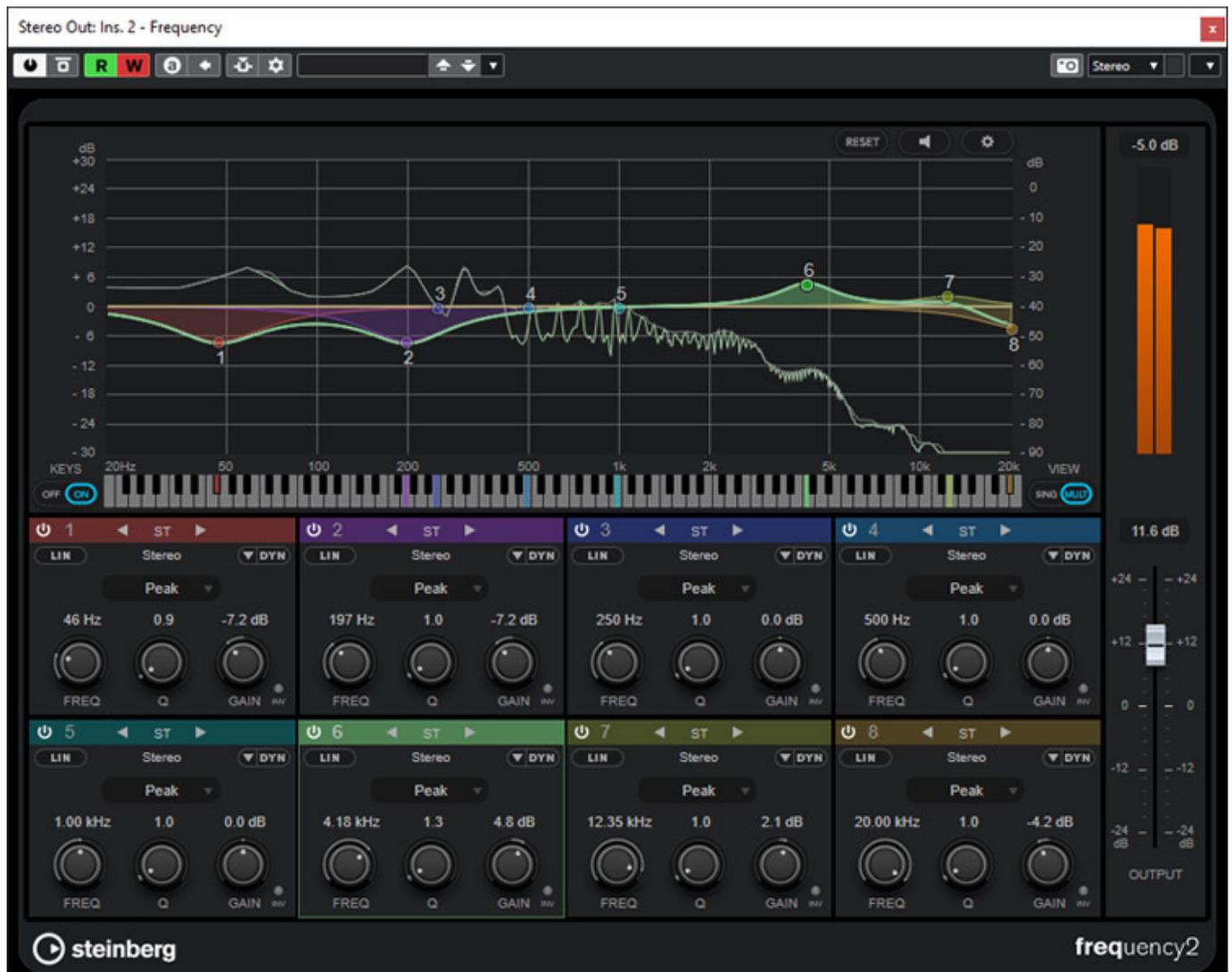
Das Frequency Plug-In geht mit "Frequency 2" nun in die nächste Runde. Das Plug-In bietet acht vollparametrische Filter, interner oder externer Side-Chain und es lässt sich auch dynamisch einsetzen. Über das Icon "DYN" verändert sich die Bedienoberfläche und der Einsatz-Schwellwert, Anstiegs- und Abfallzeit sowie das Ratio, mit dem sich einstellen lässt, wie stark die Filterwirkung nach Überschreiten
