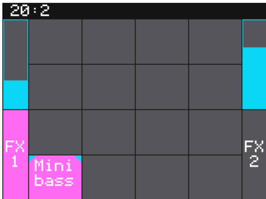
Bei der Bitbox sind auch Effekte an Bord und zwar Delay und Hall. Bei Anwahl von "FX" im Home-Menü wechselt die Darstellung auf den Effekt-Dialog (s. Abb. oben). Über die beiden oberen Regler kann hier der Effektpegel für FX1 (Delay) und FX2 (Hall) eingestellt werden. Mit dem Taster INFO lässt sich für den entsprechenden Effekt die Parameterseiten aufrufen (s. die beiden folgenden Screen Shots).
