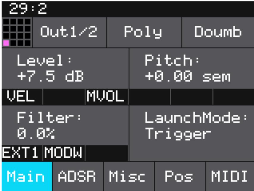
Auf der entsprechenden Seite werden in den Feldern dann die entsprechend angewählten Parameter in Kurzform angegeben (s. Abb. oben), wie in unserem Beispiel für das Filter den Eingang EXT1 sowie das MIDI Modulation Wheel.
