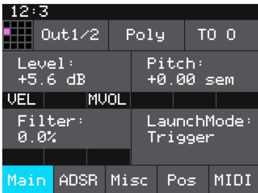
Wenn man im Sample-Editor nochmal die Taste INFO drückt kommt man in verschiedene Parameter-Dialoge. Im Dialog "Main" (s. Abb. oben) lässt sich Audio-Ausgangs-Routing einstellen und zwar auf "Out1/2" oder "Fx1/2" für Stereo-Betrieb oder eben auf einen einzelnen der vier Ausgänge. Weiter lässt sich hier der Sample Pegel und die Tonhöhe (fein) sowie auch ein Filter (Minus- Werte Tiefpass-, Plus-Werte Hochpass-Filter) sowie der Tastenauslöse-Modus (Trigger, Gate, Toggle) einstellen.
