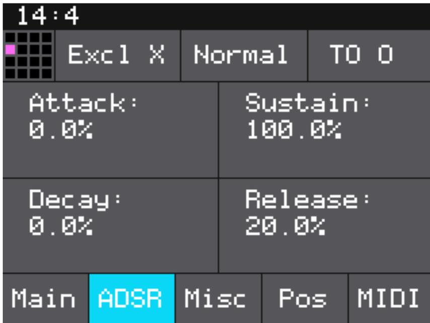
Schon in der MK1-Version wurde durch ein Update auch eine Amplituden-Hüllkurve des Sample möglich und einstellbar (s. Abb. oben).
