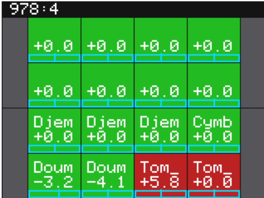
Durch Drücken der Taste INFO wird ein Mute-Dialog aufgerufen. Ein Berühren des jeweilige Pads auf dem Screen schaltet zwischen Ein und Stummschaltung hin und her (s. Abb. oben). Die stummgeschalteten Pads werden rot markiert.
