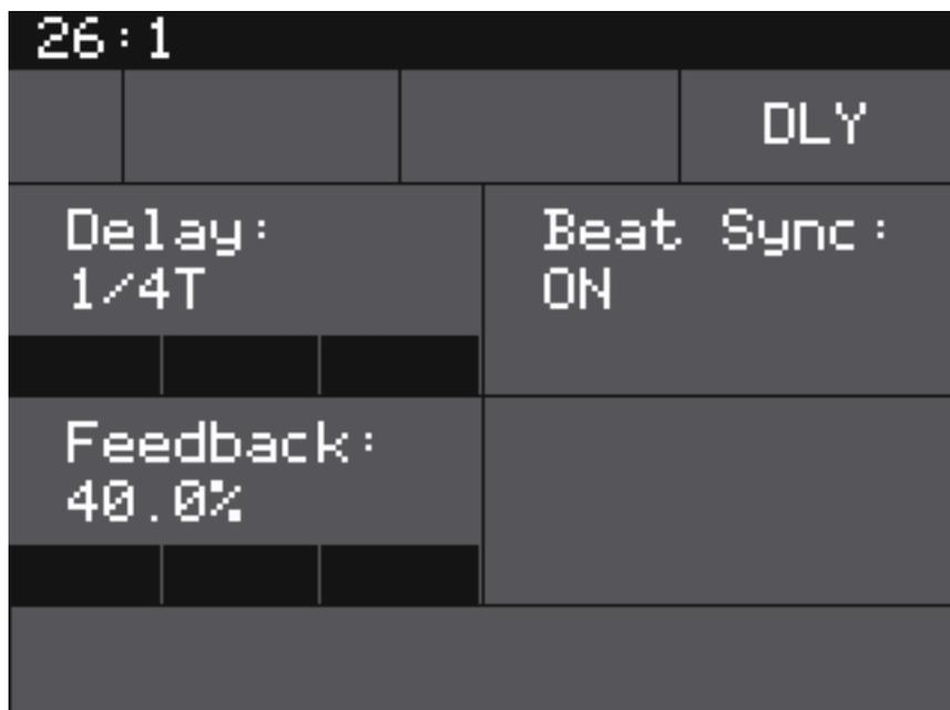
Beim Delay kann man einen Clock-Synchronisation anwählen und die Delay-Zeit (je nach Modus) in Takt-Länge (1/64 bis 1 Takt) oder Prozent, sowie den Feedback-Grad einstellen.
