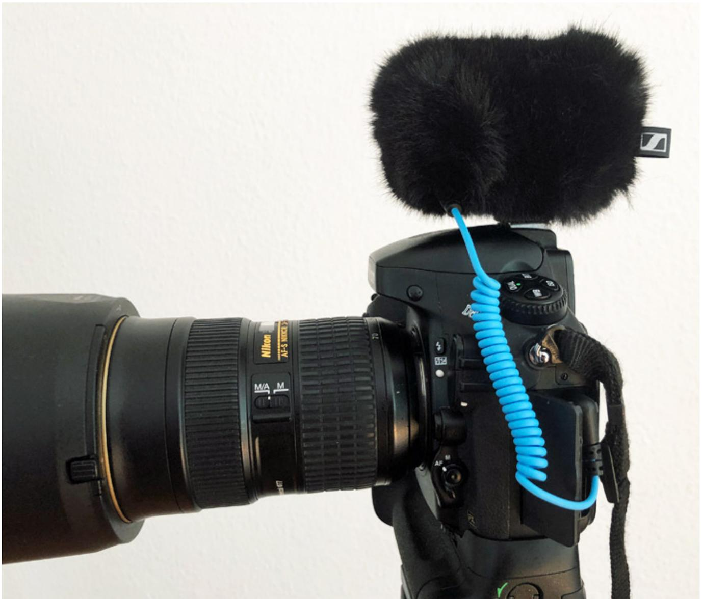
Nun zu dem Wichtigsten: dem Verhalten des Mikrofons in der Praxis. Durch die elastische Aufhängung werden Handhabungs-Geräusche an der Kamera, die ggf. durch Körperschall an das Mikrofon übertragen werden, gut absorbiert. Bei Außenbetrieb hilft der interne Windschutz bei schwachem Wind aus und bei mäßigem und stärkerem Wind unterdrückt der Fell-Windschutz lästige Windgeräusche.
