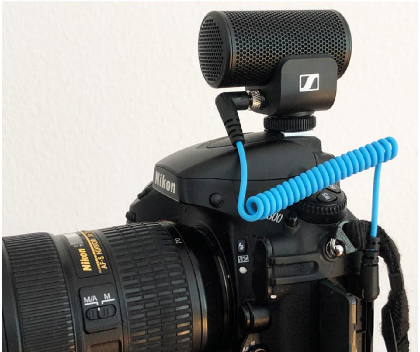
Bei dem Mikrofon handelt es sich um eine Kondensatormikrofonkapsel mit fester Vorspannung und Supernieren-Richtcharakteristik und einer Speisespannung von 2 bis 10 Volt. Die Kapsel ist elastisch gelagert und das Mikrofon verfügt über einen internen Windschutz.
