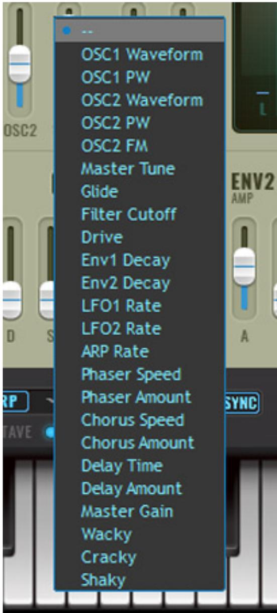
Die LFOs lassen sich jeweils auf ein Modulationsziel umschalten (s. Abb. unten). Anzumerken ist aber noch, dass auch die Ausgänge der Hüllkurven-Generatoren auf diese Modulationsziele geroutet werden können. Die Stärke dieser Modulation lässt sich individuell über einen Regler (AMOUNT) anpassen.
