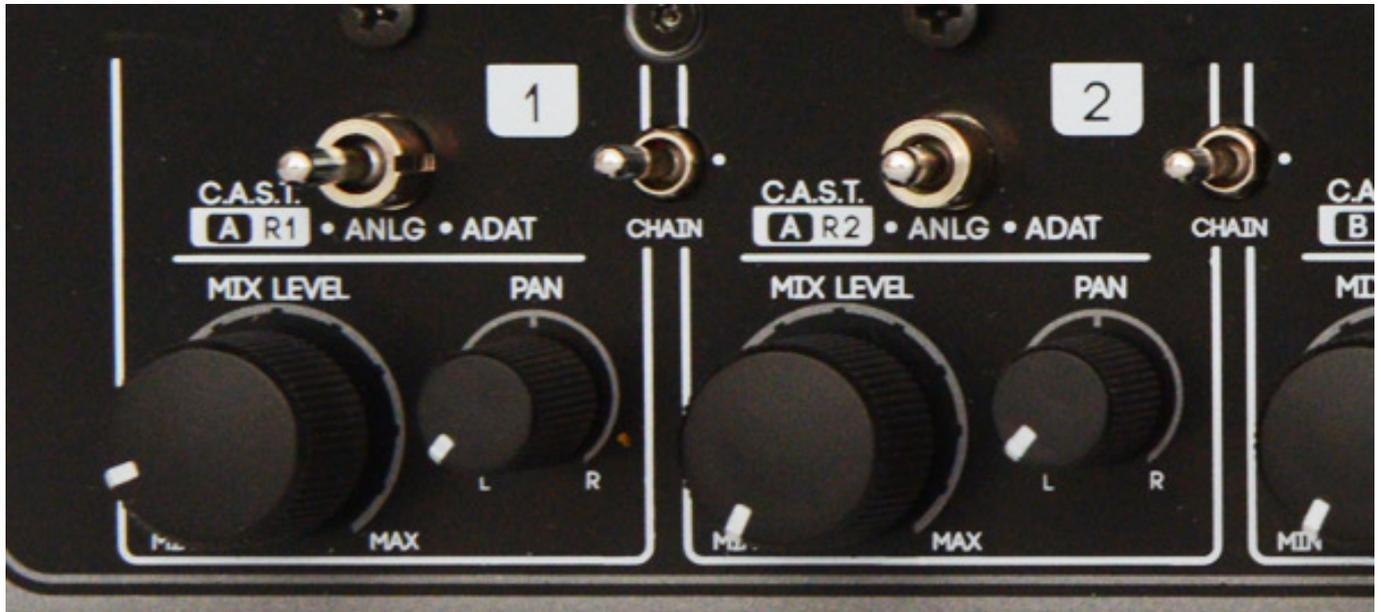
Des Weiteren lässt sich mit einem Dreifachschalter pro Kanal Quellen und Ziel zwischen analoge XLR-In/Out, C.A.S.T. und ADAT umschalten. Über einen weiteren Schalter kann man den Kanalausgang auf den Eingang des folgenden Slots schalten um eine serielle Signalkette von mehreren Modulen zu bilden, ohne dies über ein Kabel-Patching realisieren zu müssen.
