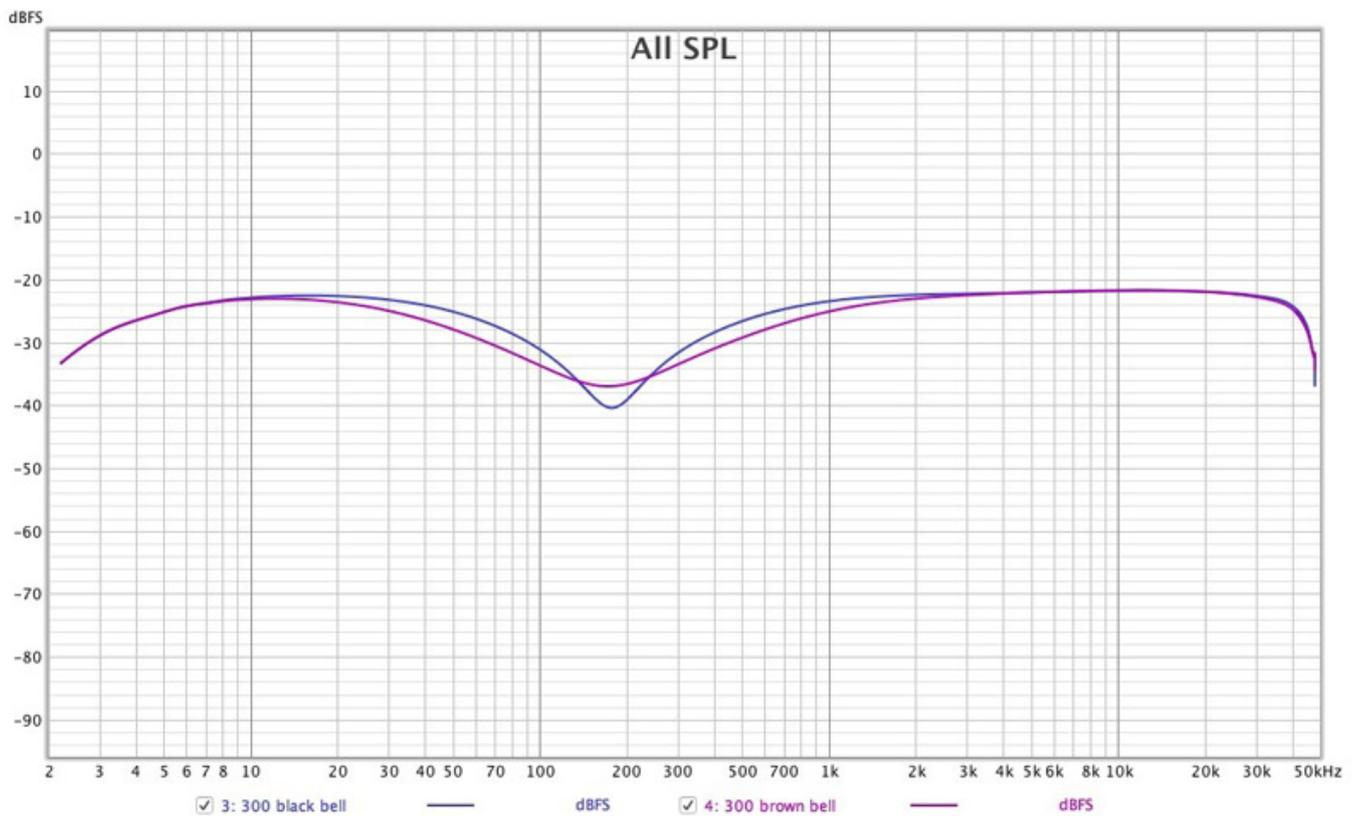
Hier liegt der maximale Absenkungspunkt eher bei 180 Hz, beide Modi bearbeiten aber die annähernd gleiche Frequenz. Man sollte also beim Einsatz doch eher den Ohren vertrauen, die Frequenzangaben auf der Frontplatte sind nur Näherungswerte.
