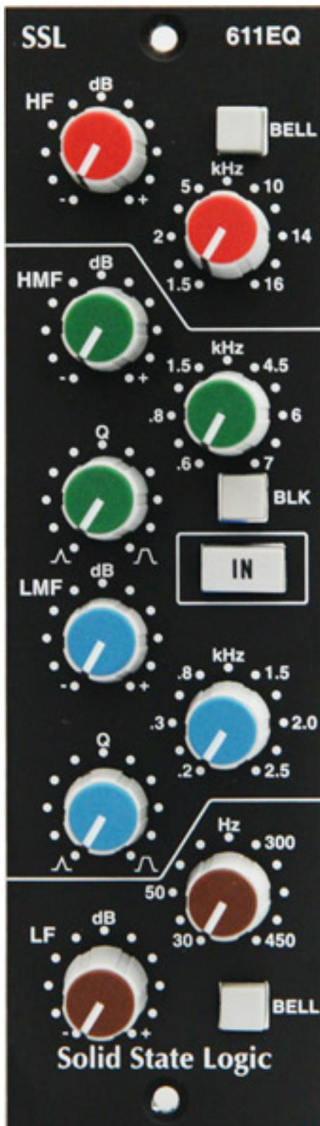
Der Regelbereich beträgt im Brown-Modus +/-15 dB, im Black-Modus +/-18 dB. Die Angaben konnten wir durch Messungen bestätigen. Das obere, semiparametrische Frequenzband, deckt den Bereich zwischen 1,5 und 16 kHz ab. Ein mit „Bell“ beschrifteter Schalter schaltet die Filtercharakteristik von Kuhschwanz auf Glocke
