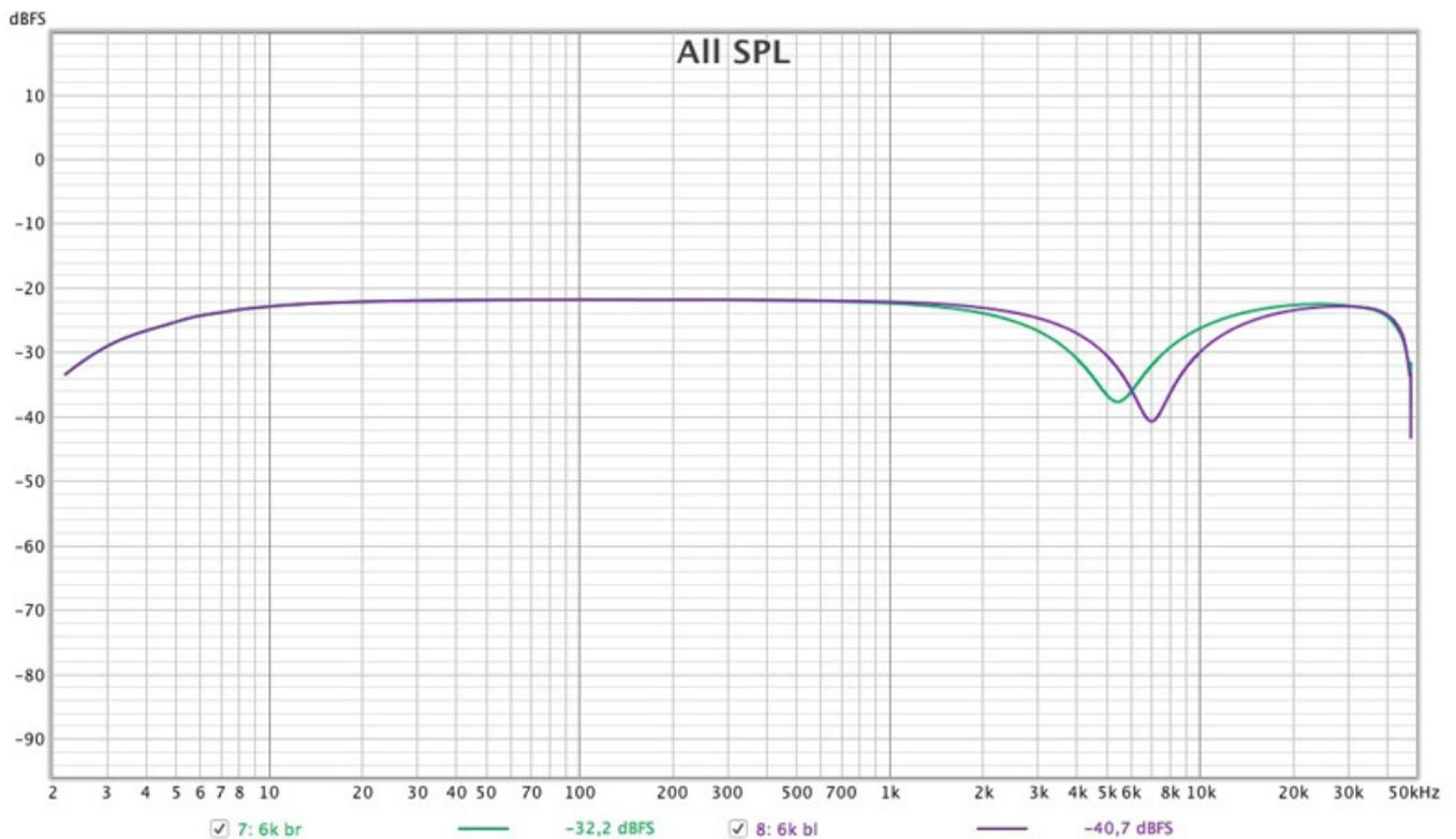
Hier liegt die maximale Absenkung bei der Brown-Schaltung bei ca. 5,5 KHz, die Black-Schaltung senkt bei ca. 7 KHz maximal ab. Der Punkt maximaler Absenkung und auch Anhebung von Black und Brown ist in den beiden Mittenbändern also nicht gleich.
