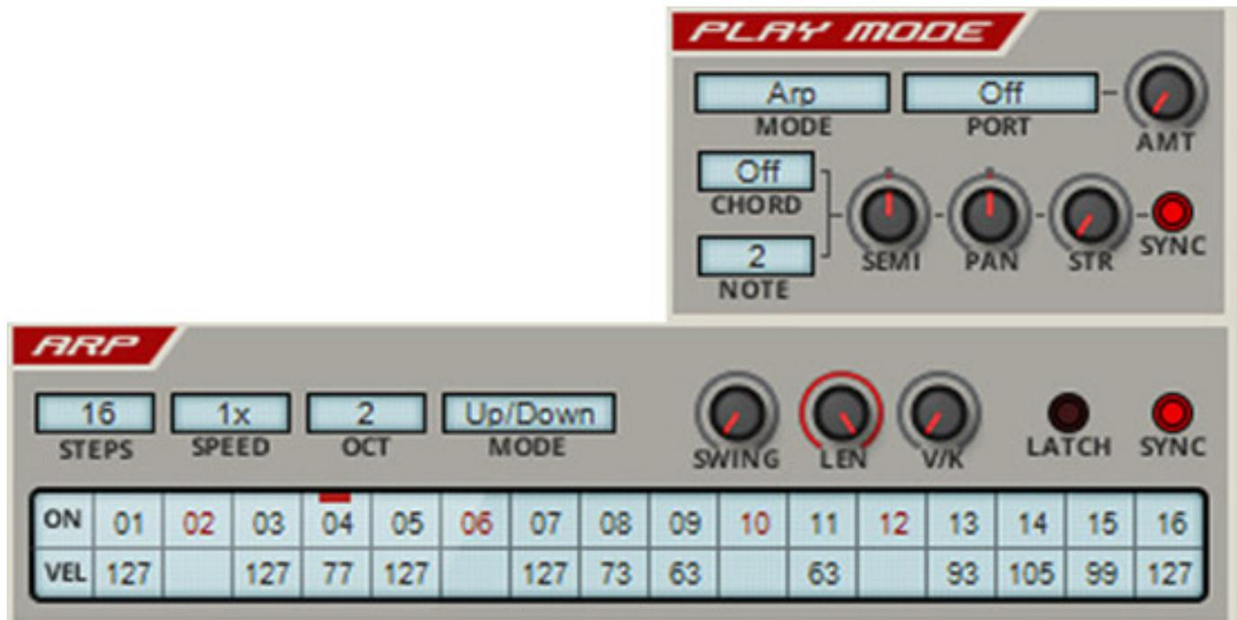
Beim Vecto ist, wie bei den meisten Synthesizer von Ron Papen, auch ein Arpeggiator vorhanden, der über übliche Arpeggiator-Funktion hinausgeht. So lassen sich bis zu 16 Schritte mit Velocity-Werten versehen. Einzelne Schritte lassen sich auch ausschalten. Natürlich sind auch die Standardparameter wie Laufrichtung (12 verschiedene Modi), Tonhöhenumfang (1 bis 4 Oktaven) und Geschwindigkeitsfaktor (1/4 bis x4, auch Triolen) einstellbar.
