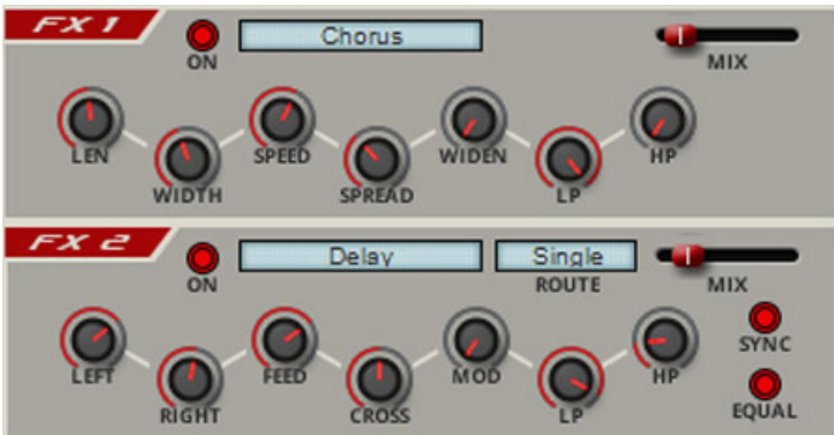
Der Vecto verfügt auch über zwei Effekteinheiten. FX 1 bietet dabei Chorus-, Phaser- und Flanger- und andere ähnliche Effekte und FX 2 sowohl Delays als auch Reverbs. Bei FX 1 muss man sich für einen Effekt entscheiden aber bei FX 2 lassen sich Delay und Reverb auch gleichzeitig betreiben. Die Delay-Time des FX 2 lässt
