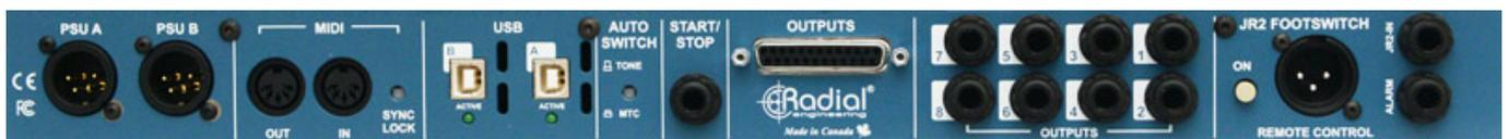
Auf der Rückseite befinden sich linkseitig zwei Stromanschlüsse in Form von Vierpol-Steckern für die beiden im Lieferumfang enthaltenden externen Netzteile. Für ein Backupsystem konsequent umgesetzt: sollte es zu einem Stromausfall eines Netzteils kommen, sichert das zweite Netzteil automatisch den Betrieb des Gerätes.
