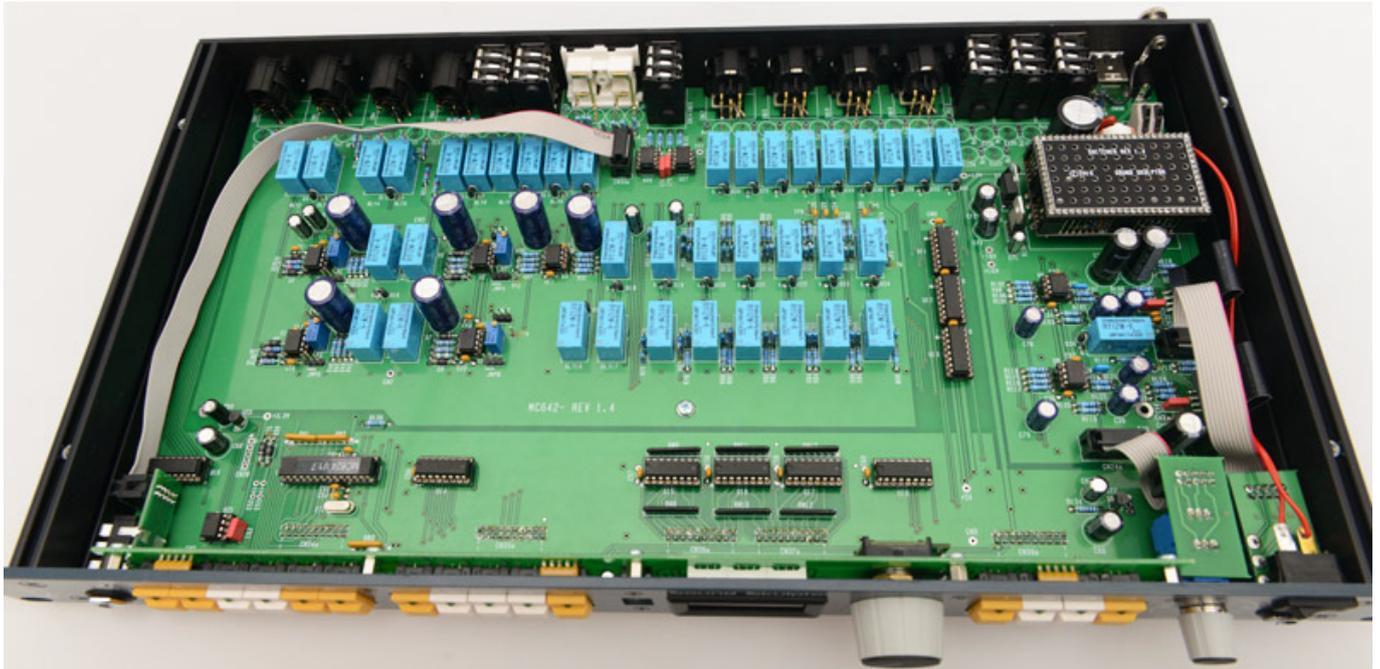
Herzstück des Sound Skulptor MC-642 ist ein PIC (programmable integrated circuit). Dieser ist verantwortlich für die Steuerung der Schaltprozesse, er erlaubt des Weiteren die Anpassung der verschiedenen Pegel für Quellen und Senken. So lässt sich zum Beispiel, jeder Eingang als symmetrisch/unsymmetrisch definieren, eine Umschaltung zwischen Hi- und Low Gain (-10 dBV/+4 dBu) ist ebenso möglich.
