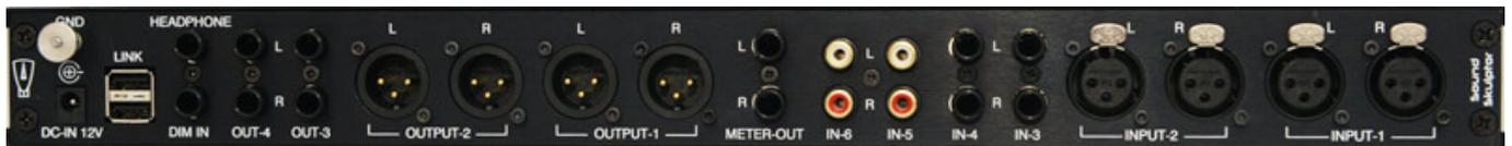
Die Rückseite ist mit folgenden Ein- und Ausgängen versehen: Eingang 1 und 2 als XLR, Eingang 3 und 4 als symmetrische Klinken, Eingang 5 und 6 als Cinch-Buchsen (s. Foto oben). Ein Output für ein externes Meter wird als symmetrisches Klinkenpaar bereitgestellt. Der Meterabgriff befindet sich nach der Quellenwahl, vor der Lautstärkeregelung und vor der Mute/Di-Funktionsgruppe.
