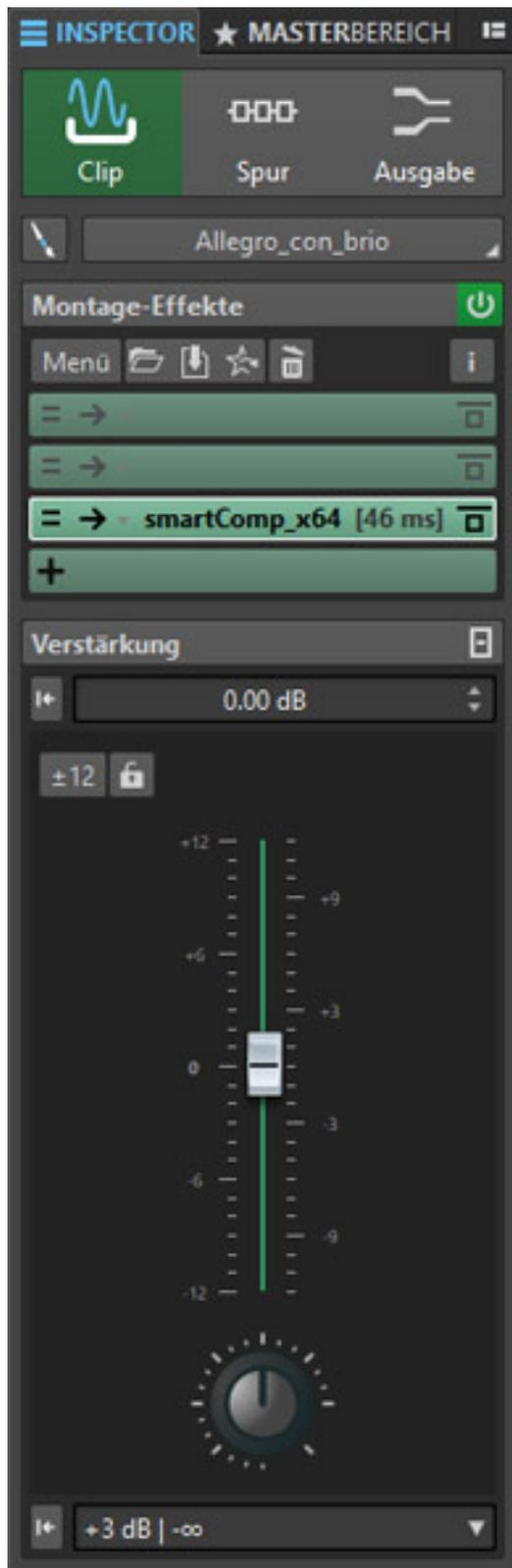
Für Clip, Spur oder der Ausgabe kann man hier Pegel anpassen und Plug-Ins einbinden. Wenn man mehrere Clips selektiert wirken die Einstellungen auf alle angewählten Clips. Auch die Spur/Clip-Farbzuordnung lässt sich hier in diesem Dialog ändern.
