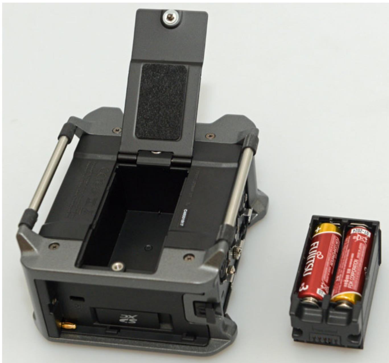
Neben der USB-Spannungsversorgung ist auch der Betrieb über AA-Batterien oder AA-NiMH-Akkus möglich. Vier Zellen werden dazu in ein Akku/Batteriemagazin eingelegt (s. Abb. oben). Interessant ist, dass auch die in der Video-Branche verbreiteten Sony L-Serie-Akkus als dritte Variante der Spannungsversorgung genutzt werden können. Diese lassen sich auf der Rückseite, wo sich auch der Speicherkartenschacht befindet, aufschieben.
