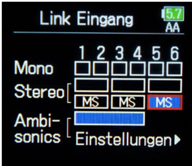
Es ist auch ein Linking der Eingänge in vier Gruppen möglich und zudem (s. Abb. oben) lassen sich auch benachbarte Kanäle als Stereopaar, MS-Stereopaar sowie die Kanäle 1 bis 4 für Ambisonic-Aufnahmen erster Ordnung verbinden. Ist Ambisonics angewählt, so lassen sich hier noch in einem Sub-Menü das Ambisonic-Format (Ambisonics A, FuMA oder AmbiX) sowie die Mikrofonposition (Upright, Upside Down, Endfire) auswählen.
