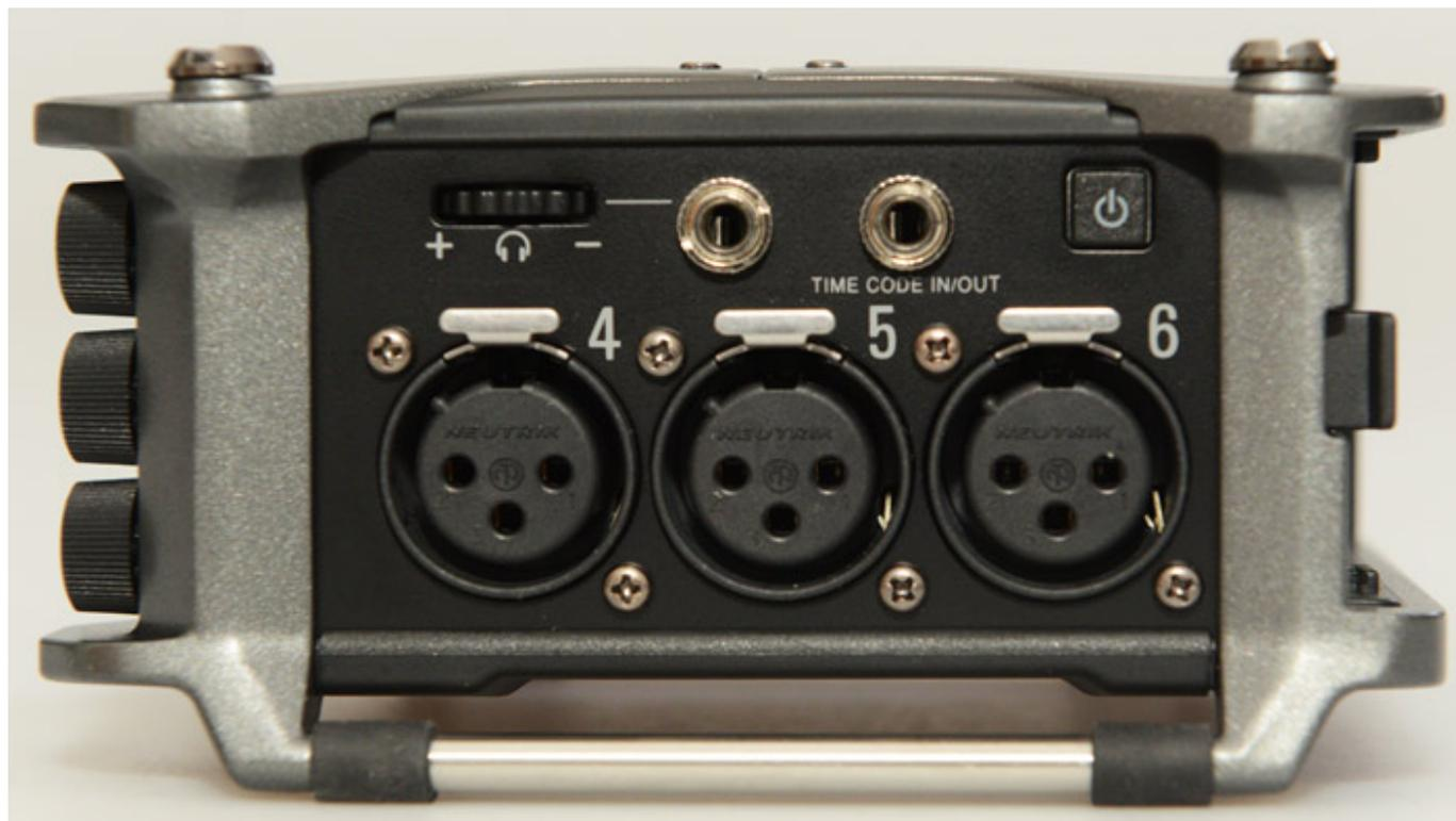
Auf der rechten Geräteseite befindet sich ein Kopfhörerausgang (2 \* 100 mW bei 32 Ohm Anschlussimpedanz) sowie ein Time Code Ein- (0,2 bis 5 V Spitze-Spitze) und Ausgang (3,3 V Spitze-Spitze) ebenfalls beides als 3,5-mm-Stereoklinke ausgeführt und dann auch der Taster für das Ein- und Ausschalten des Recorders.
