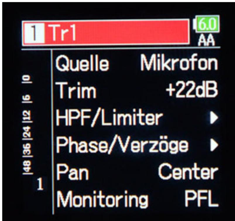
Wenn man den PFL/OK-Taster bei Sichtbarkeit des Hauptbildschirms betätigt, dann geht ein Dialog zur Einstellungen des Kanal 1 auf, in dem man Die Quelle, Trimmung, Limiter und Hochpassfilter, Verzögerung und Phasenlage, Panorama und das Monitoring einstellen kann.
