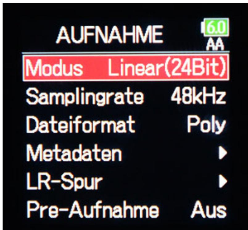
Bei Wahl von Aufnahme kommt man direkt in einen Aufnahme-Dialog (s. Abb. oben), in dem man Aufnahmebitbreite, bzw. MP3 anwählen kann, sowie Abtastrate, Dateiformat etc. Es lässt sich hier auch einstellen ob eine Stereomischspur mit aufgezeichnet werden soll und der Pegel lässt sich angleichen. Auch kann man einen sechs Sekunden Pre-Record-Puffer aktivieren.
