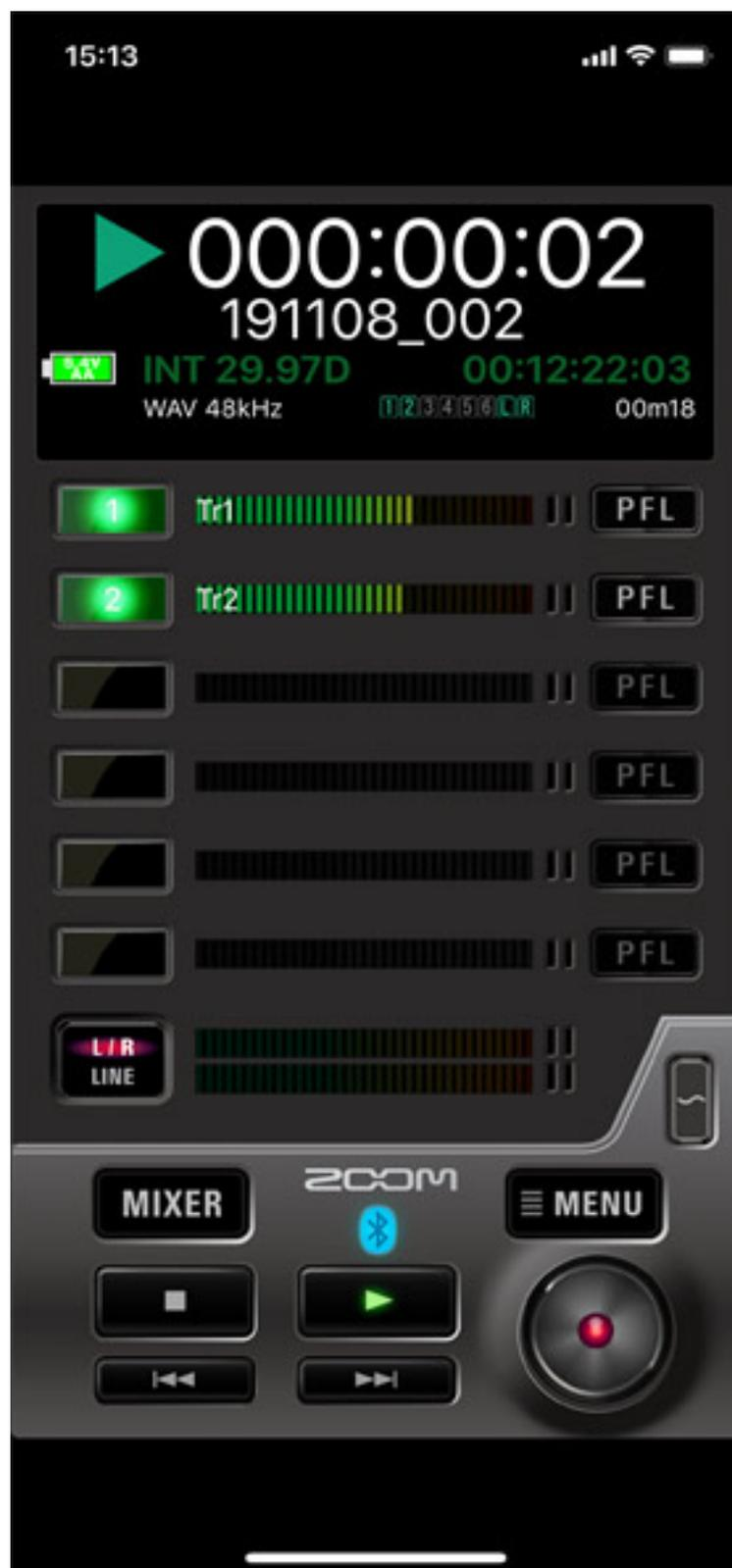
Auf dem iPhone gibt es zwei wählbare Displays und zwar eines mit Aussteuerungsbargrafen im Hochformat (s. Abb. oben) und eines im Querformat bei dem auch die Fader dargestellt werden und bedienbar sind (s. Abb. unten).
