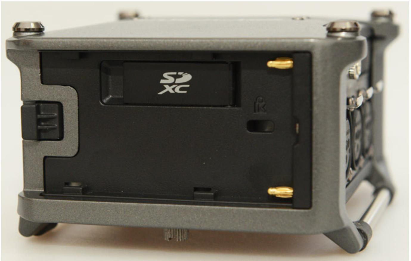
Auf der Geräterückseite befindet sich die Abdeckung für den Speicherkarten-Slot. Es können SD-, SDHC, SDXC-Karten bis maximal 512 GB genutzt werden. Anders als beim F8/F8n und auch beim F4 kann die Aufzeichnung beim F6 also nur auf einer Karte erfolgen.
