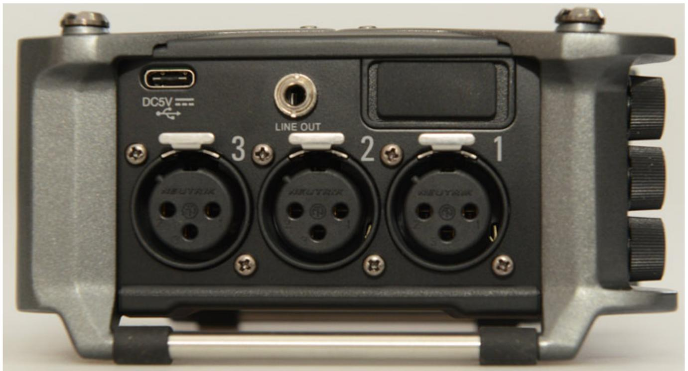
Auf der linken Seite befindet sich ein USB-C-Anschluss für eine Speisung des Recorders zum Beispiel via USB-Steckernetzteil. Weiter befindet sich hier ein analoger Line-Ausgang in Form einer 3,5-mm-Stereobuchse (Ref.-Pegel -10 dBV, max. +10 dBV), um zum Beispiel DSLR-Kameras mit der Stereomischung zu versorgen und daneben unter einer Gummiabdeckung ein Steckplatz für das optionale Bluetooth-Modul BTA-1. Anders als beim F8/F8n benötigt man diese Option wenn man die Remote-App nutzen möchte.
