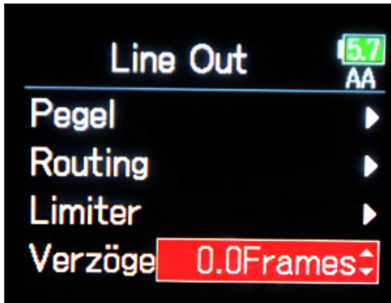
Weiter lässt sich der Ausgangspegel und das Routing (jeweils Pre/Post wählbar) einstellen und es steht auch hier ein Limiter zur Verfügung (S. Abb. oben), der sich auch für Stereobetrieb verlinken lässt.
