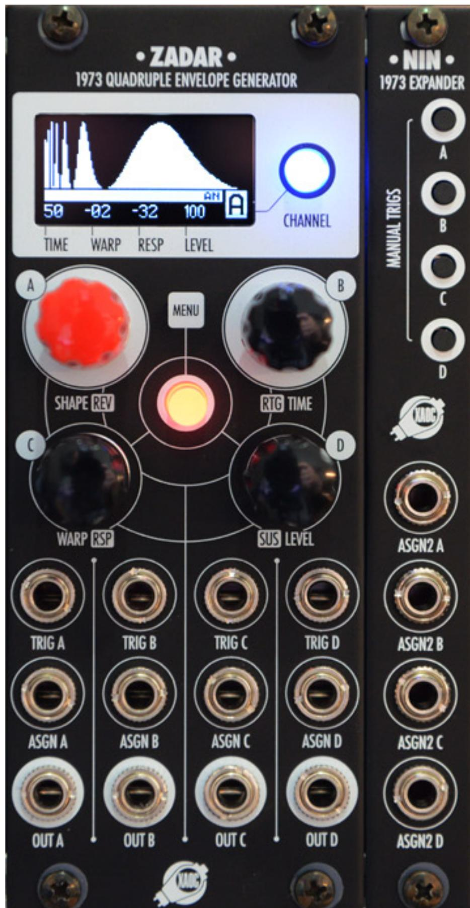
Der polnische Hersteller Xaoc bietet eine ganze Reihe von äußerst interessanten Modulen an. Auf der Superbooth 2018 stellte man den digitalen Vierfach-Hüllkurvengenerator Zadar mit einer Breite von 10 TE vor. Er bietet Möglichkeiten, die weit über die der analogen Hüllkurvengeneratoren hinausgehen und das mit einem interessanten Bedienkonzept.
