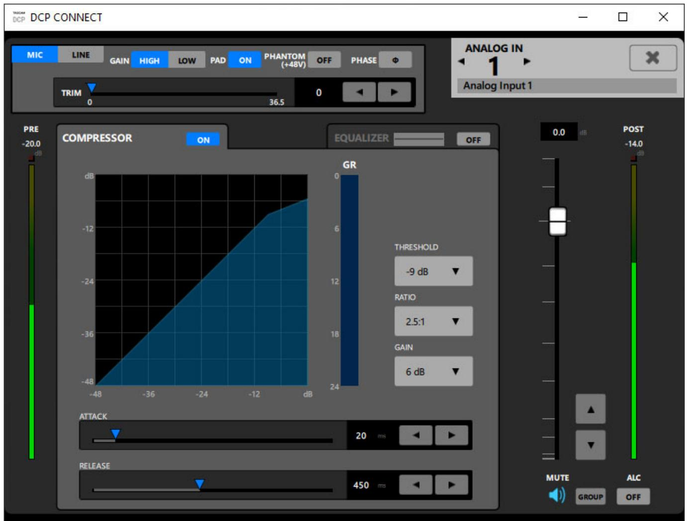
Ganz oben im Dialog kann man den zulässigen Eingangspegel umschalten, die Verstärkung verändern und den Pegel trimmen, eine Dämpfung zuschalten (24 dB), die 48-Volt-Phantomspeisung aktivieren und auch die Phase umkehren.
