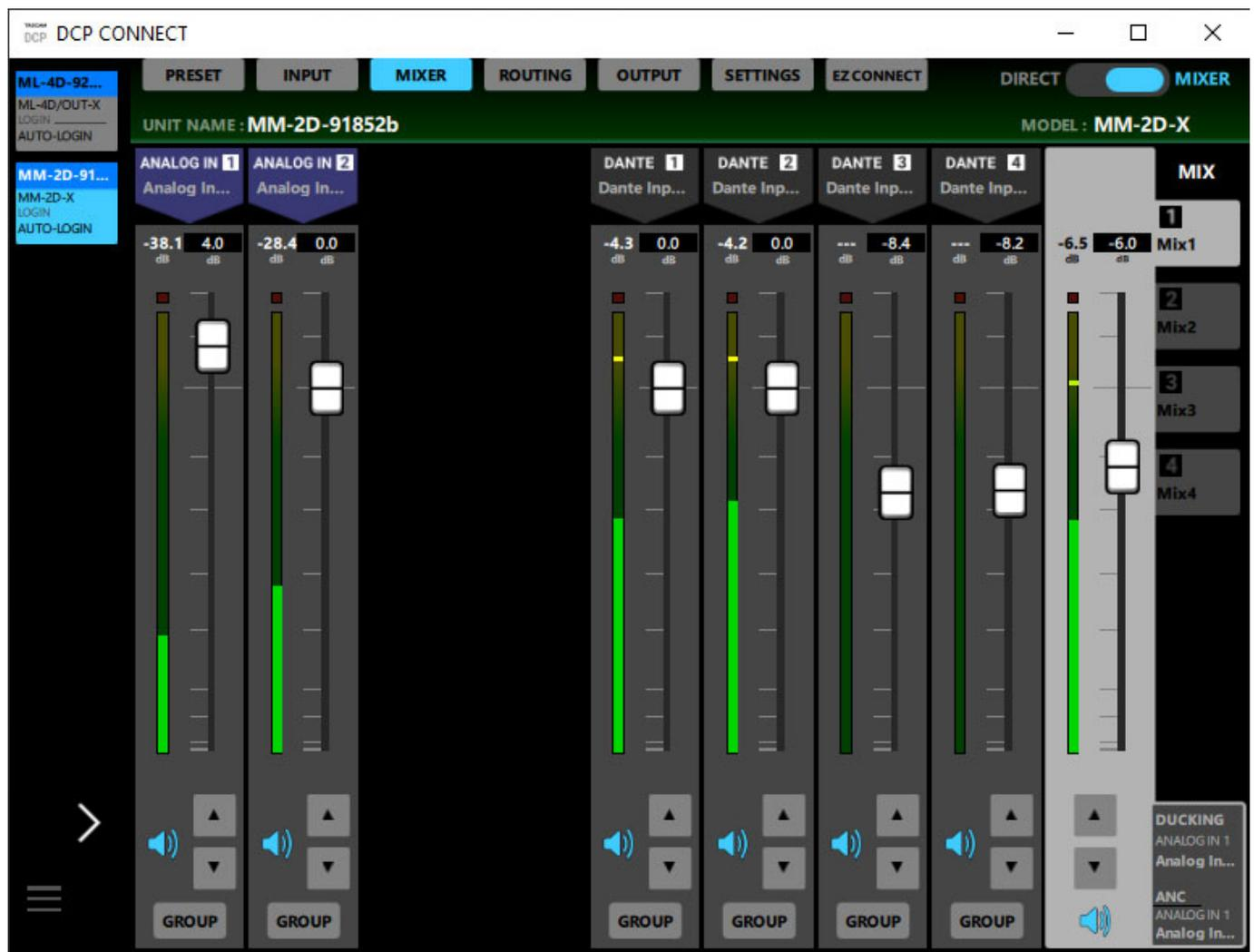
Der Mischer kann über einen Schalter oben rechts auch komplett ausschalten werden, so dass die Eingänge direkt auf die Ausgänge gelegt werden. Der Mischer lässt sich über vier Reiter auf der linken Seite zwischen vier Mixe umschalten und auch ein Mix-Master-Fader pro Mischung wird geboten. Wenn man rechts auf das Feld Ducking/ANC klickt geht ein entsprechender Dialog auf (s. Abb. unten) mit dem sich eben Ducking und sogar Hintergrund-Geräuschunterdrückung realisieren lässt.
