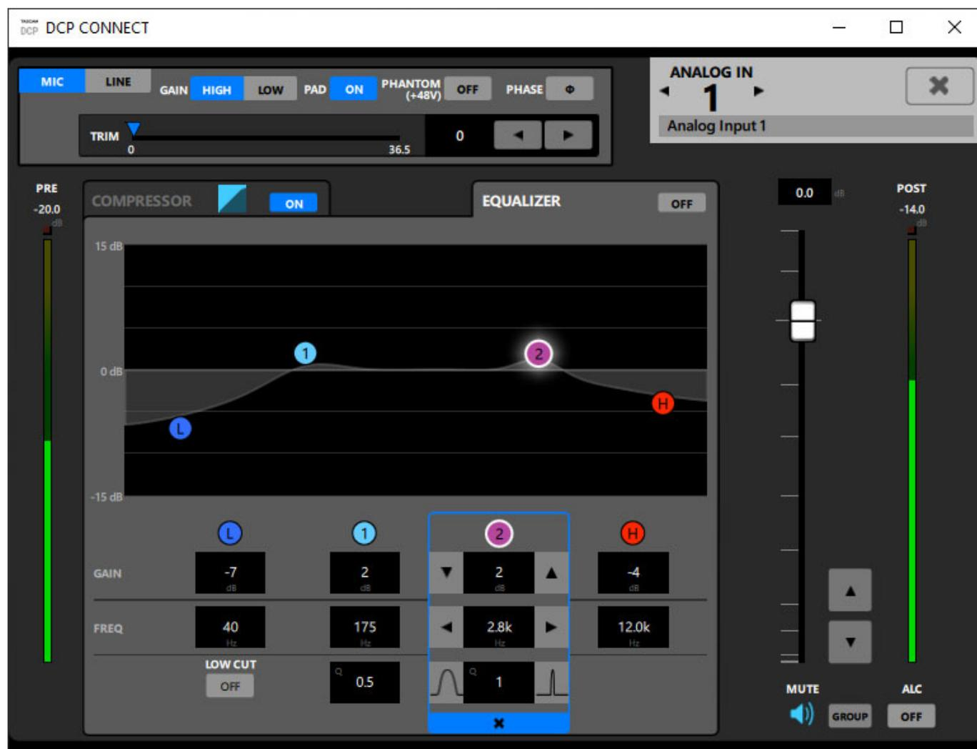
Beim Input-Equalizer handelt es sich um ein zweifach-vollparametrischen EQ sowie Low/High-Shelving. Die Werte lassen sich sowohl unten in den Parameterfeldern ändern als auch oben in der Grafik durch die Computer-Maus.
