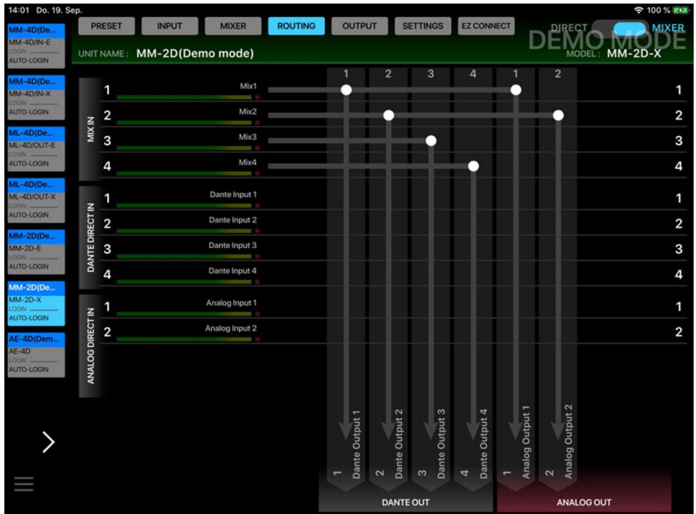
Nun zu der Funktionalität der Software, worüber sich auch die DSP-Funktionalität aufzeigen lässt. Vorab muss man erklären, dass die vier kompakten Dante-Interfaces von Tascam intern über einen DSP verfügen, der sowohl ein Signal-Routing, eine Bearbeitung der Ein- und Ausgangssignale sowie einen Audiomischer bietet. Die Konfigurationen lassen sich über eine Preset-Verwaltung (s. Abb. unten) speichern und wieder laden.
