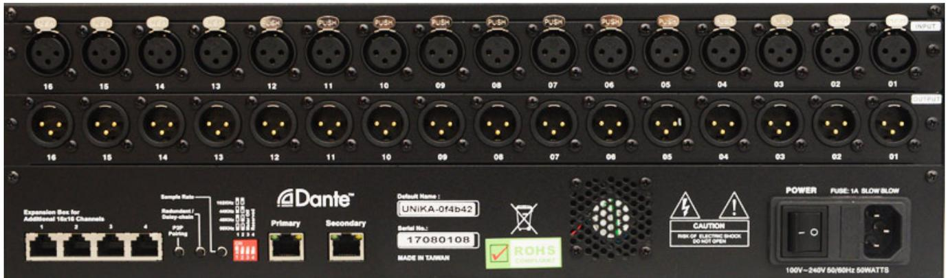
Alle Ein- und Ausgänge sind symmetrisch und als XLR-Buchsen ausgeführt. Der Ausgangspegel beträgt maximal 24 dBu und der Eingangspegel maximal 42 dBu. Der Störabstand gibt der Hersteller auf den Ein- und Ausgängen mit >110 dB an. Der Crosstalk bei 1 kHz liegt bei den Eingängen bei <-95 dB und bei den Ausgängen bei <-120 dB.
