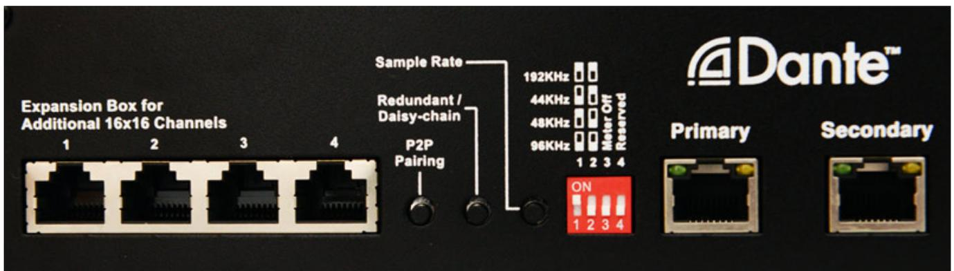
Neben den vier RJ-42 für den Expander gibt es ein Primary und Secondary Dante-Anschluss (s. Abb. oben). Die Abtastrate und ein Deaktivieren des Devices als Master lässt sich über DIP-Schalter einstellen. Die Einstellungen der Abtastrate werden nach dem Drücken des Tasters "Sample Rate" erst aktiv.
