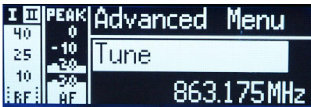
Auch lässt sich hier der Piloton aktivieren. Der Piloton ist ein Ton außerhalb des hörbaren Bereichs, der dazu dient bei ausgeschaltetem oder nicht erreichbar Empfänger das Audio stummzuschalten, also sozusagen eine erweiterte Rauschsperrung.
