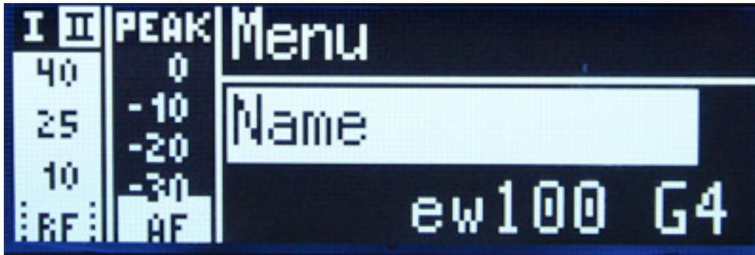
Hier lässt sich der Streckenname (s. oben), ein Kanal aus den vorgefertigten Kanallisten, den Empfangs-Schwellwert ab wann Audio stummgeschaltet werden soll (Squelch in drei Schritten Low/Mid/High, siehe unten) sowie der Ausgangspegel (-24 bis +18 dB) einstellen. Über den Menüpunkt Easy-Setup kann man einen automatischen Frequenz-Scan aktivieren. Über den Menüpunkt "Auto Lock" lässt sich die automatische Tastensperre aktivieren.
