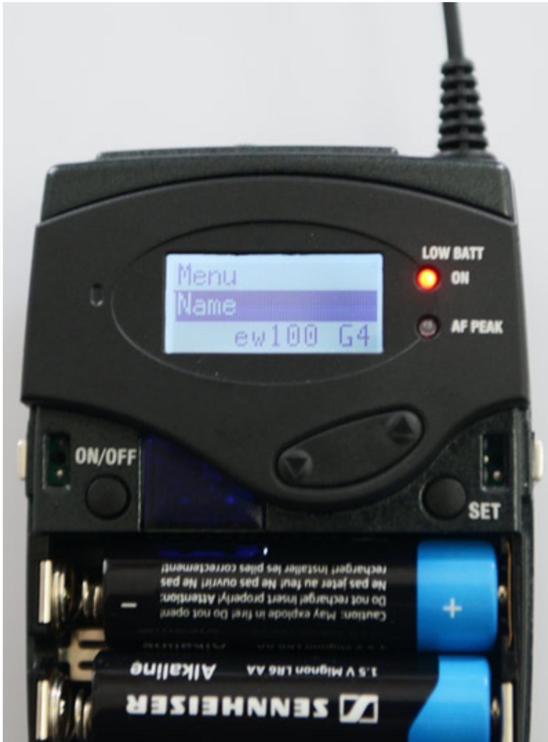
Nach Öffnen des Batteriefachs hat man Zugriff auf den Ein/Ausschalter, der so vor versehentliches Betätigen geschützt ist, sowie der Set-Taste, mit der man Menüs auswählt und Parameter setzt. Das Durchschreiten der Menüstruktur erfolgt mit den von außen zugänglichen Up/Down-Taster.
