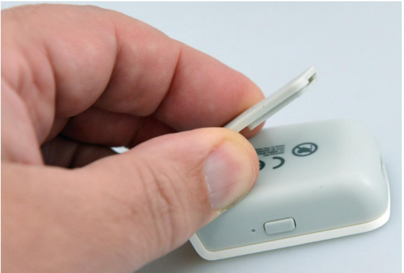
Auf der Seite befindet sich der Ein-/Ausschalter und eine kleine mehrfarbige Status-LED. Der Clip ist aus Gummi und mit einem Magneten ausgestattet.
