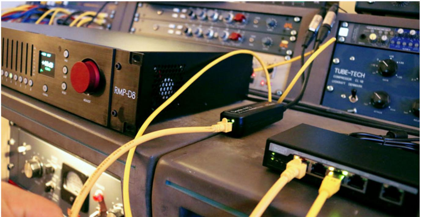
Der Anschluss des RMP-D8 an ein Dante-Netzwerk erfolgt mittels obligatorischer Dante-Controller-Software unkompliziert und schnell, ohne dass tiefgreifendes Fachwissen über Netzwerktechnologien notwendig ist. Im Test verwendeten wir neben dem Gerät einige Dante Avio-Adapter in einem kleinen Dante-Netzwerk, an denen Lautsprecher und analoge Kompressoren wie dem Fearn VT-7 oder der Kemper Profiler angeschlossen waren.
