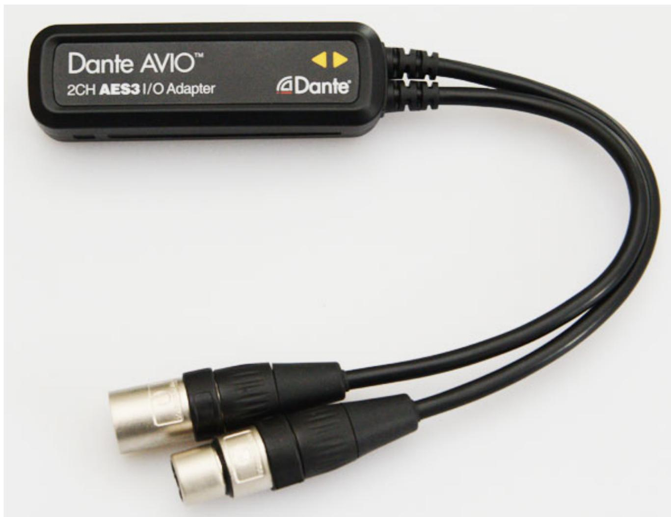
Der AES3 IO Adapter bietet AES/EBU-Ein und Ausgang. Er ist wie alle anderen Adapter mit einem soliden RJ45-Metallanschluss für Ethernet-Kabel ausgestattet, an der zwei LEDs über den Signalfluss informieren.
