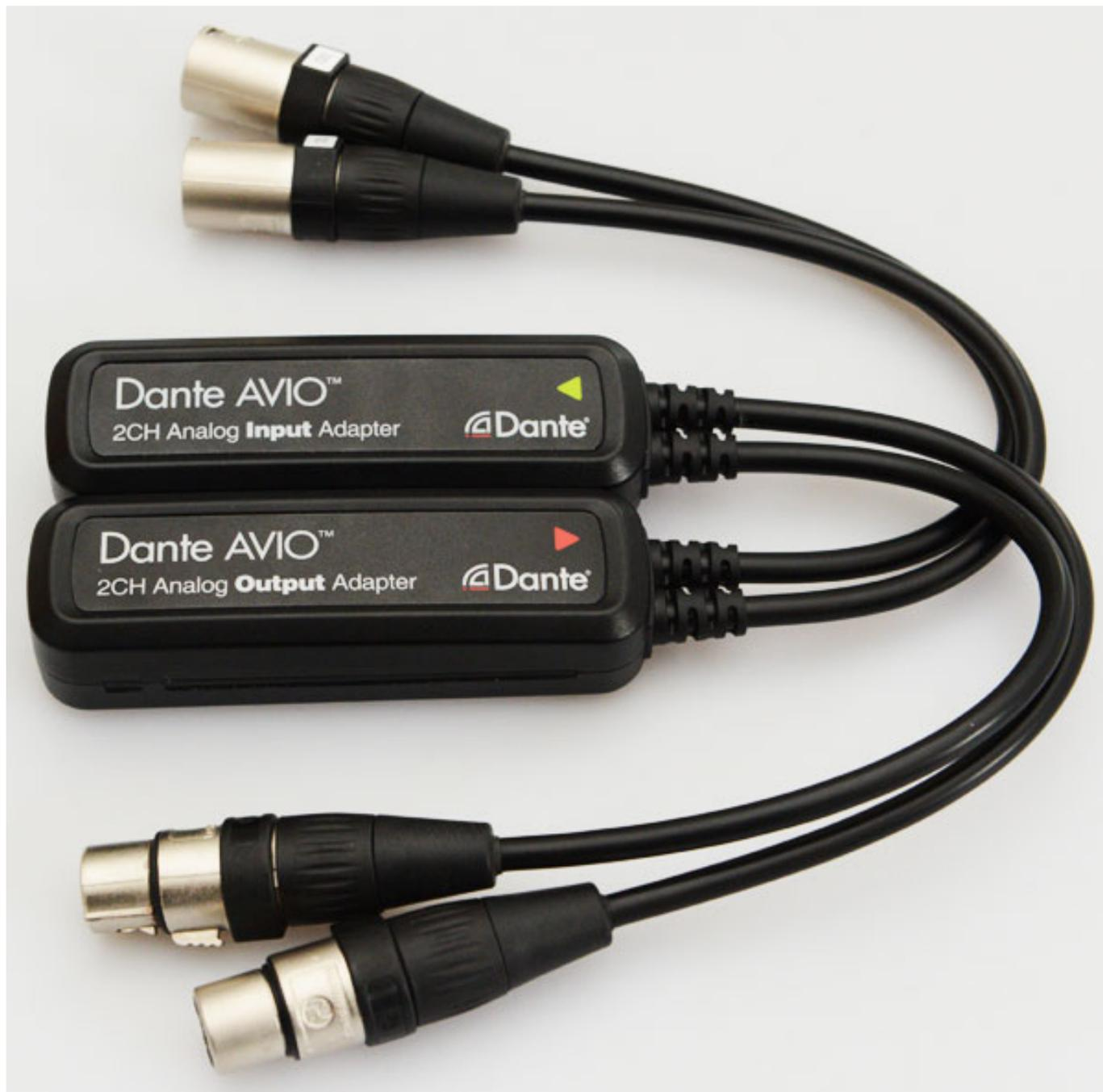
Für den Einsatz von Mono-Signalen sind die Adapter Analog Input und Analog Output mit XLR-Anschluss gedacht. Wie die Stereo-Varianten wandeln diese Audiosignale mit 96 kHz Abtastrate und 24 Bit Wortbreite bei einem Dynamikumfang von etwas mehr als 100 dB.
