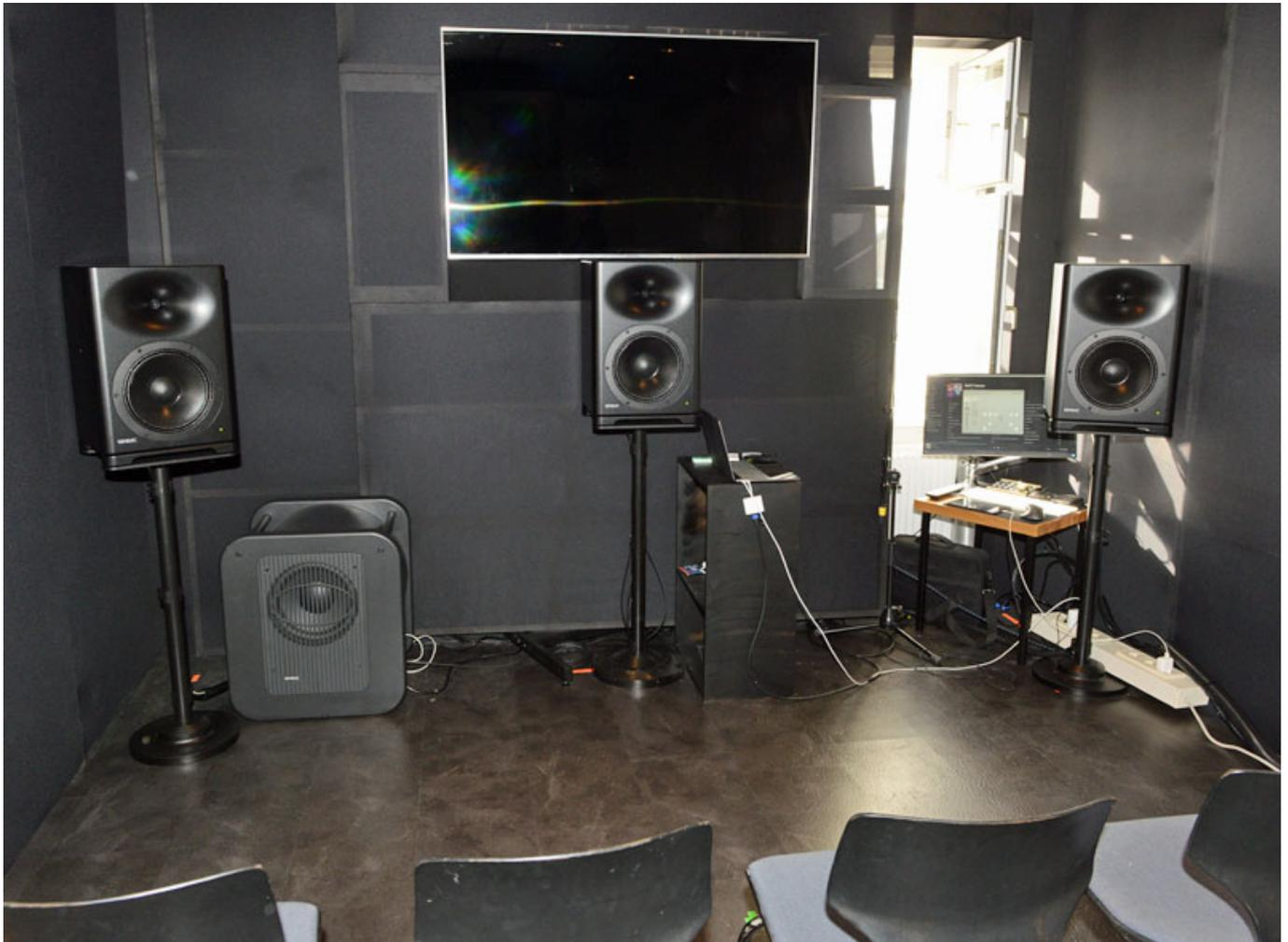
Das Setup im Marvin Keil Sounddesign Studio ist ein 7.1.4. In der Front befinden sich drei Genelec S360 sowie ein Genelec 7370A Subwoofer (siehe Foto). Für die oberen vier Speaker setzt man Genelec 8331 ein und die Seiten- und Rear-Speaker sind Genelec 8341. Natürlich kommt hier die GLM-Software zum Einsatz und das Setup war entsprechend eingemessen.
