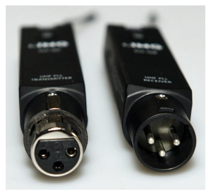
Die Komponenten sind gleich groß (Breite 22 mm, Höhe 23 mm, Länge Sender 116 mm, Länge Empfänger 102 mm). Der einzige optische Unterschied ist die XLR-Buchse beim Sender und der integrierte XLR-Stecker beim Empfänger. Der maximal zulässige Eingangspegel am Sender beträgt 0,775 V. Ein- und Ausgänge sind elektronisch symmetriert.
