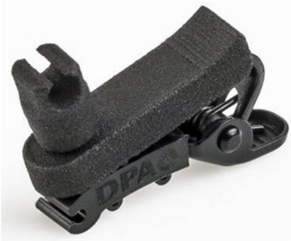
Das 6060/6061 ist von der Baugröße so klein, dass man es durchaus auch unauffällig am Körper oder an der Kleidung (Knopfloch, Kragen oder am Ohr etc.) befestigen kann. Es gibt aber auch von DPA die optionale Klemme SCM0030-B (s. Foto oben, Quelle DPA) für den Einsatz des 6060/6061 als klassisches Lavalier-Mikrofon. Die Position des Mikrofones lässt sich dabei in Acht Stellungen (45-Grad-Schritten) einstellen. Die Mikrofone 6060 und 6061 werden in Beige (Hautfarbe) oder in Schwarz angeboten.
