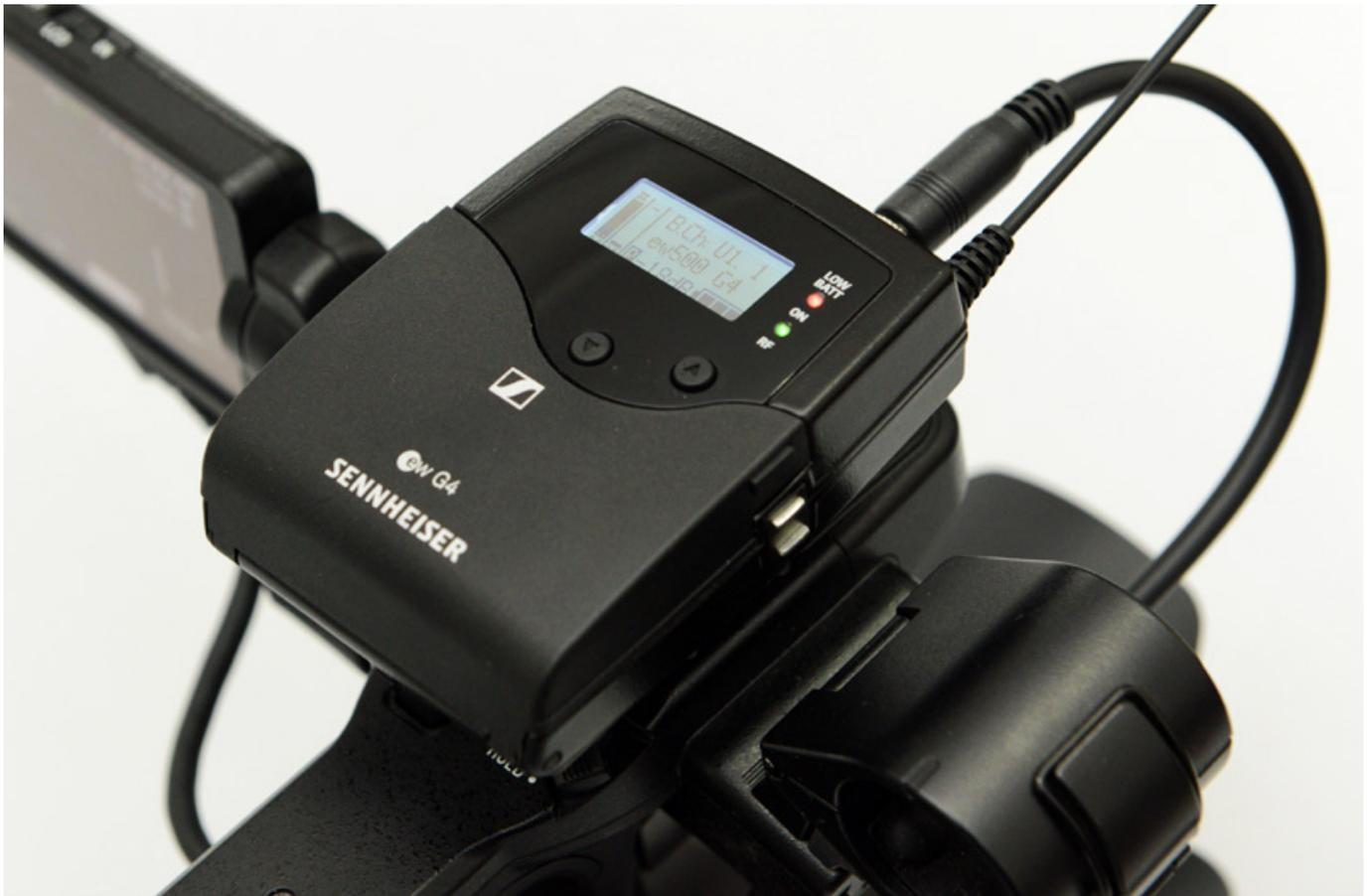
Es handelt sich bei beiden Empfänger um Diversity-Empfänger. Im Display (s. Abb. unten EK 500 G4) wird der Audiopegel als auch die Empfangsfeldstärke und der Empfangskanal angezeigt, wie auch Frequenz, Empfänger-/Kanalname, Batteriestatus sowie Aktivität des Pilottons (P). Der Empfang wird mit einer grünen LED nochmal zusätzlich signalisiert.
