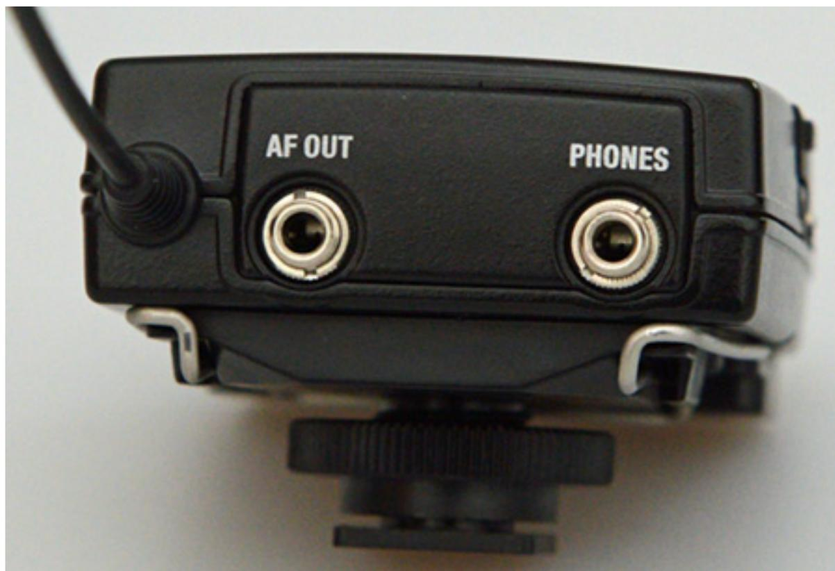
Die Befestigung auf der Kamera erfolgt über eine Montageplatte mit Blitzschuh-Adapter, die über den Metallbügel fixiert wird.
