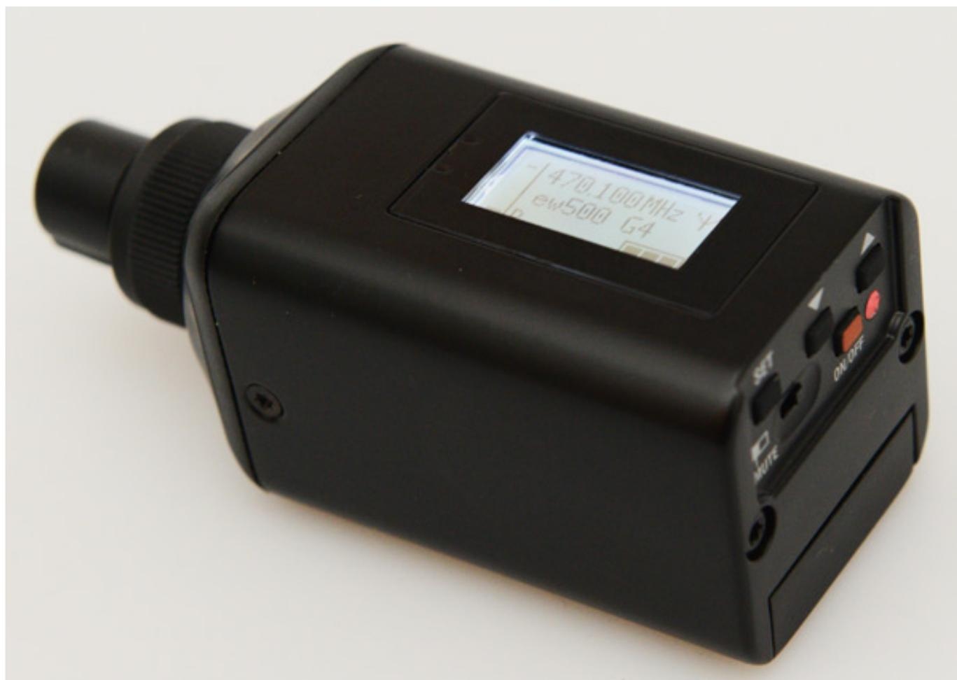
Für den Film- und Broadcast-Bereich sind natürlich auch Aufstecksender für den Betrieb von Drahtgebundenen Mikrofonen, zum Beispiel am Mikrofongalgen, interessant. Sennheiser bietet hier nun die Aufstecksender SKP 100 G4 und SKP 500 G4 (hier in den Abbildungen zu sehen) an.
