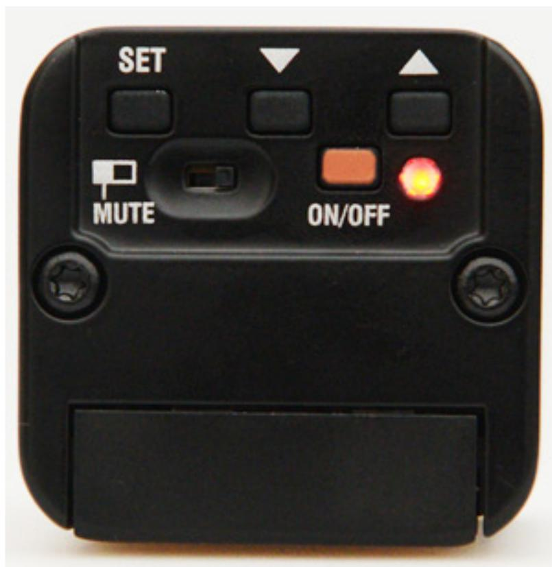
Auch hier ist die Bedienung ähnlich den Taschensendern. Neben den schon zuvor beschriebenen Merkmalen wie Schaltbandbreite und Ausgangsleistung gibt es noch einen weiteren Unterschied zwischen den Aufstecksendern und das ist die Phantomspeisung über die nur der SKP 500 G4 verfügt. Der SKP 100 G4 ist also primär für den Einsatz mit Mikrofonen mit dynamischer Kapsel gedacht.
