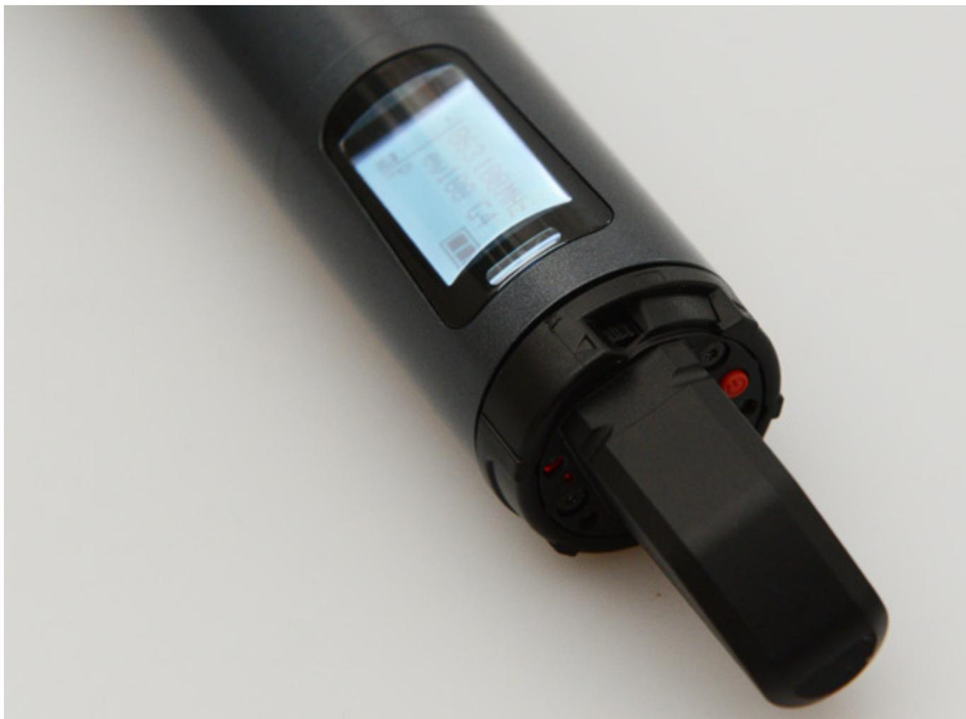
Unten am Handgriff gibt es die entsprechenden Bedienelemente, die von der Funktionalität den der Handsender entsprechen. Auch das Display und die Bedienung sind mit dem Handsender identisch.
