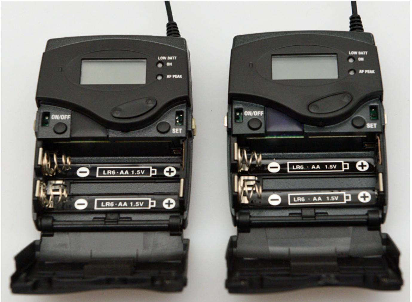
Bei den 100er-Serien kann man zwischen der ew G3 und ew G4 kaum unterschieden. Der einzige Design-Unterschied ist der Schriftzug auf der Gerätefront. Alles andere ist im ersten Eindruck identisch. Nach dem Einschalten sieht man aber sofort, dass ein anderes Display verbaut wurde. Die Hintergrundbeleuchtung ist nun nicht mehr gelb sondern weiß.
