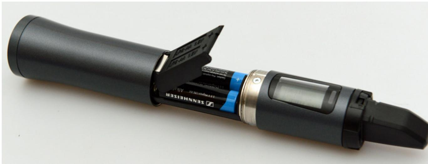
Auch hier kommen zwei AA-Batterien oder der Akku BA 2015 zum Einsatz. Nach Aufschrauben des hinteren Teils lässt sich dieser nach hinten ziehen und man gelangt an das Batteriefach (s. Abb. oben).
