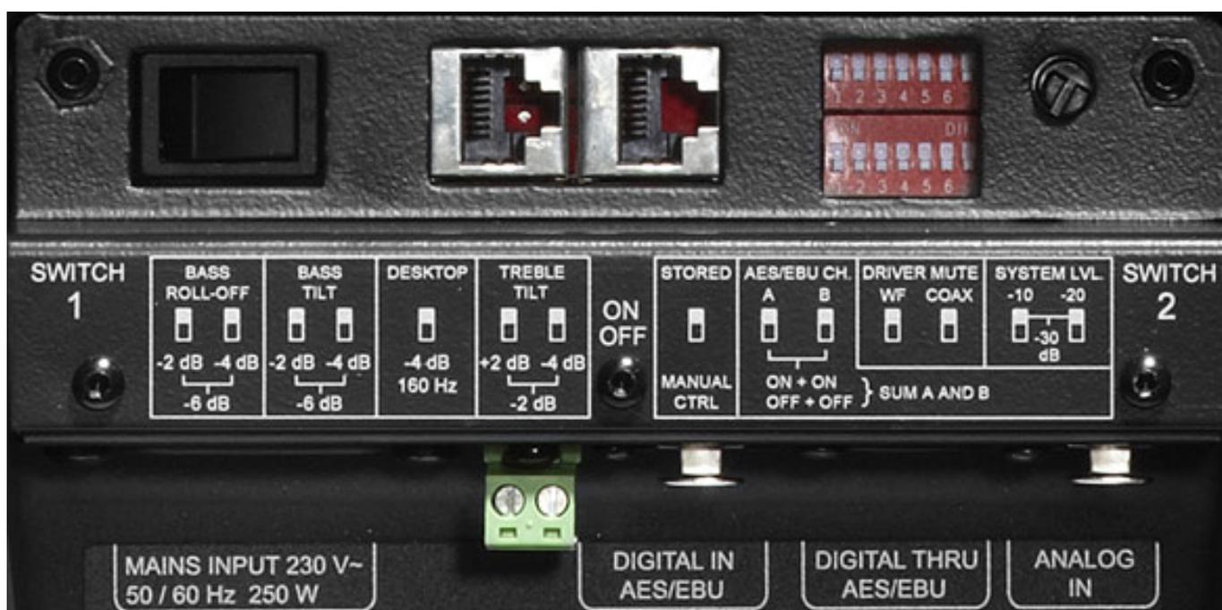
Über zwei Buchsen lassen sich die Lautsprecher in das GLM-Netzwerk (Genelec Loudspeaker Management) einbinden. Der Anschluss an den Rechner erfolgt über ein optionales USB-Interface. Wir werden die Software als auch die Einmessprozedur einmal näher in einem weiteren Beitrag vorstellen.
