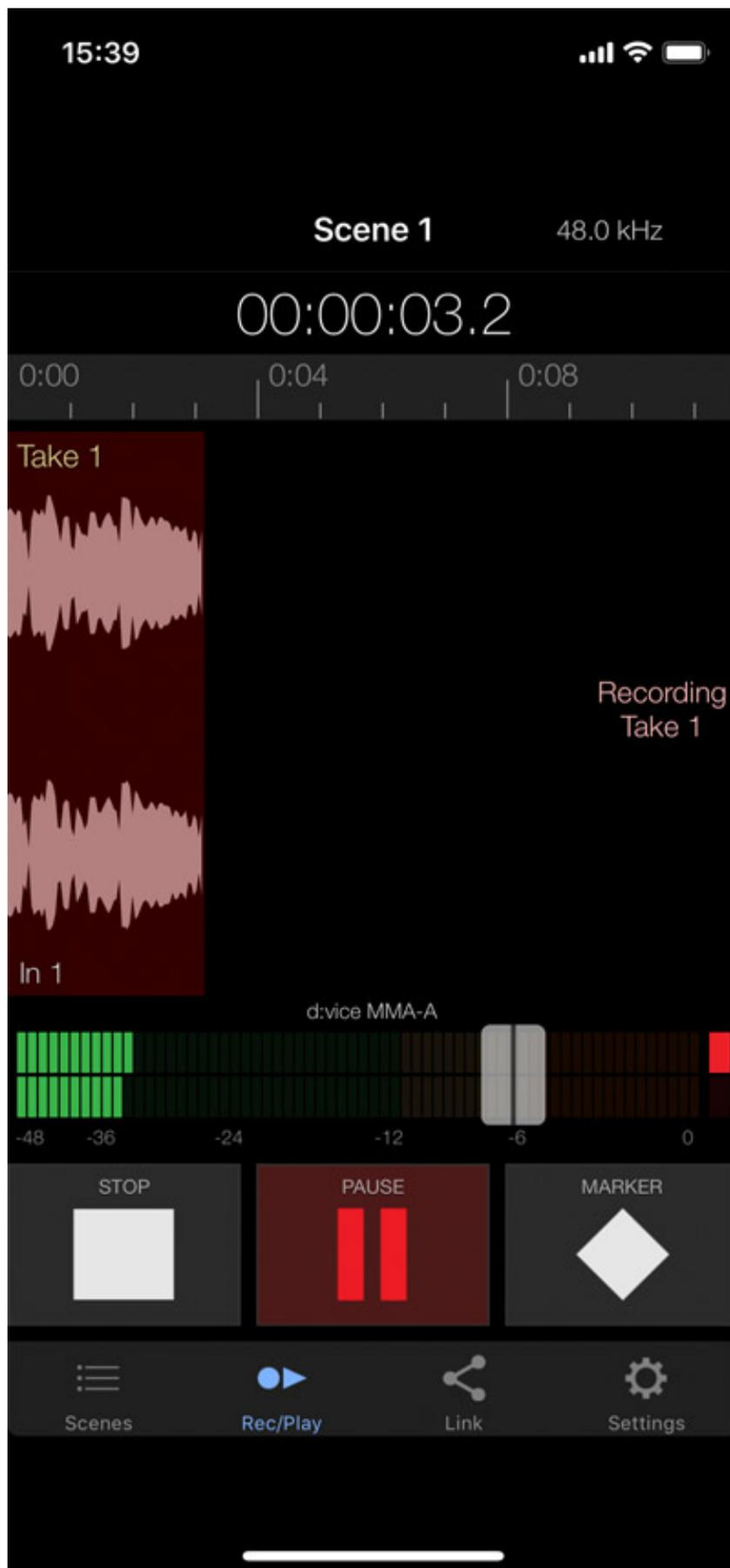
Wir haben unter anderem auch den MetaRecorder von Apogee mit dem d:vice auf einem iPhone X unter iOS 11.2.6 getestet. Wie man auf dem Foto sieht wird das Device d:vice MMA-A erkannt und eine Aufnahme ist problemlos möglich. Erwähnenswert ist auch, dass die Abtastrate in der Recording-App ausgewählt wird.
