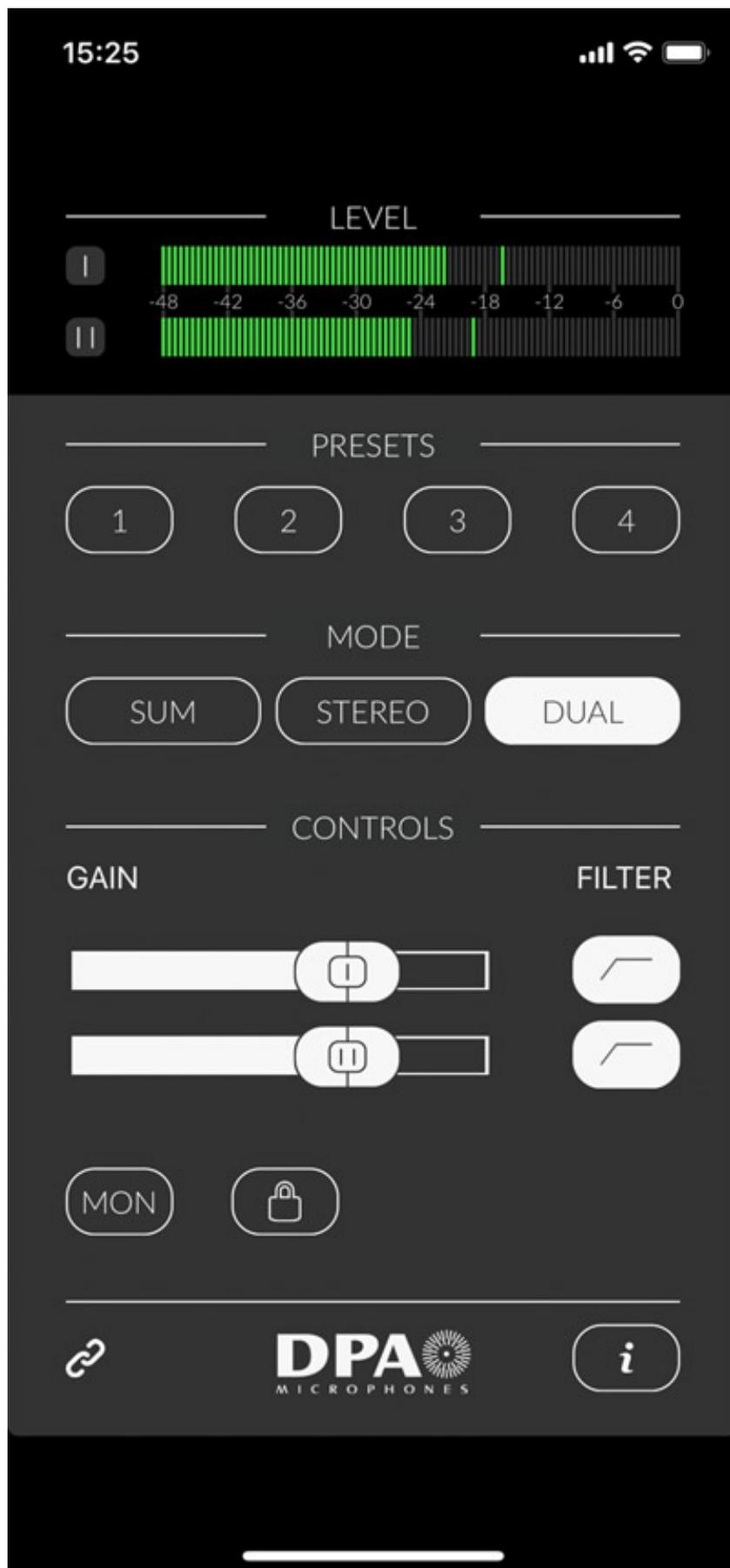
Die beiden Interface-Eingangskanäle können auf den internen iOS-Stereo-Mikrofoneingang als Summe, bzw. bei einem angeschlossenen Mikrofon monophon, als Stereo oder als Dual - also zweikanalig mit unabhängig individuelle Kanaleinstellung, aufgeschaltet werden. Das Interface erkennt auch ob ein oder zwei Mikrofone angeschlossen sind.
