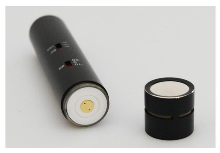
Bei dem hier vorgestellten sE 8 Pärchen handelt es sich um "echtes" Kondensatormikrofone, also kein Electret-Mikrofone mit fester Vorspannung. Die Kapseln mit einer 3 µm starke, goldbedampfte Membrane werden in Handarbeit gefertigt. Laut dem von sE verfügt das sE8 über einen Übertragungsbereich von 20 Hz bis 20 kHz, mit einer leichten Anhebung bei etwa 7 kHz. Der Grenzschalldruck von 139 dB ist schon ziemlich ambitioniert und deutet auf eine gute Dynamik hin.
