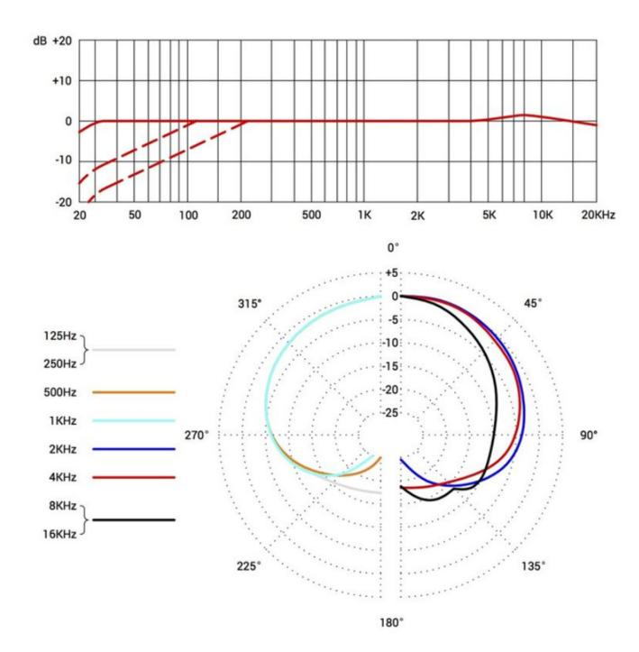
Es gibt einen zweistufigen Pegelabschwächer, mit 10 dB und 20 dB. Des Weiteren gibt es einen schaltbaren Hochpassfilter der bei 80 bzw. 160 Hertz die tiefen Frequenzen beschneidet. Diese Funktionen werden mit kleinen, im Mikrofonkorpus versenkten Schiebereglern vorgenommen, so dass sie sich nicht so leicht versehentlich verstellen lassen.
