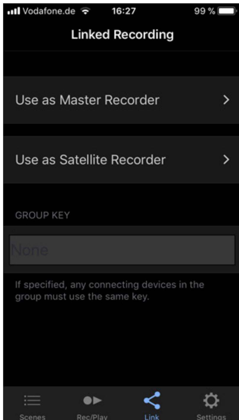
Interessant ist auch, dass man mehrere Recorder/Devices - synchronisieren kann. In der App lässt sich einstellen ob das Device als Master- oder Slave-Recorder arbeiten soll.
