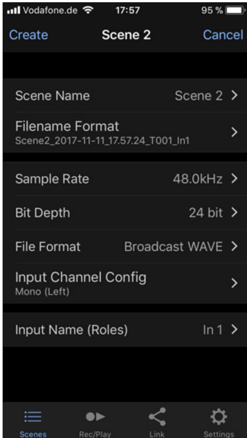
Als erstes muss man eine Szene anlegen (s. Abb. oben). Hier kann man die entsprechenden Werte für Auflösung und Abtastrate angeben sowie das Aufzeichnungsformat (Core Audio File oder Broadcast-WAV).
