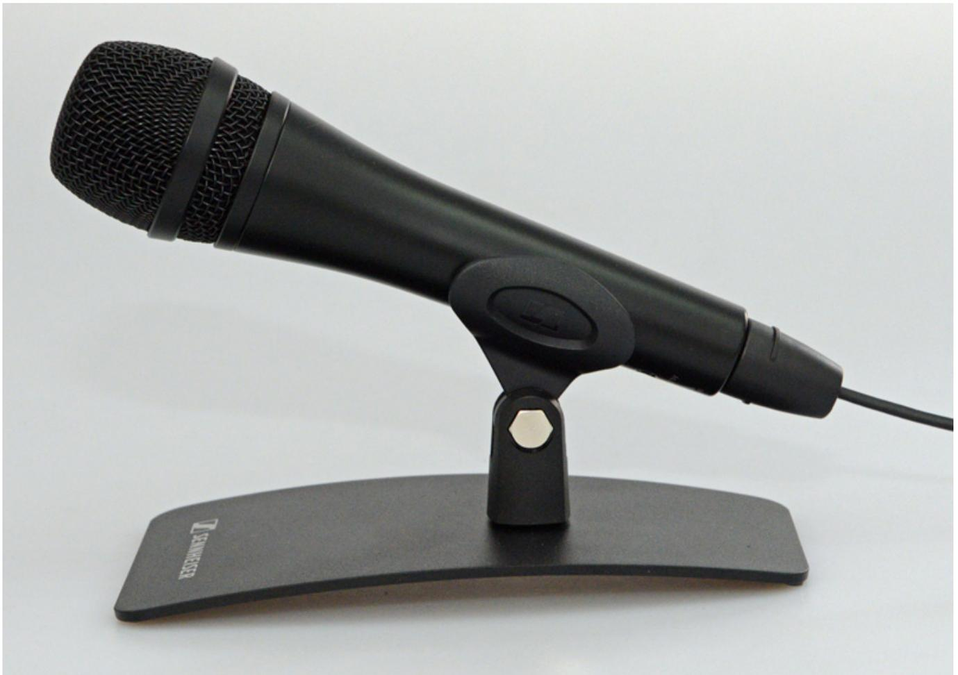
Der vom Hersteller Sennheiser angegebene Übertragungsbereich beträgt 40 Hz bis 16 kHz. Bei minimaler Verstärkung beträgt der maximale Schalldruck 134 dB SPL und bei maximaler Verstärkung 99 dB SPL. Die regelbare Verstärkung liegt wie bei den zuvor vorgestellten Produkten bei 35 dB. Der A-bewertete Ersatzgeräuschpegel liegt beim Sennheiser HandMic digital bei minimaler Verstärkung bei -96 dBFS (A) und bei maximaler Verstärkung bei -74 dBFS (A).
