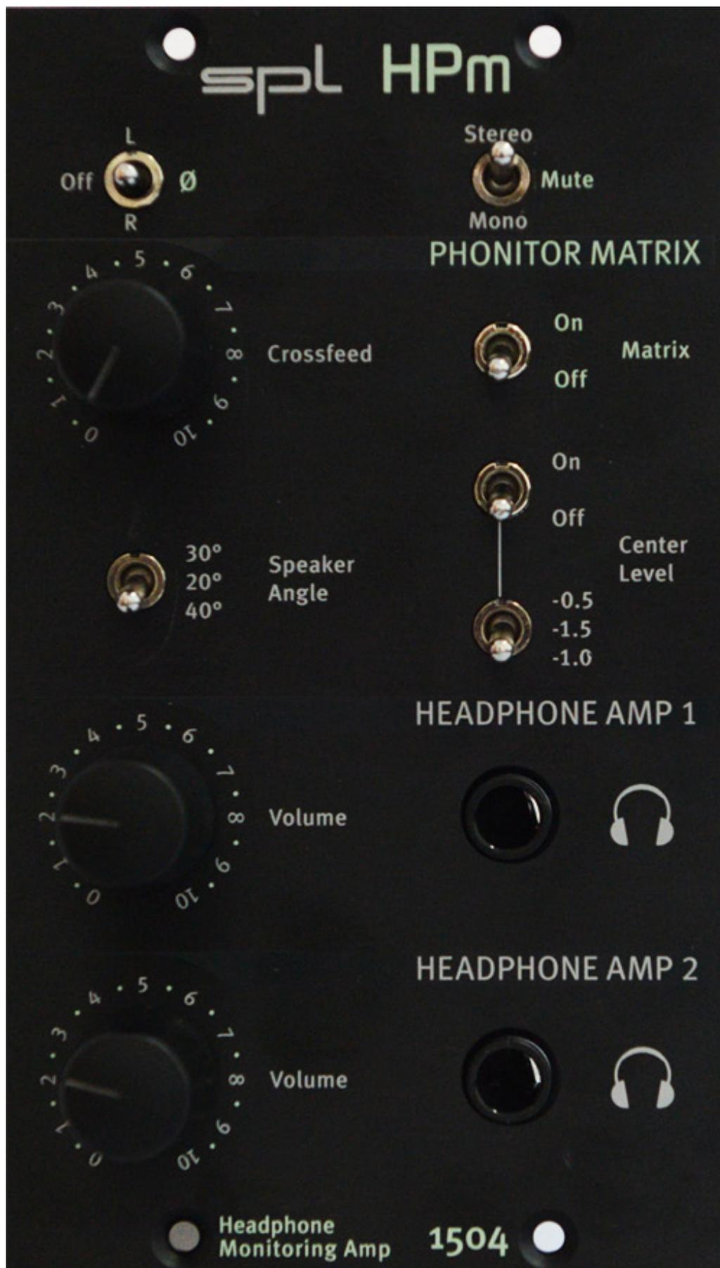
Mit zwei Schaltern kann man einmal die Phase tauschen sowie auf Mono schalten, bzw. stummschalten. Besonders interessant sind die weiteren Bedienelemente im oberen Teil der HPm Frontplatte. Viele werden dort Regelmöglichkeiten wiedererkennen, die sie vielleicht vom [SPL Kopfhörerverstärker Phonitor 2](#) her kennen, den wir hier bei uns auch schon getestet haben. Die Einstellungen die dort vorgenommen werden, wirken auf beide Kopfhörerausgänge identisch.
